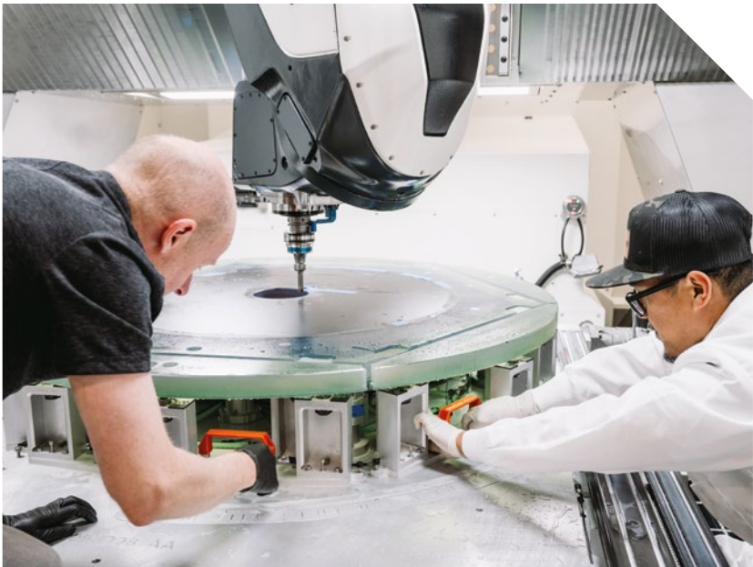
Coherent工程师开发了自己专有的夹紧方法，其中结合了支撑和夹紧系统，用其固定工件。
