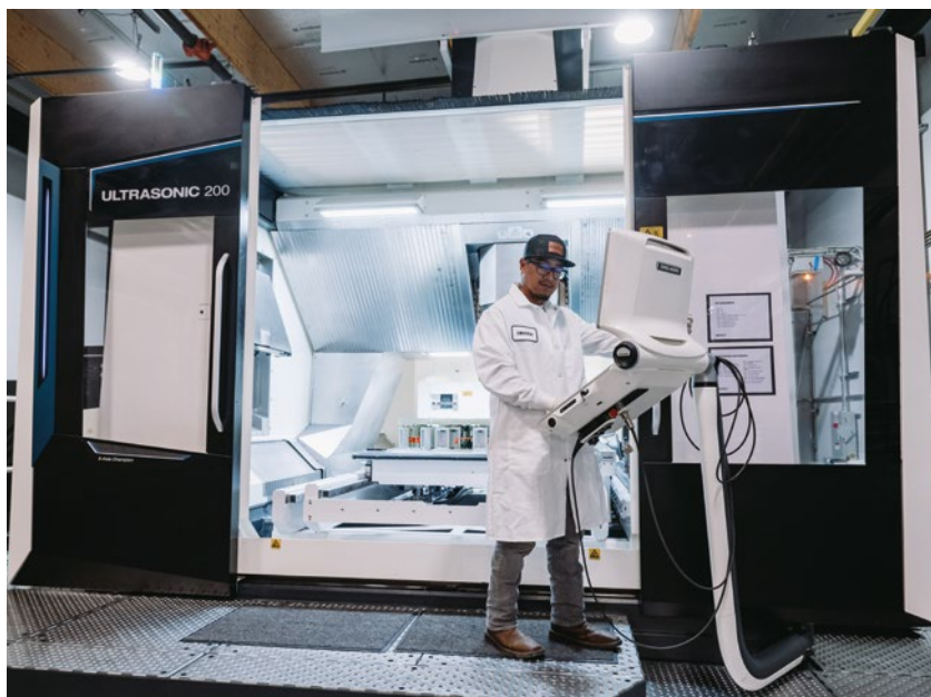
ULTRASONIC 200 Gantry的行程达 4,000 \times 2,000 \times 1,200 mm。龙门结构性能稳定,为高精度加工反光镜组件提供理想的基础
