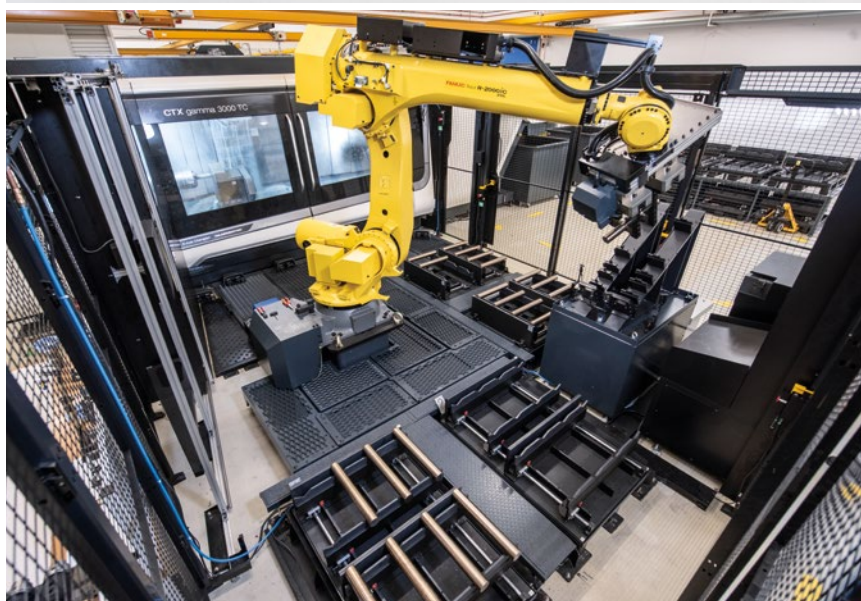
CTX gamma 3000 TC配MATRIS自动化系统, 生产精密主轴。
