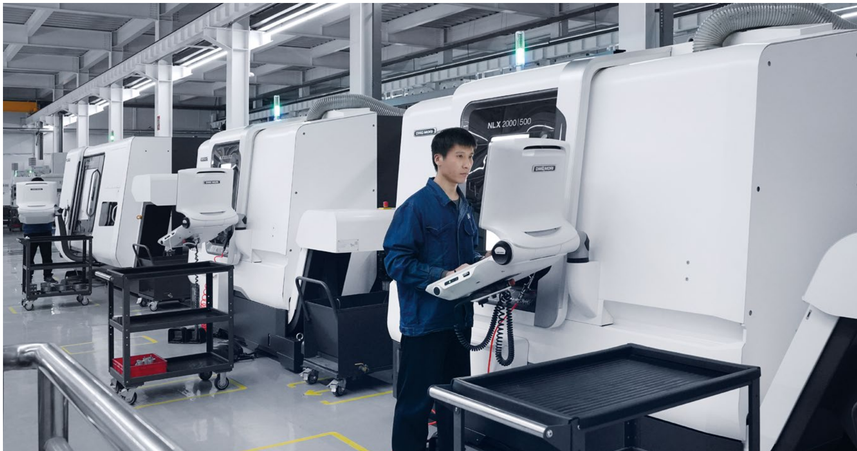
光德流控专注于研发和生产流体控制系统和阀门。 两台NLX 2000|500加工中心和一台CTX beta 1250 TC车 / 铣复合中心是其中的部分车削和车 / 铣复合加工机床。
