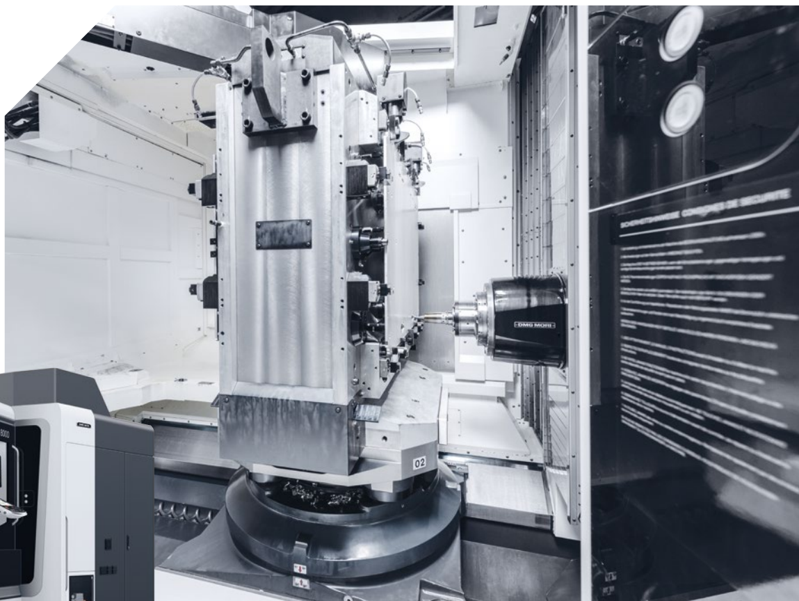
每台NHX 8000都配一套托盘交换系统，一个托盘配一个夹具，夹具的两侧安装底板。一次装夹加工两个底板。
