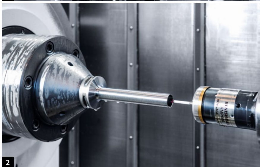
1. Sandvik Coromant Trondheim在宽大的NTX 3000车削中心加工区中可轻松加工刀体，直径可从 \phi 16 mm至 \phi 80 mm。 2. Sandvik在机测量各个工件。因此，仅临时抽检时才需要在机床外和加工后测量。
