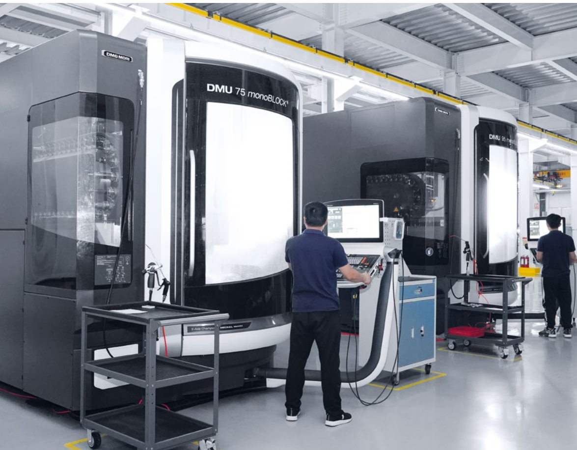
光德流控的两台DMU 75 monoBLOCK加工中心和一台DMU 125 FD duoBLOCK加工中心进行铣削和铣 / 车复合加工。
