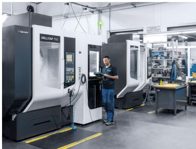
Milltap 700加工中心为Mechanik-Moduls的小型工件进行5轴加工。WH 3 Cell工件搬运系统将其自动化。
