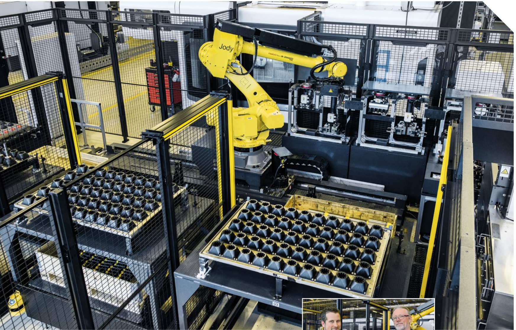
在自动化的NTX 3000车削中心上加工多达150种工件，产能足以进行4个班次的无人值守生产。
