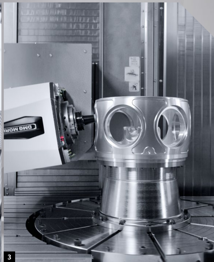
1. 加工CK45钢, 刀头100 mm (F:1,500 mm/min; A P :9 mm) 2. 用DMG MORI技术循环gearMilling加工齿轮 3. 铣/车复合加工, 转速达700 rpm, 最大工件重量达1,200 kg
