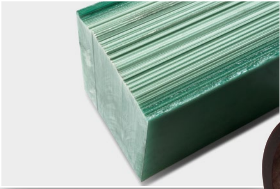
热固性塑料是层压合成树脂的一种制造工艺。包括硬纸层、棉纤维层或此案例中的高硬度环氧树脂玻璃纤维层，此种玻璃纤维非常耐磨，需要使用更高硬度的刀具。
