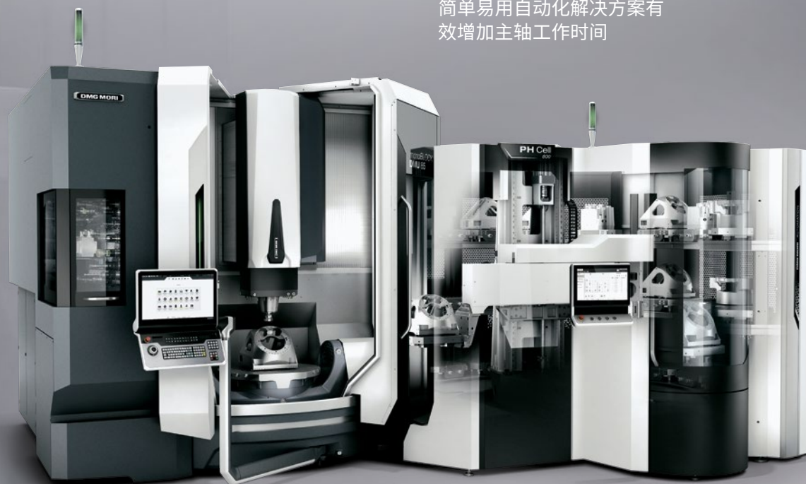
PH Cell 800: 托盘搬运, 从机床正面自由接近加工区
