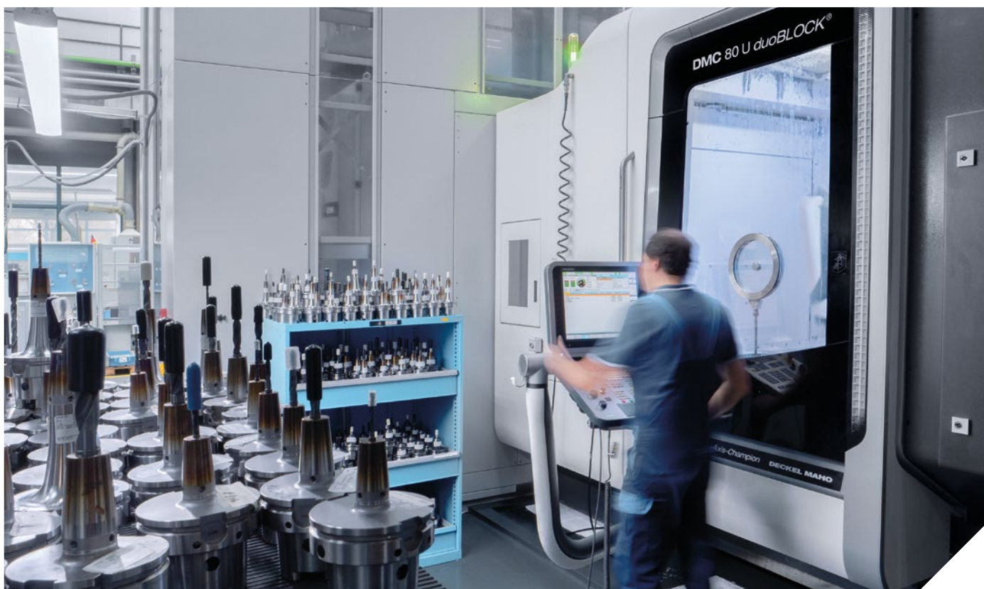
用两套托盘库系统等加工钛合金工件、钢工件和铝合金件。
