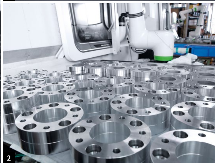
1. 主要工件：还自主设计了工件抓手。 2. 工件可堆垛，可长达数小时连续生产。
