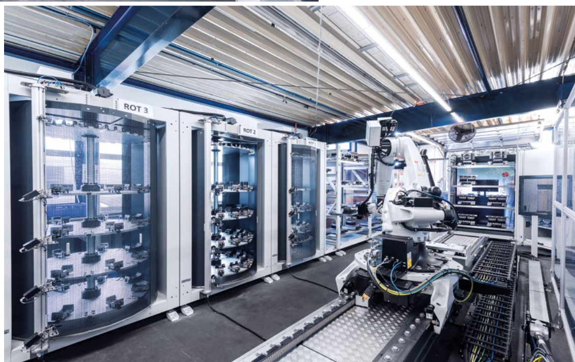
7台DMU 60 eVo铣削加工中心中的两台连接托盘搬运系统。托盘系统提供40盘位和可安装300件夹具,夹具可安装在托盘上。
