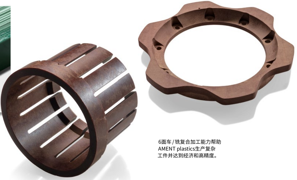
热固性塑料是层压合成树脂的一种制造工艺。包括硬纸层、棉纤维层或此案例中的高硬度环氧树脂玻璃纤维层，此种玻璃纤维非常耐磨，需要使用更高硬度的刀具。
