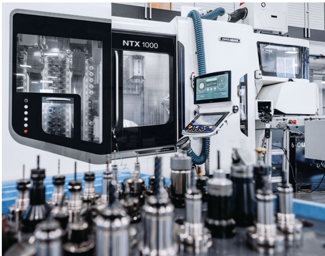
被加工材料造成刀具状况快速恶化, 机床操作员又不在生产现场, 刀具寿命管理系统监测刀具使用寿命, 换用备用刀最大限度提高无人值守生产的可靠性。
