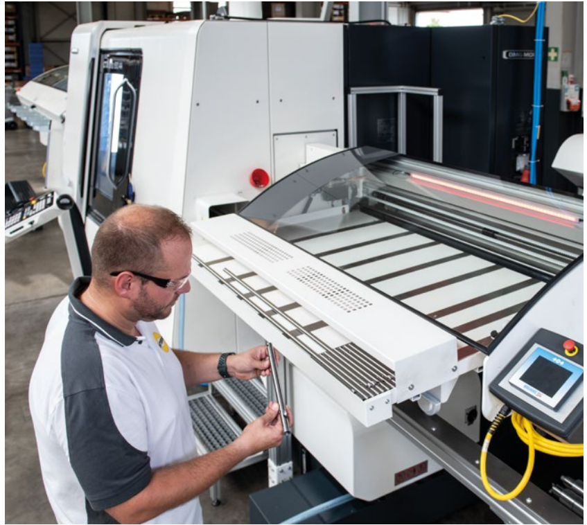
CTX beta 800 4A副主轴退出长件并被卸件系统抓取。
