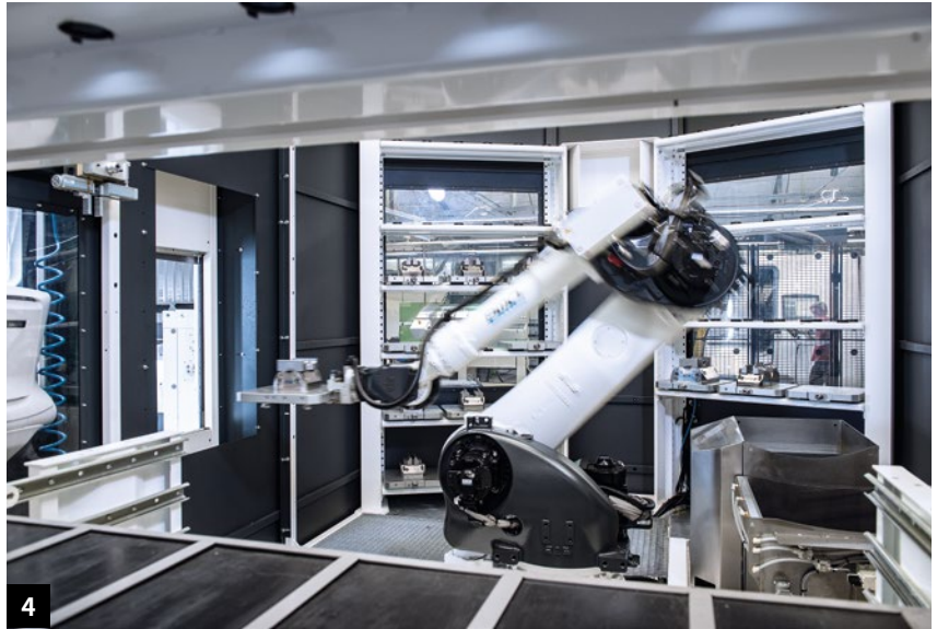
1.+ 2. 两台第三代NXH 5000卧式铣削加工中心显著提高了生产能力。40盘位的直线托盘库将其连接在一起,有效避免长时间待机 3.在配Robo2Go机器人的CTX beta 1250 TC 4A车/铣复合中心上自动生产。 4.复杂工件的灵活5轴加工。两台配机器人自动化系统的DMU 60 eVo铣削加工中心自主生产,工件柜可存放38个机床托盘。
