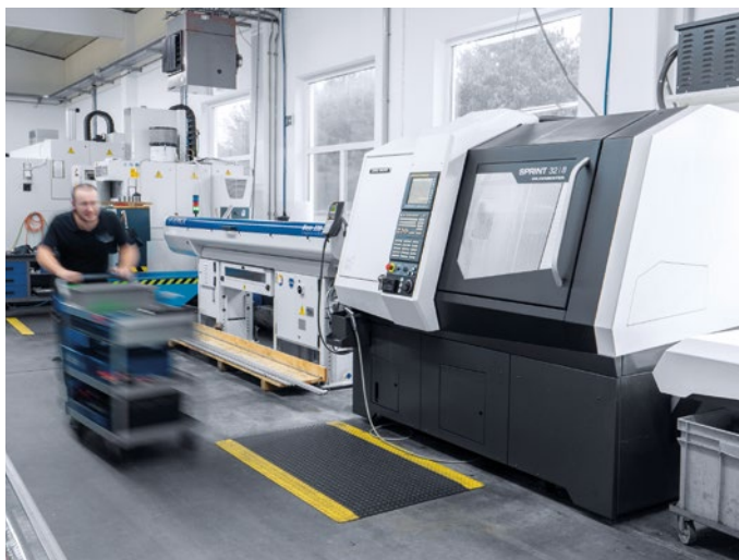
SPRINT 32 | 8:2条独立的直线刀架提供多达28刀位，可高效加工直径达32 mm的工件。
