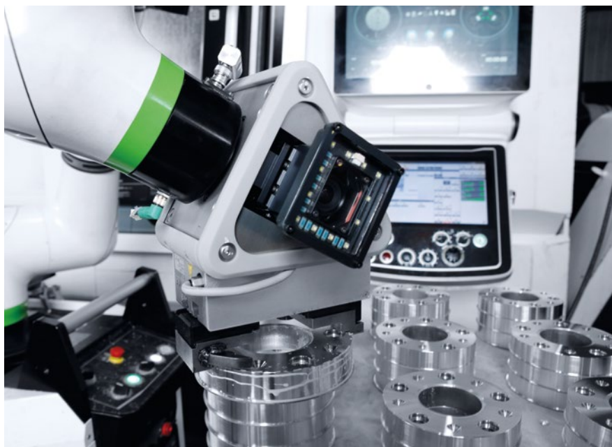
视觉摄像头自动检测工件位置,调整机械手运动,允许连续生产,无需找正
