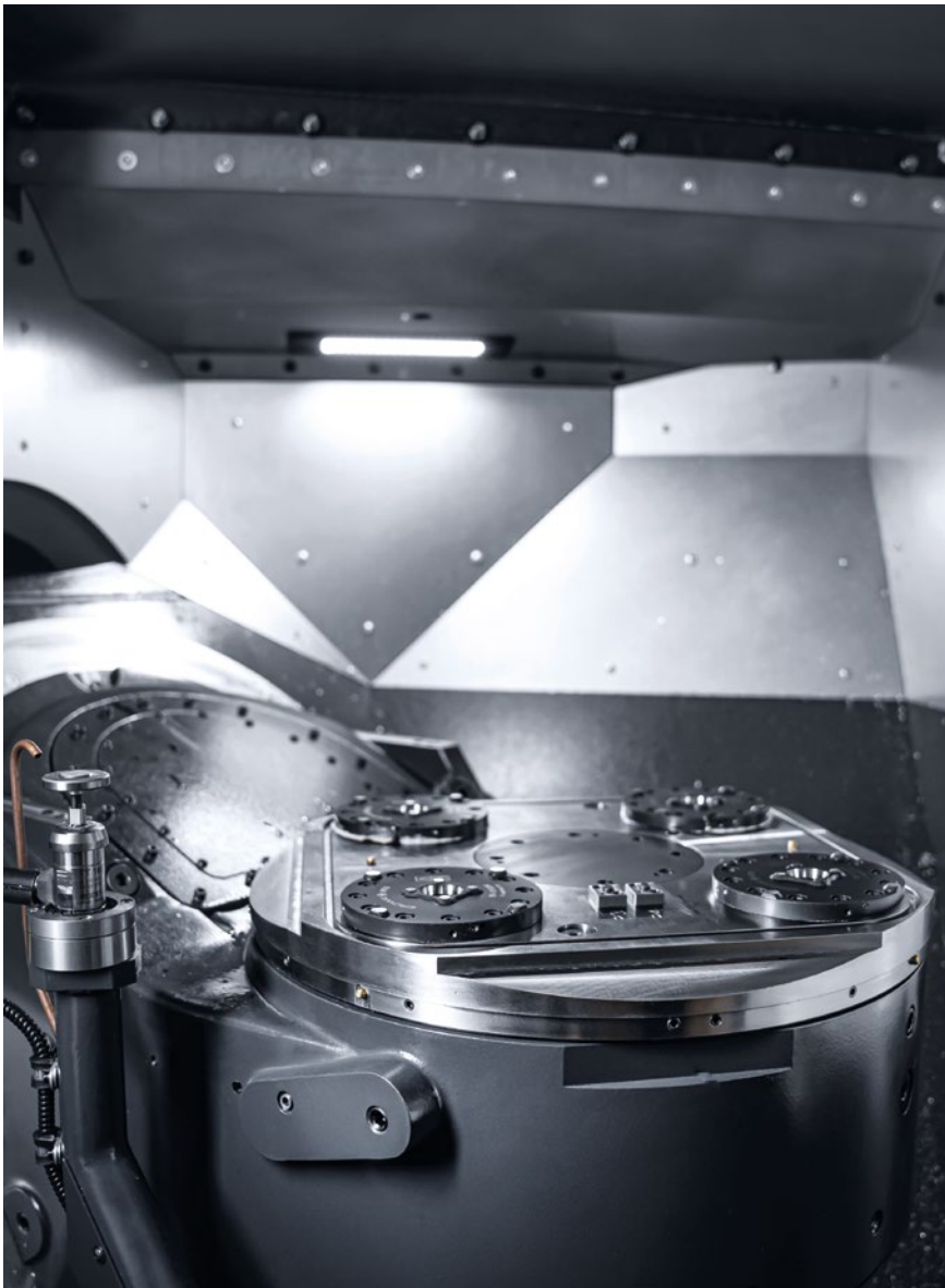
为了充分利用加工区，两台DMU 60 eVo铣削加工中心都配MTS零点夹紧系统且直接安装在工作台上。
