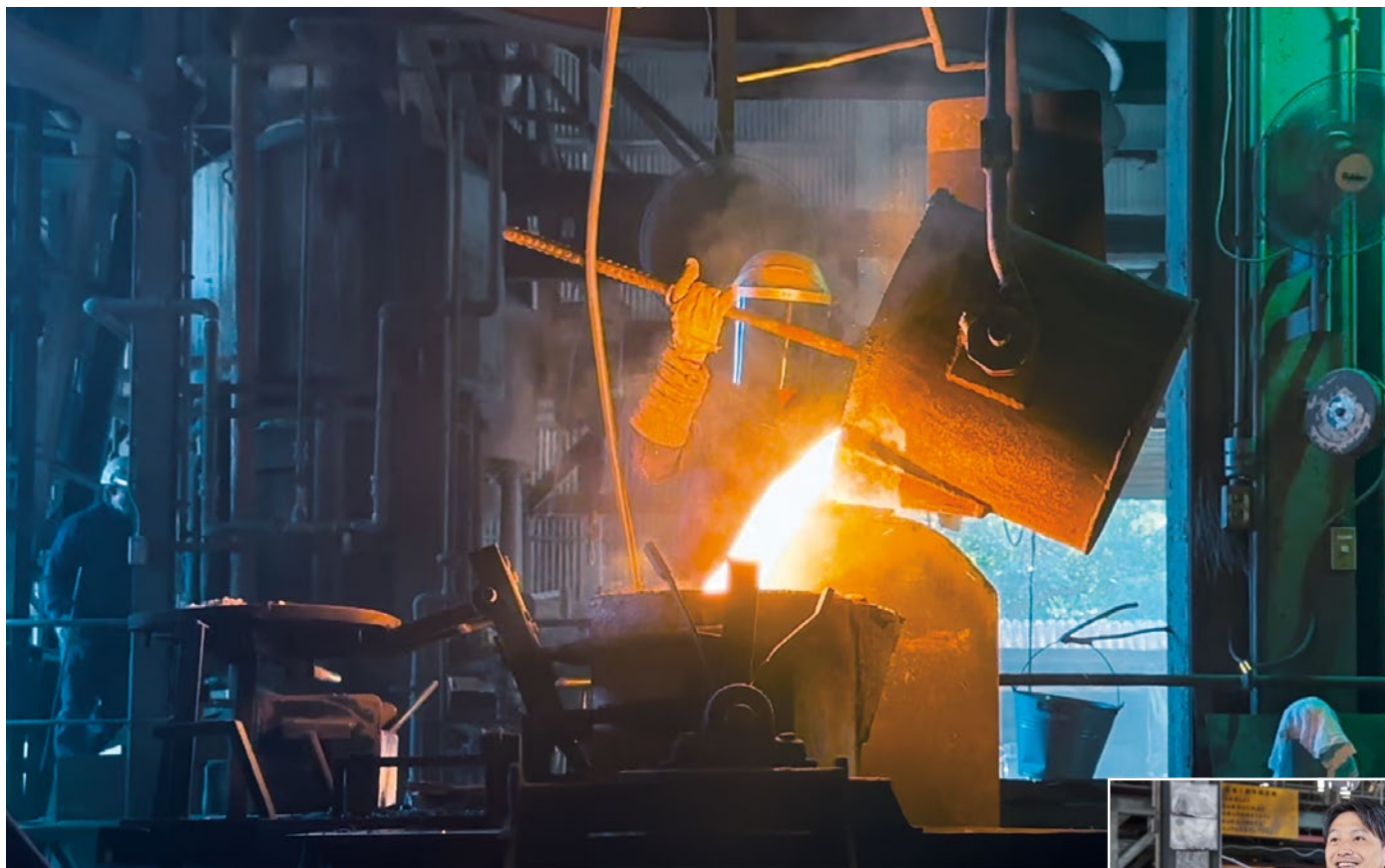
铸造工艺, 金属熔炼和浇注温度超过1,000°C。
