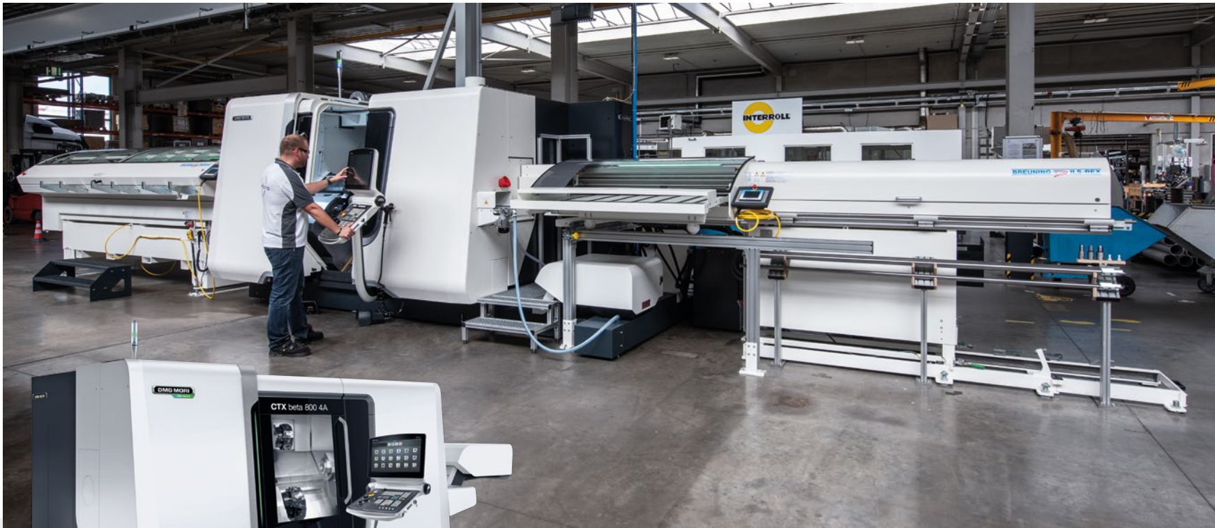
Interroll在CTX beta 800 4A车削中心上全自动加工电动滚筒部件, 从装件到卸件全过程。
