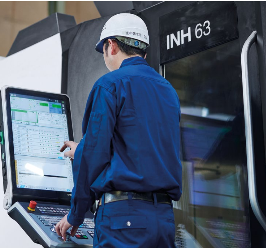
在ERGOLine X控制面板的CELOS X中设置加工任务。
