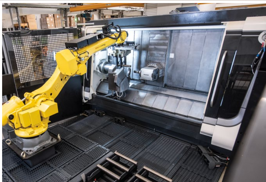
生产工艺包括6面完整加工、钻深孔、磨削和机内测量。
