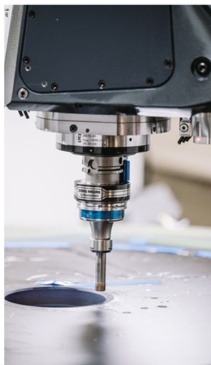
在超声加工中,金刚石刀在自身高速旋转的同时,沿轴向高频、小振幅振动。
