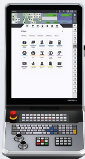
24" ERGoline X 控制面板 配MAPPS数控系统
