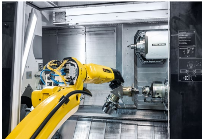
Két munkadarab egyidejű megmunkálása: Amint a megmunkálás a főorsón befejeződött, és az alkatrész a Robo2Go segítségével átkerült az ellenőrsőre, egy új előgyártmány kerül befogásra.
