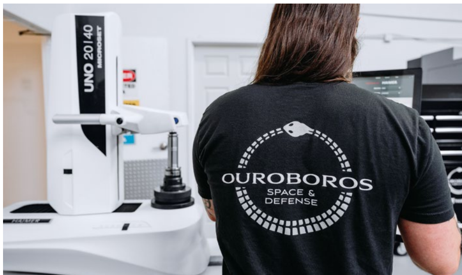
A nagy pontosságú szerszámbefogás eléréséhez az OROBOROS a DMPQ (DMG MORI Qualified Products) partnerének, a HAIMER-nek a szerszámbemérőjét használta.
