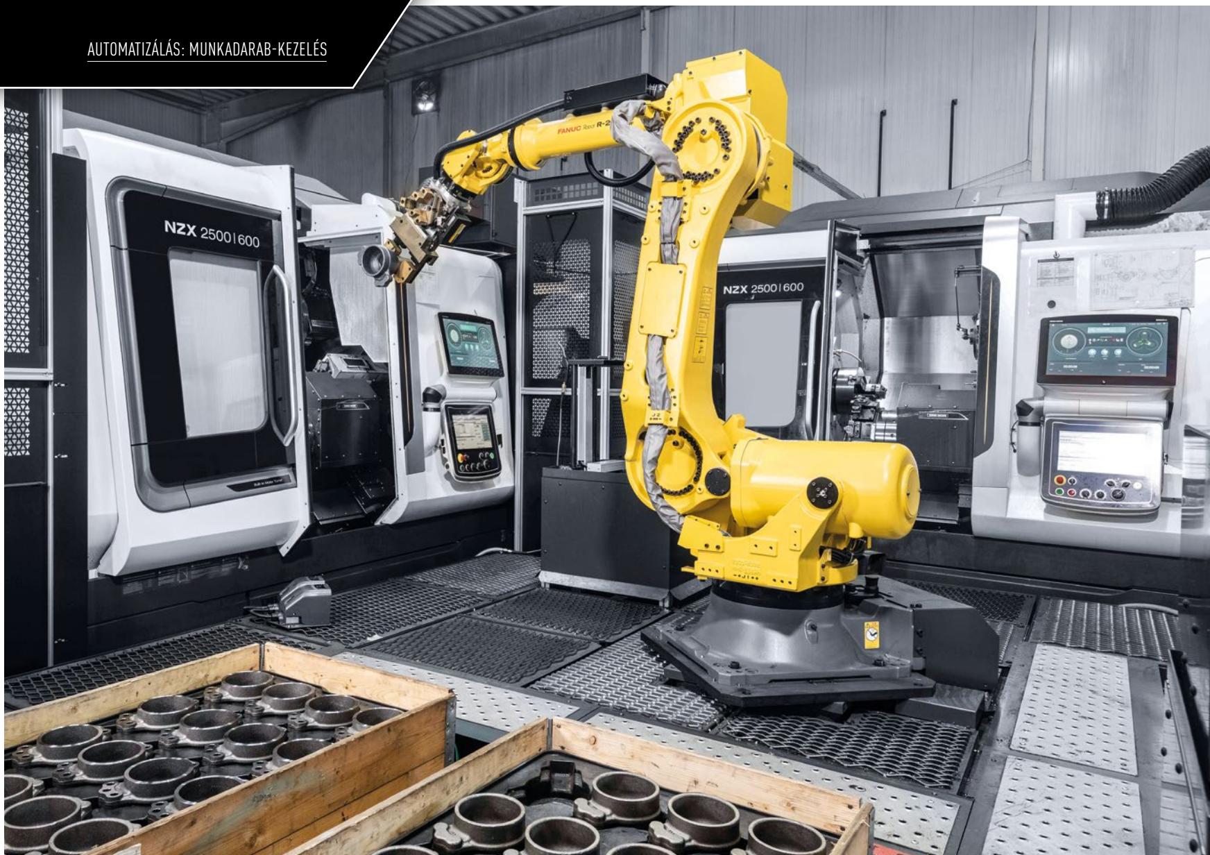
A leolvasó rendszerrel ellátott robot a két NZX 2500-at a tengelycsonkok bal és jobb oldali változatával tölti be és rakodja ki.
