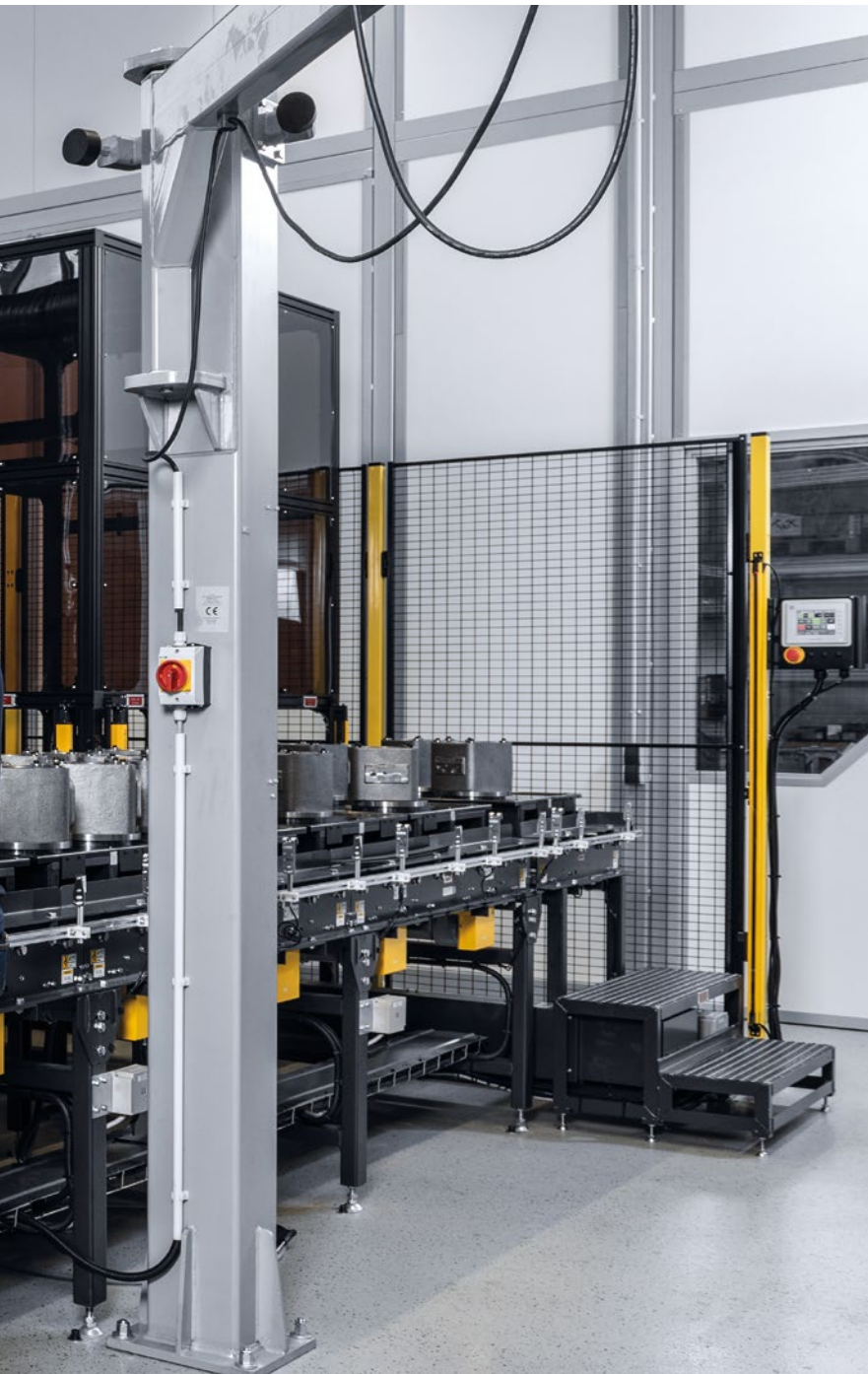
카메라는 플랫폼에서 부품의 정확한 위치를 포착합니다. 로봇은 이미지를 기반으로 정확하게 공작물을 집습니다.
