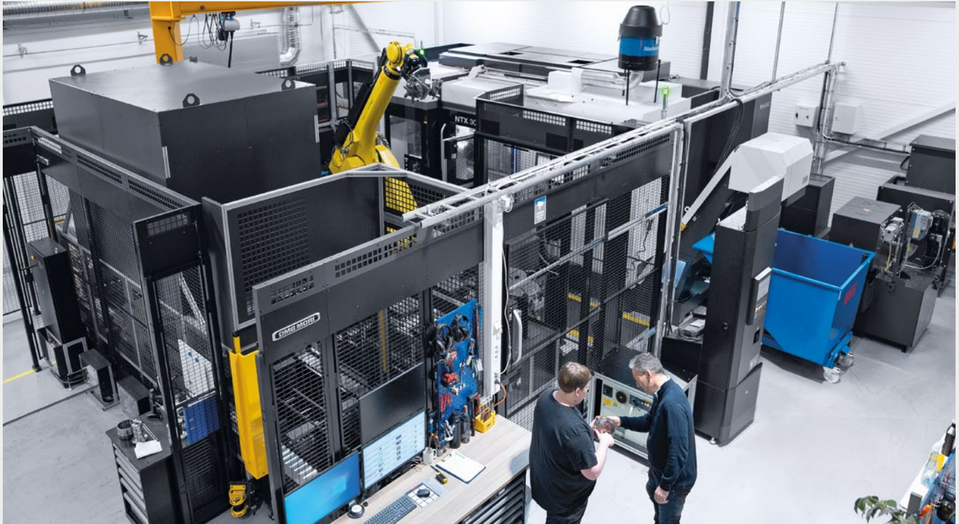
NTX 3000은 MATRIS의 공작물 핸들링 시스템으로 무인근무 방식으로도 가동할 수 있습니다. 또한 15개 미만의 소규모 배치 생산도 가능할 정도로 높은 수준의 유연성을 갖추고 있습니다.
