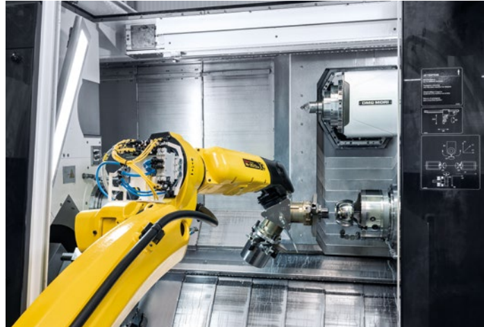
두 개의 공작물 동시 가공: 메인 스피들에서 가공이 끝나고 Robo2Go가 바로 부품을 카운터 스피들로 옮기자마자 새로운 미가공 빌렛을 클램핑합니다.
