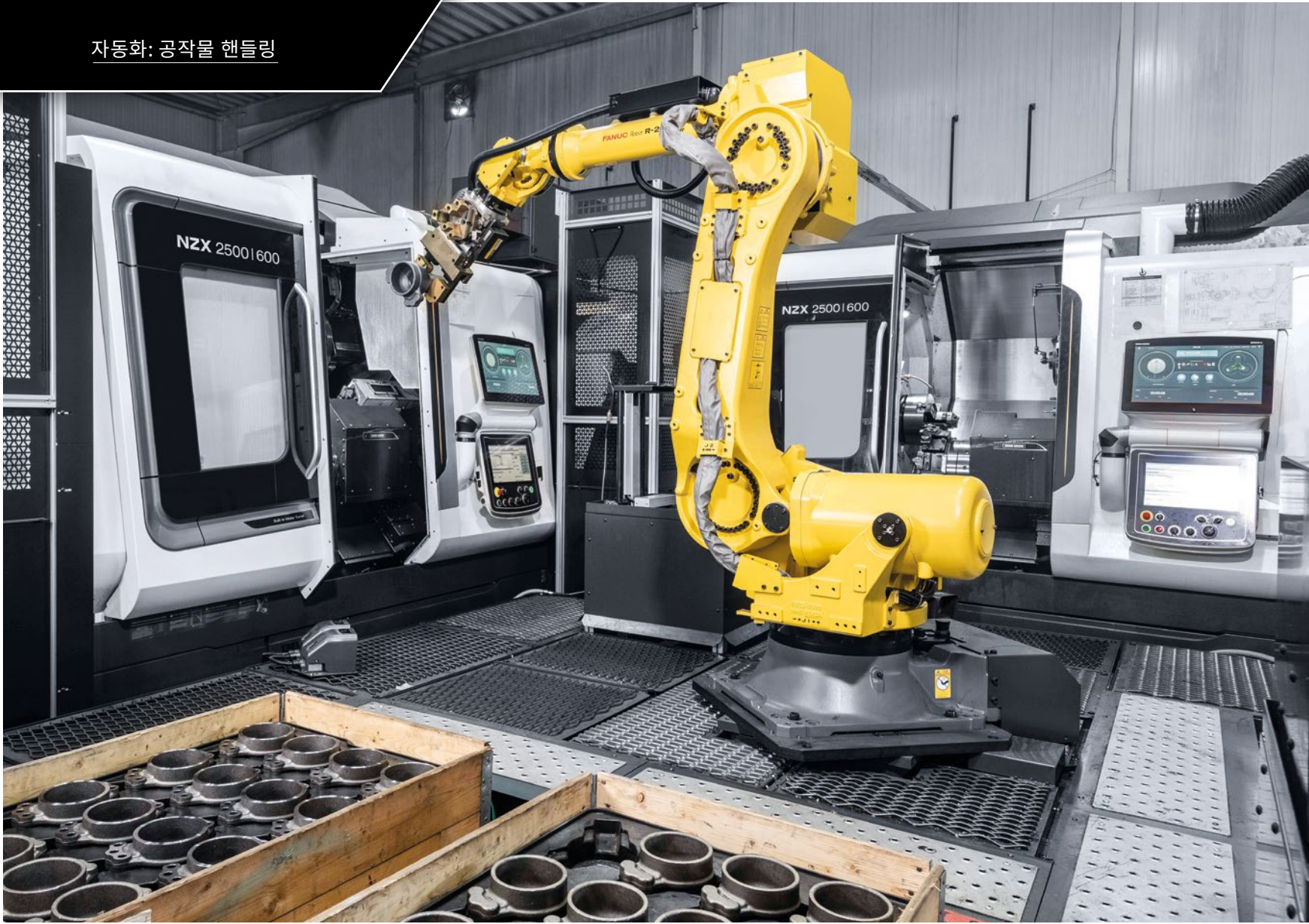
비전 시스템을 갖춘 로봇이 NZX 2500 두 대에 반복적으로 왼쪽 버전의 스테르 액슬과 오른쪽 버전의 스테르 액슬을 적재 및 제거합니다.
