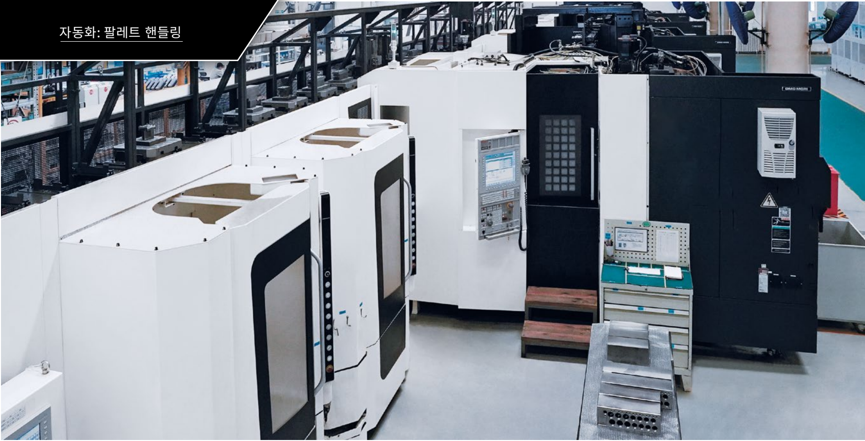
LPP Systems 중 하나: 48개의 팔레트 스테이션, 2개의 셋업 스테이션 및 NH 5000 DCG 4개를 갖춘 LPP 시스템
