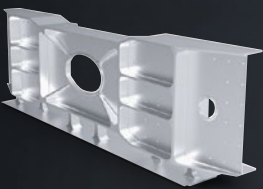
구성 부품 산업영역: 항공우주 소재: AlMg4.5Mn 수치: 745 × 220 × 110 mm 가공 시간: 120분
