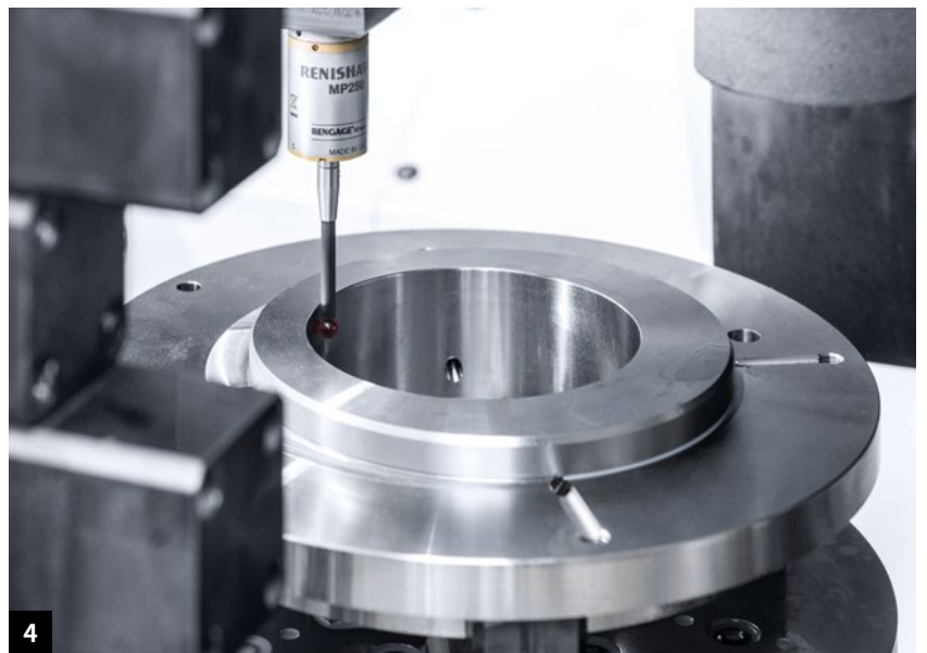
1. Richter Feingerätebau의 공인 서명인 Thomas Strauß (오른쪽)과 공인된 서명인/기술 관리자 Horst Hoferichter 2. 내외장 그라인딩 스피들이 장착된 IGV-3NT는 단일 설정에서 내, 외부 및 평탄면의 그라인딩을 가능하게 합니다. 3. DMG MORI는 2022년에 Richter Feingerätebau에 개별적으로 설계된 자동화 솔루션이 포함된 IGV-3NT를 설치했습니다. 4. 모든 부품은 가공 후 터치 프로브로 점검합니다.
