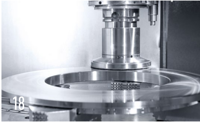
다이아몬드로 다이아몬드 가공 Tyrolit – Schleifmittelwerke Swarovski AG & Co KG. (오스트리아) 프로세스 통합: 밀 & 턴 (FC)+그라인딩
