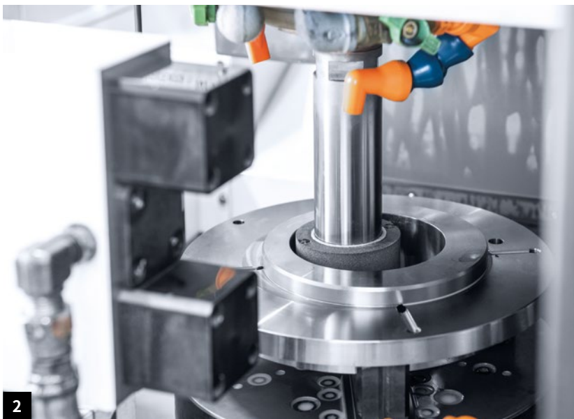
1. Richter Feingerätebau의 공인 서명인 Thomas Strauß (오른쪽)과 공인된 서명인/기술 관리자 Horst Hoferichter 2. 내외장 그라인딩 스피들이 장착된 IGV-3NT는 단일 설정에서 내, 외부 및 평탄면의 그라인딩을 가능하게 합니다. 3. DMG MORI는 2022년에 Richter Feingerätebau에 개별적으로 설계된 자동화 솔루션이 포함된 IGV-3NT를 설치했습니다. 4. 모든 부품은 가공 후 터치 프로브로 점검합니다.
