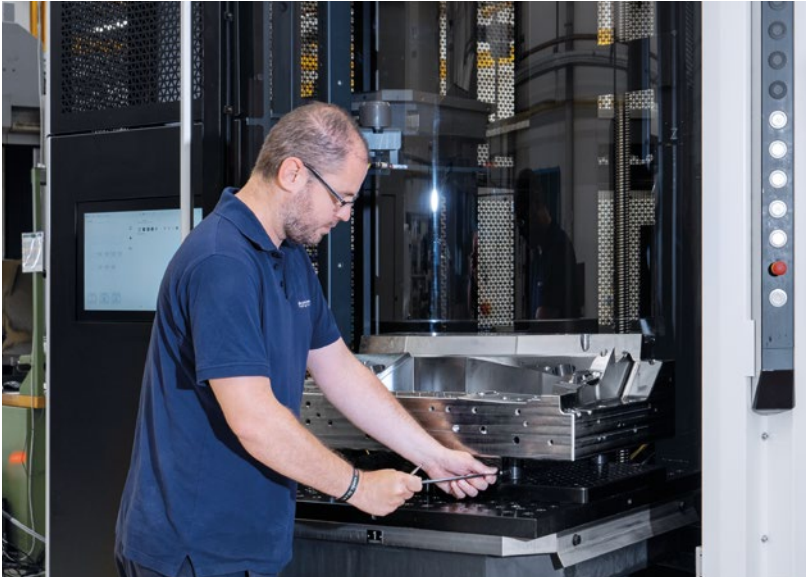
PH Cell 2000: 생산과 동시에 많은 팔레트를 준비할 수 있기 때문에 밤에도 기계 중지 시간이 최소화됩니다.
