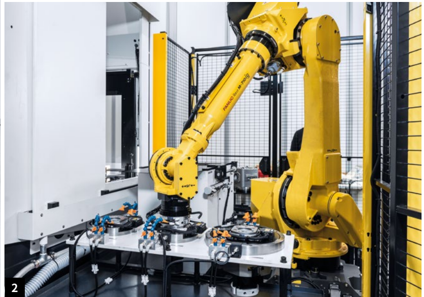
1. DMG MORI는 자동화 내부에 송풍 스테이션을 통합해서 부품의 가공 전후에 모든 부품을 세척해 줍니다. 2. Richter Feingerätebau는 여러 개의 그리퍼를 활용해서 다양한 공작물을 자동으로 가공할 수 있습니다.
