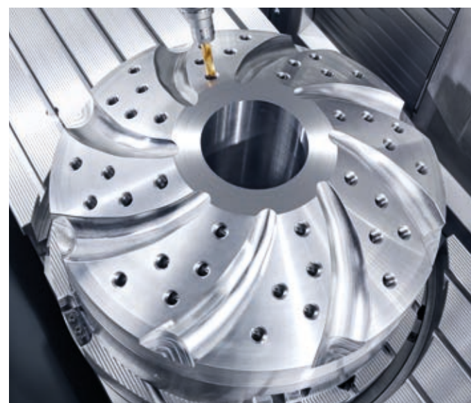
Tavola circolare CN integrata per la lavorazione a 5 assi e operazioni di fresatura / tornitura.
