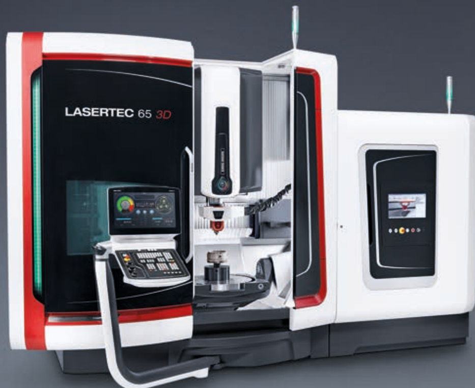
Flessibile attacco HSK: LASER + Mill + ULTRASONIC*
