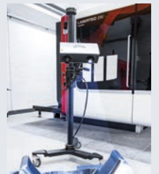
Misurazione della geometria utensile mediante scanner 3D.
