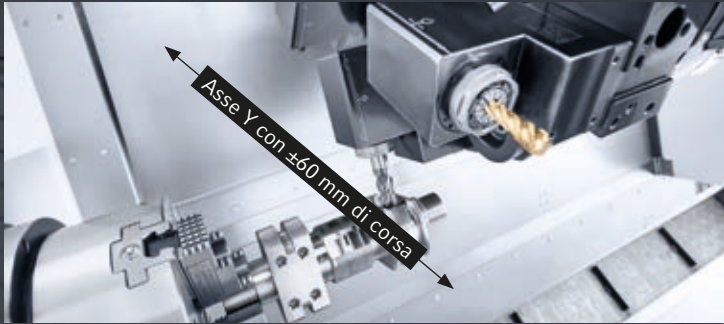
OPZIONE // Asse Y con 60 mm di corsa, fresatura su torni
