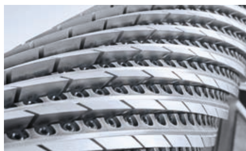
Fresa rasatrice elicoidale allestita con diverse centinaia di coltelli.
