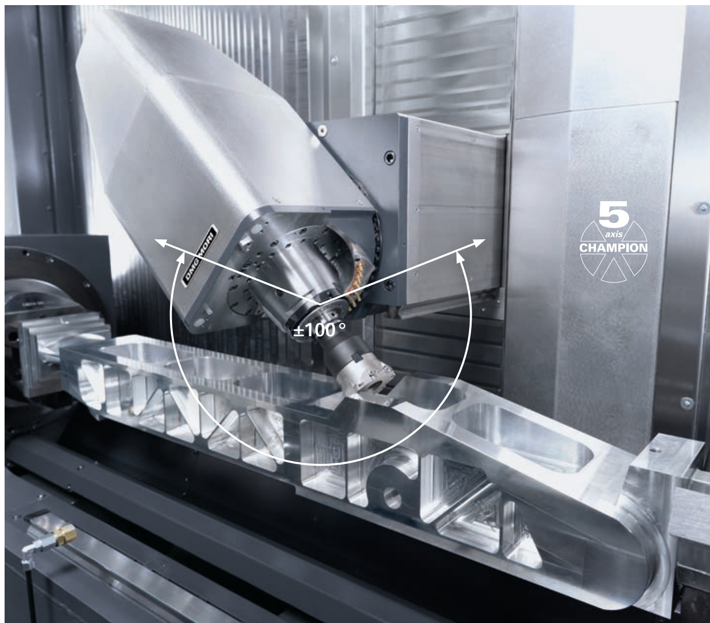
Lavorazione a 5 assi di una traversa sulla DMF 26017 con cornice tecnologica.
