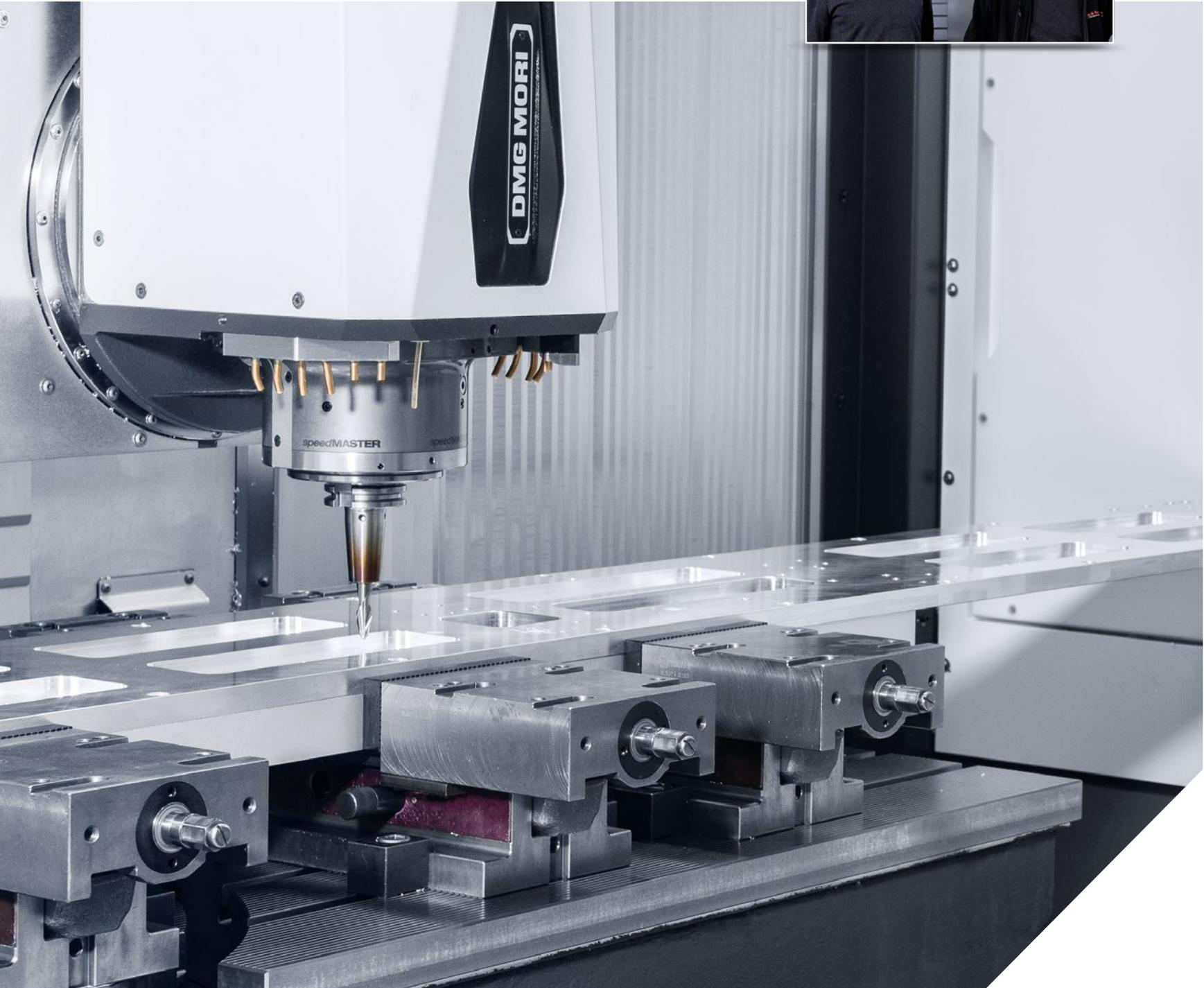
DMF 的新式移動柱概念實現了延伸到工作區之外的長型元件進行加工。
