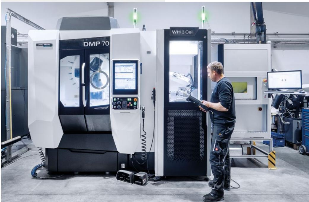
最小空間要求: DMP 70 和 WH 3 Cell 佔地面積不到 9 m<sup>2</sup>。根據工件尺寸, WH 3 Cell 可容納 1,000 多個工件。
