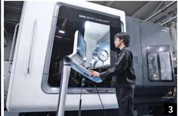
3. DMU 80 FD duoBLOCK 5軸車削和銑削工具機可替代多部車削中心、銑削中心和齒輪切削工具機。
