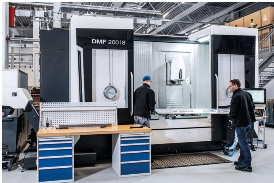
DMF 200 | 8 用於製造長且精度高的型材元件。
