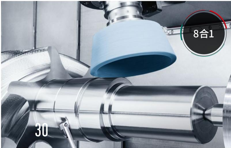
由於將車削、銑削、磨削、齒輪切削、量測、超音波、雷射技術和積層製造等8項技術整合在一部機台上，因此縮短了循環時間。
