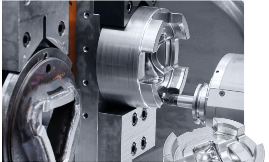
1.+2. Hirschvogel 仰賴自動化 5 軸加工中心，例如配備 PH Cell 2000 的 DMU 85 H monoBLOCK，在非常有限的生產空間內提高產能。
