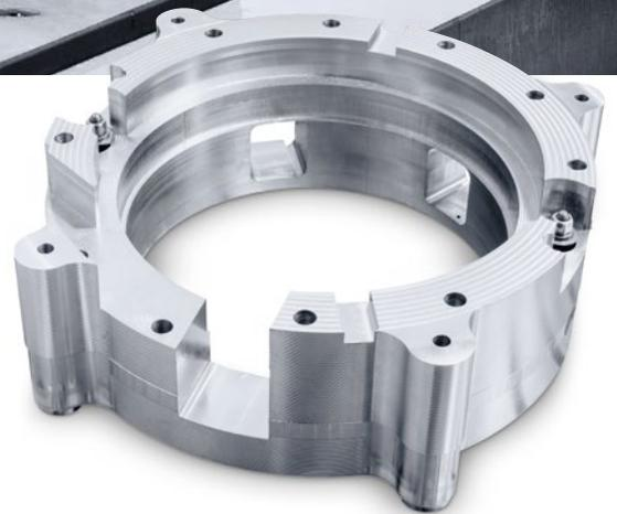
直徑達  $\phi 1,600$  mm 的大型機器元件(例如這款法蘭)在新型 DMC 160 U duoBLOCK 上作加工。
