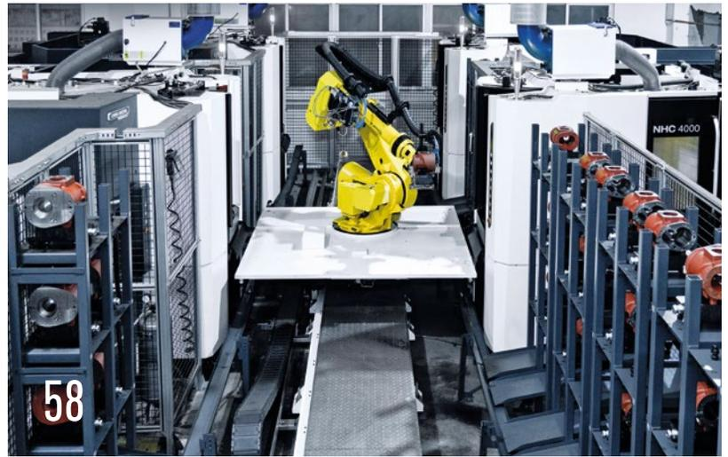
廈門：在兩條生產線上進行空氣壓縮機外殼的生產，每條生產線由四部 NHC 4000 和一部移動式機器手臂組成。
