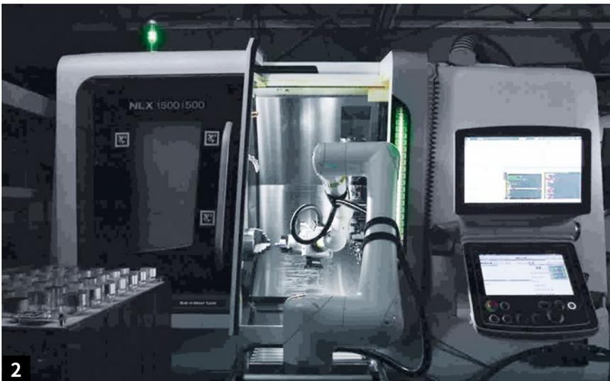
1. 德馬吉森精機的NLX 1500車削中心和MATRIS Light, 用於SATELLITE FIRE BASE的元件加工。
