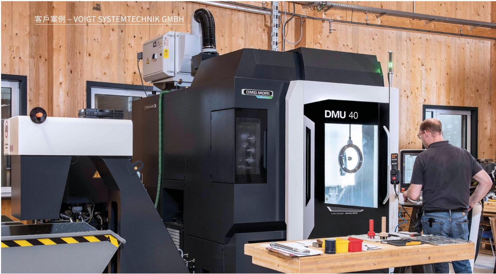
DMU 40 是真正節省空間的奇蹟。它的佔地面積小於 5.1m<sup>2</sup>，寬度小於 2m，可提供空間用於達  $\varnothing 500 \times 445$  mm 和 300 kg 的工件。DMU 40 PRO 在 Voigt Systemtechnik 安裝了一個自動側門，為日後的自主性作業做好準備。
