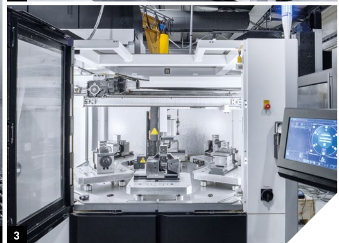
1. Op de DMU 340 Gantry vervaardigt Schittl onder meer uiterst precieze machinebedden. 2. + 3. Schittl heeft geautomatiseerde 5-assige bewerkingen gerealiseerd op een CMX 70 met PH 150. Voor toezichtloze of bijna autonome productie heeft de PH 150 meer dan 8 palletposities.
