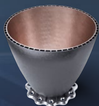
Raketstraalpijp LUCHT- EN RUIMTEVAART Materiaal: CuNiSiCr + Inconel 625 Afmetingen: \varnothing 300 \times 250 mm
