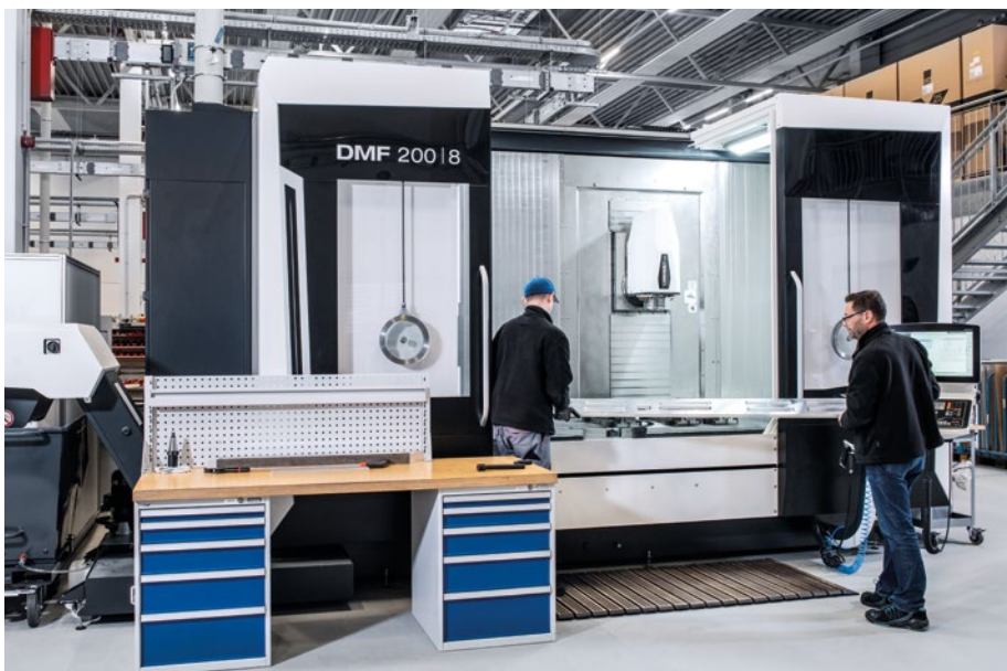
De DMF 200|8 wordt gebruikt voor de productie van lange en zeer nauwkeurige profielonderdelen.
