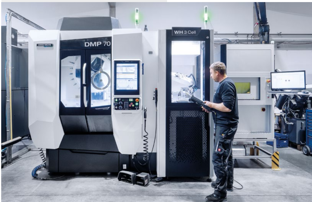
Kleinste ruimtebeslag: De DMP 70 en de WH 3 Cell vragen minder dan 9 m 2 vloeroppervlak. Afhankelijk van de werkstukgrootte biedt de WH 3 Cell plaats aan meer dan 1.000 werkstukken.
