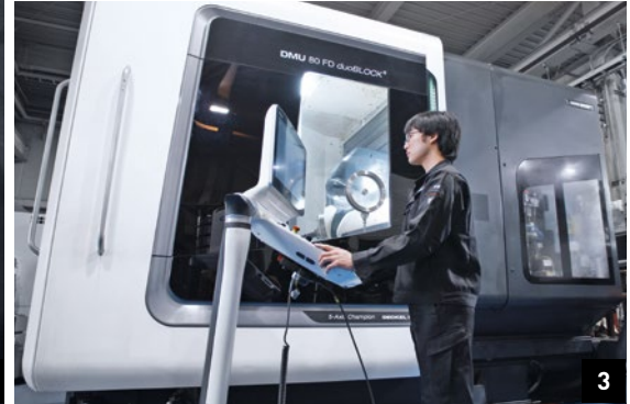
3. Het 5-assig frees-draaicentrum DMU 80 FD duoBLOCK kan meerdere draaicentra, freescentra en tandwielmachines vervangen.
