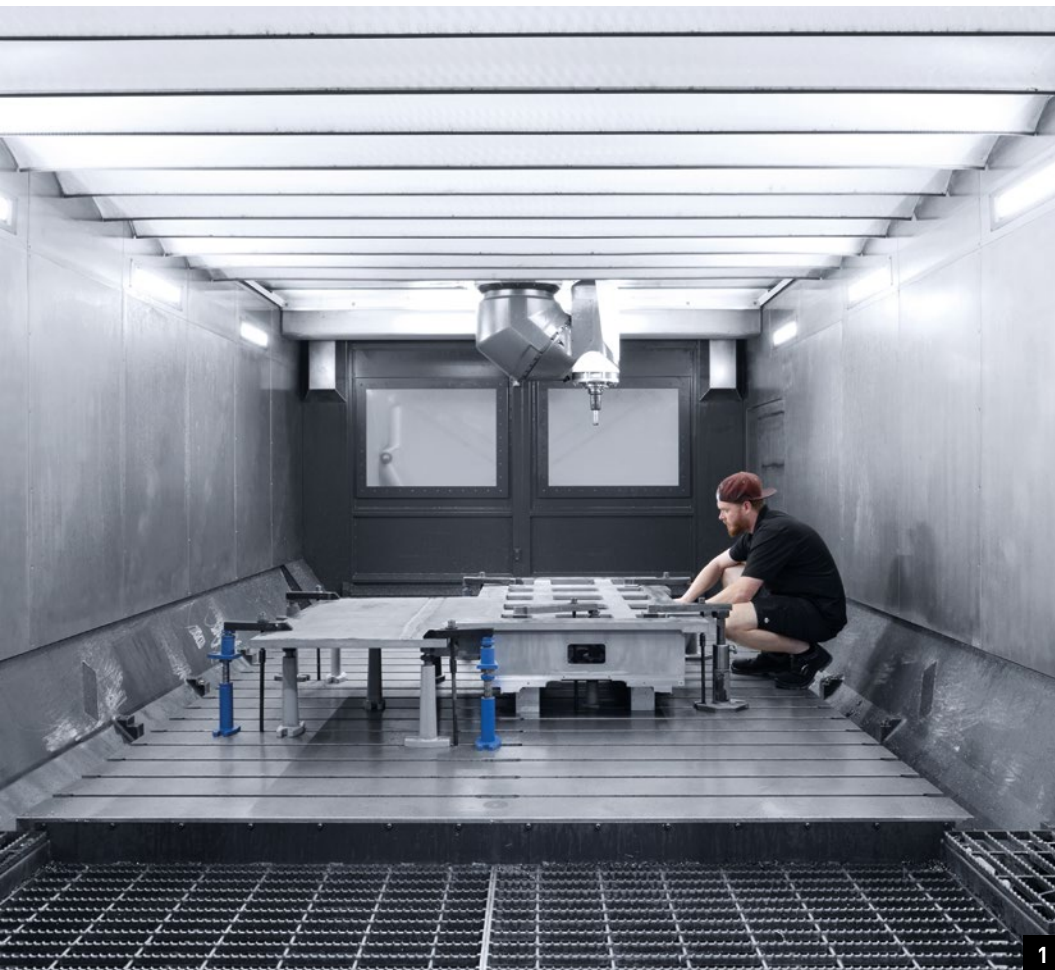
1. Op de DMU 340 Gantry vervaardigt Schittl onder meer uiterst precieze machinebedden. 2. + 3. Schittl heeft geautomatiseerde 5-assige bewerkingen gerealiseerd op een CMX 70 met PH 150. Voor toezichtloze of bijna autonome productie heeft de PH 150 meer dan 8 palletposities.
