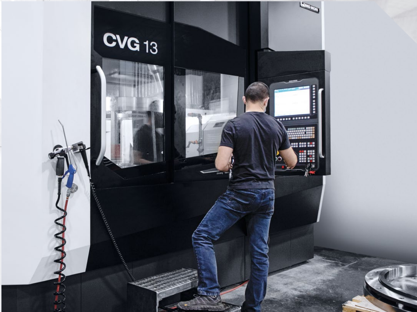
在表面處理過程中，NAMCO 在其他機台中使用 CVG 13。 可研磨直徑達 1,300 mm 的大型元件。
