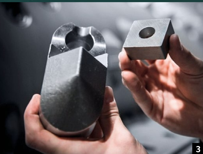
3. 用於 Micromat 切碎機的 Mono-Fix 刀架和嵌入式切刀。
