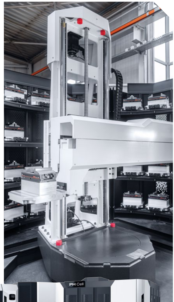
第三代 DMU 50 可從側面進行裝載， 這為機台和自動化提供了最佳的可用性。 PH Cell 總共配備了 40 個托盤儲存位置。
