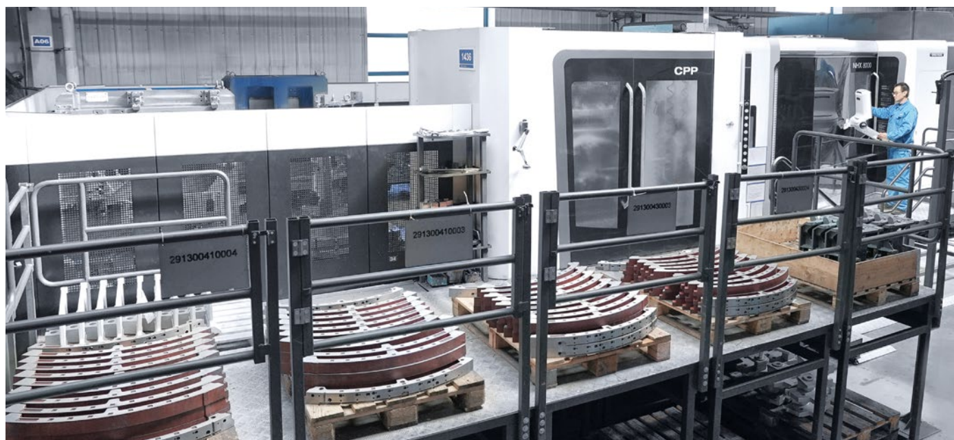
Trützschler 使用配備有 7 站式搬運托盤池 (CPP) 的 NHX，適用於大型元件的自動化製造。
