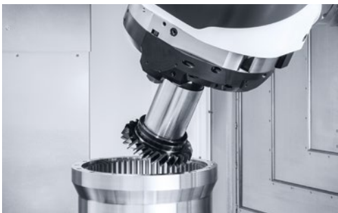
車銑 齒輪可達模數 11 (例如 DMC 80 FD duoBLOCK)
