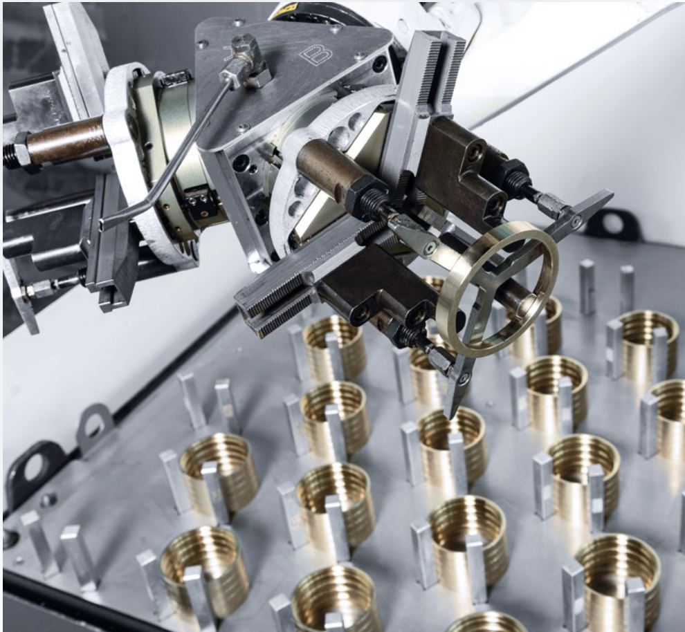
Robo2Go 堆疊式刀匣提供了足夠的容量， 可以使用 CTX beta 800 TC 實現全天候生產。
