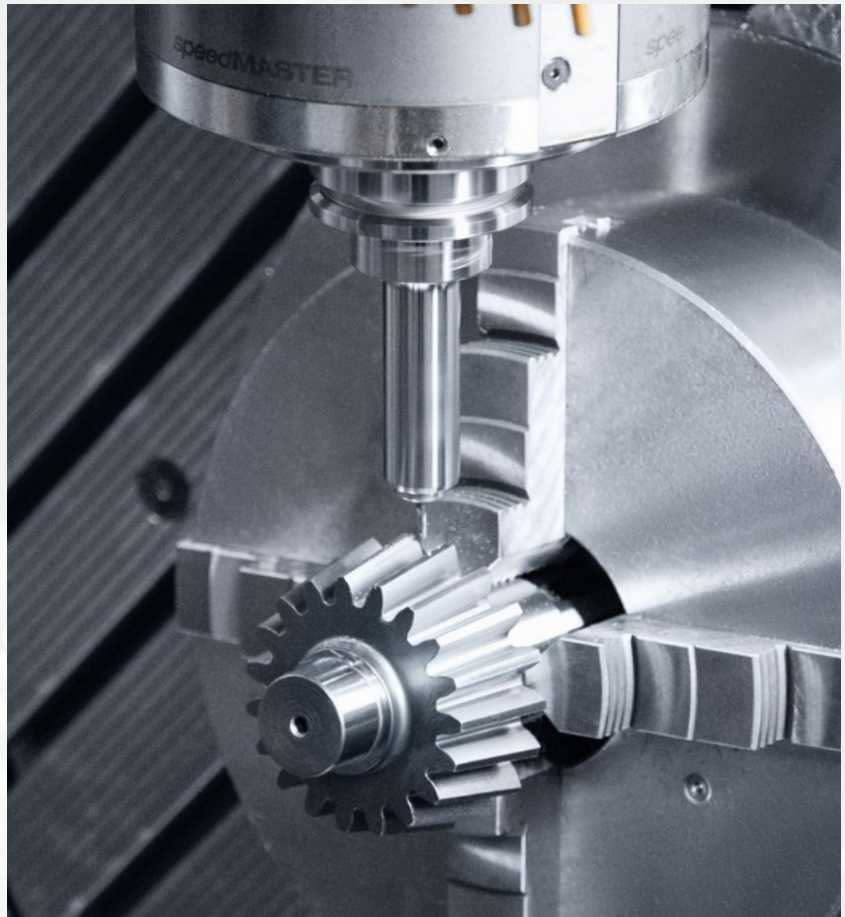
對於較小型的特殊齒輪, NAMCO 使用了 DMU 65 monoBLOCK 等設備, 該設備透過 PH 150 實現自動化。
