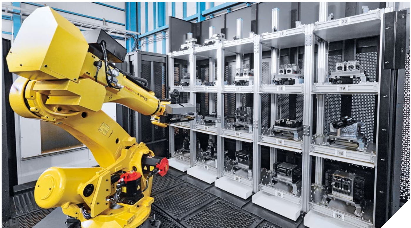
20개의 팔레트용 랙이 장착된 MATRIX 로봇 자동화 시스템. 여기에서는 Nabeya에서 제조한 클램핑 장치와 로봇 그리퍼가 사용됩니다.
