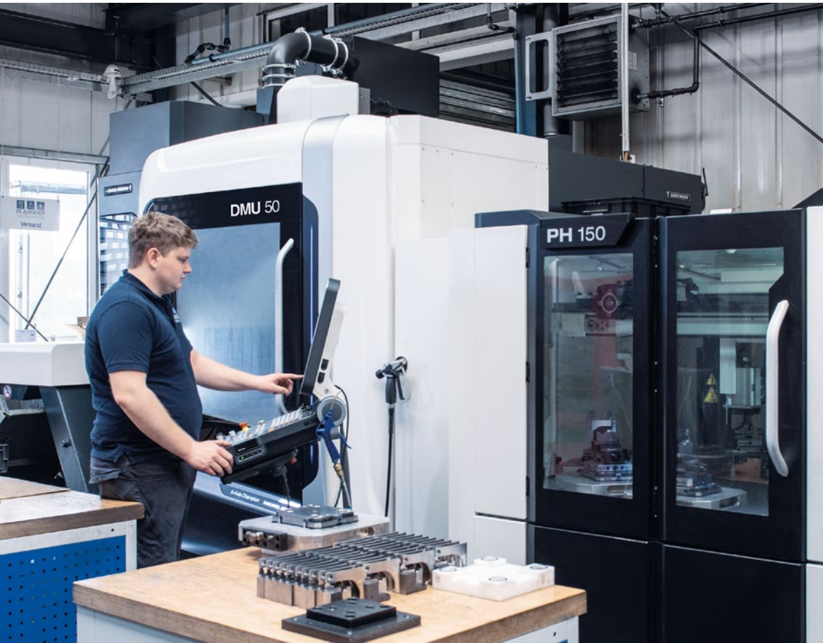
Aussieker는 2019년에 DMU 50과 PH 150 팔레트 핸들링 시스템으로 자동 5축 가공에 들어갔습니다. PH 150의 팔레트 10개면 야간 무인 가동을 충분히 감당할 수 있습니다.
