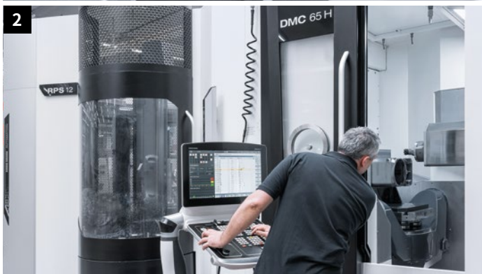
1. 펌프 진공 하우징을 위한 회주철 및 스테인리스강 부품 가공 2. 수평 머신에서는 중력 하에 칩을 배출하므로 안정적인 생산이 가능합니다.
