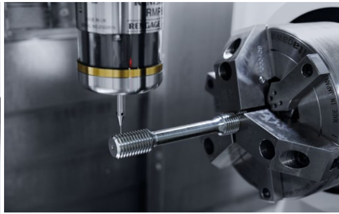
나사선의 측정은 \phi 1\text{mm} 의 작은 직경 스타일러스로 기계에서 이루어집니다.
