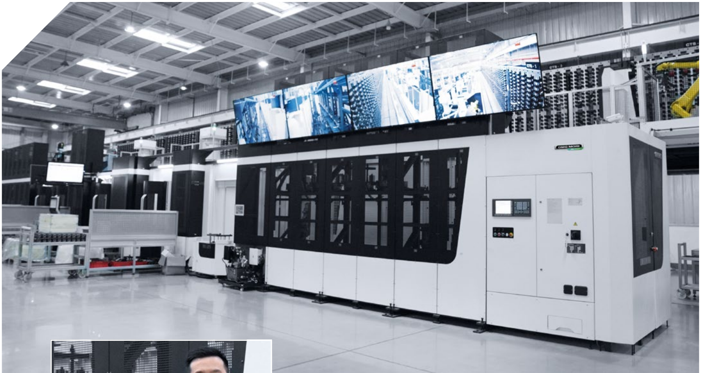
기계와 팔레트, 공구 자동화의 전체 제어를 위한 호스트 컴퓨터를 포함하여 4,000개의 공구와 48개의 팔레트를 수용하는 자동화 솔루션
