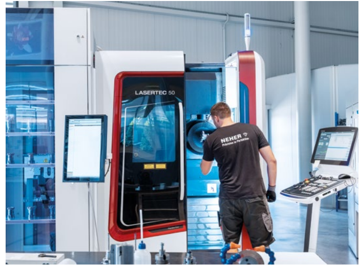
PCD와 CVD 커팅 에지는 DMG MORI의 LASERTEC 20 PrecisionTool과 LASERTEC 50 PrecisionTool에서 레이저 마무리의 형태로 '마무리 터치'를 합니다.
