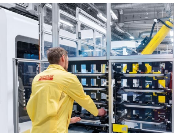
터렛용 자동 공구 교환. MATRIS에 32개의 공구를 수용하는 별도의 공구 매거진 통합
