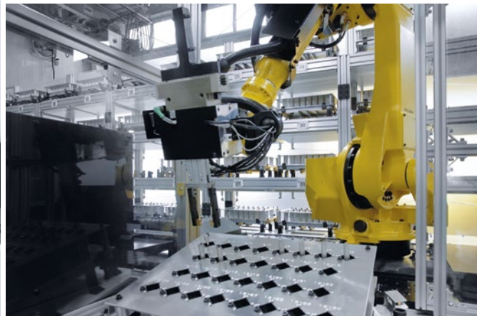
팔레트 창고 시스템에 연결함으로써 시스템이 24시간 많은 수의 공작물을 무인 생산할 수 있습니다.
