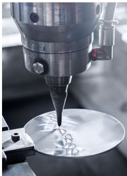
공구의 PCD와 CVD 요소는 LASERTEC 20 FineCutting의 블랭크에서 커팅됩니다.
