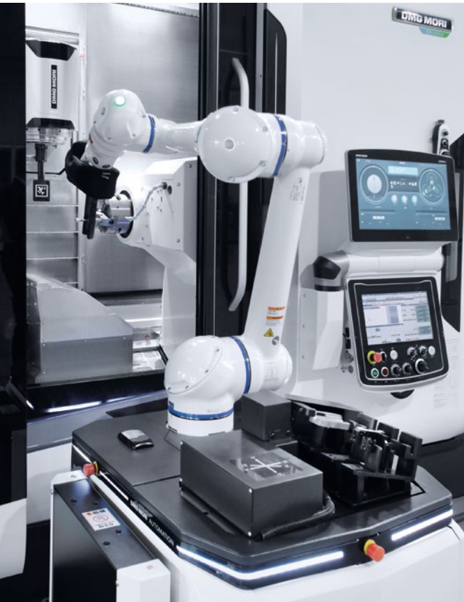
WH-AGV 5'는 2대의 NTX 1000 2세대로 공작물을 운송하며, 공작물 길이는 공작물 트레이에서 자동으로 측정됩니다.
