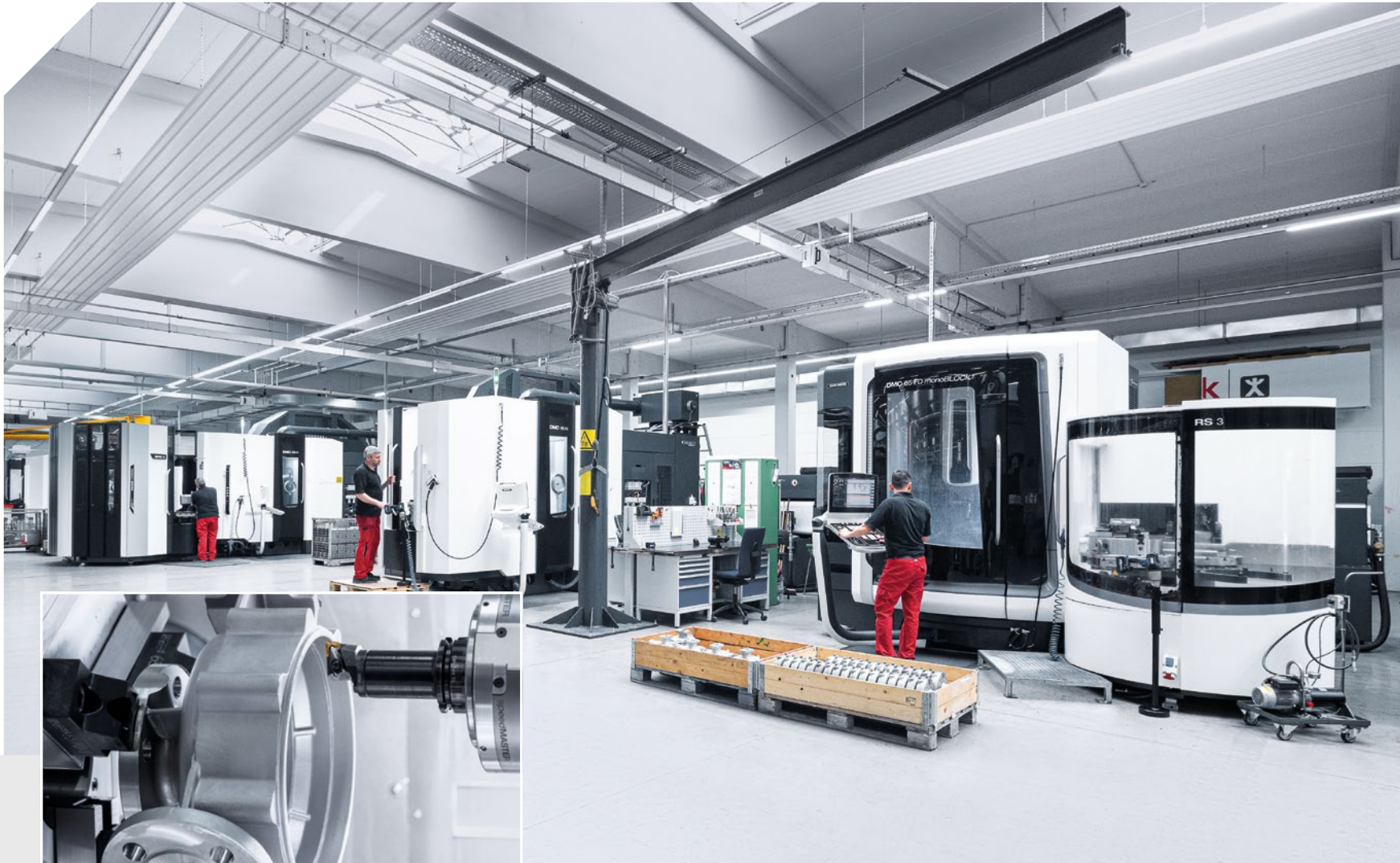
SPECK Pumpen은 로트의 공장에서 고정밀 펌프 부품 생산을 위해 75대의 기계를 사용 중입니다. 이 기계들에는 DMC 65 FD monoBLOCK 한 대와 신형 DMC 65 FD H monoBLOCK 한 대, 그리고 RPS 12 회전식 팔레트 스토리지 시스템이 장착된 DMC 65 H monoBLOCK 한 대가 포함됩니다.
