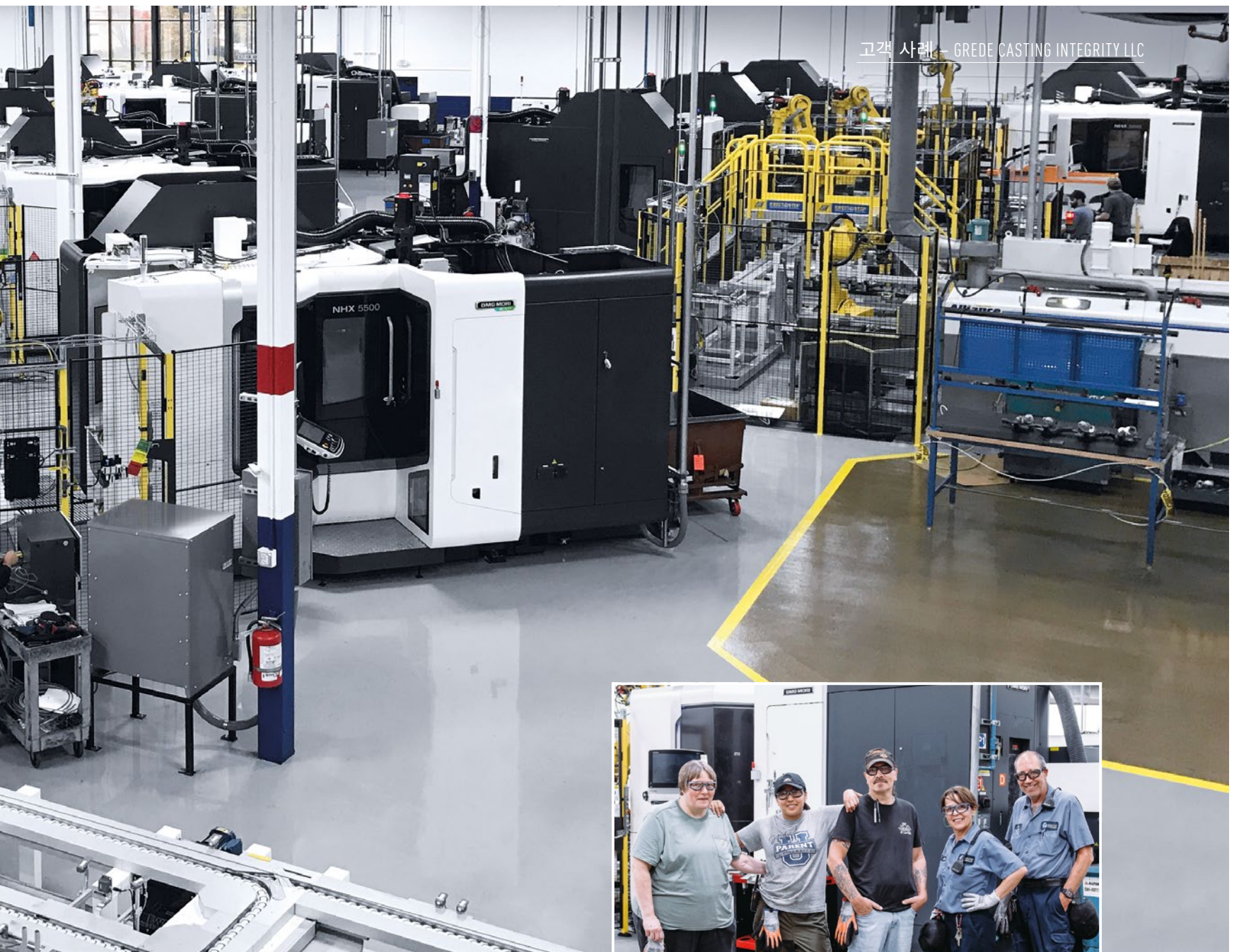
18대의 NHX 5500과 10개의 로봇으로 구성된 생산 라인. 한 대의 로봇이 2대의 NHX 5500을 담당합니다. 10번째 로봇은 블랭크를 채우고, 완성된 부품을 별도의 세척 및 측정 셀로 운송합니다.
