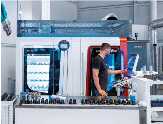
LASERTEC 20 PrecisionTool에는 최대 54개의 HSK 공구를 수용할 수 있는 PH 10 핸들링 시스템이 있어서 LASERTEC PrecisionTool로 야간이나 주말에도 무인으로 가동할 수 있습니다.
