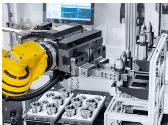
MATRIS 로봇은 NTX 2000에 공작물을 로딩 및 언로딩하고 터렛과 센터, 척 inser트의 공구를 교환합니다.
