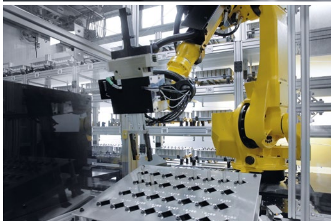
Conexiunea la depozitul de palete permite producția fără personal a unui număr mare de piese de prelucrat în decurs de 24 de ore.
