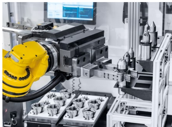
Robotul din MATRIS încarcă și descarcă modelul NTX 2000 cu piese de prelucrat și schimbă atât sculele în turelă, precum și punctele de centrare și mandrinele.
