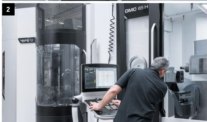
1. Prelucrarea componentelor din fontă și oțel inoxidabil turnat pentru carcasa de vid a pompelor. 2. Căderea liberă a așchiilor a conceptului de mașină orizontală permite o producție cu siguranța procesului.
