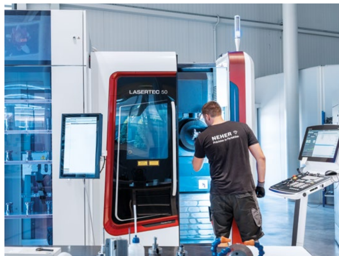
Pe un LASERTEC 20 PrecisionTool și un LASERTEC 50 PrecisionTool de la DMG MORI, muchiile de tăiere PCD și CVD beneficiază de „rectificarea” finală sub formă de finisare cu laser.
