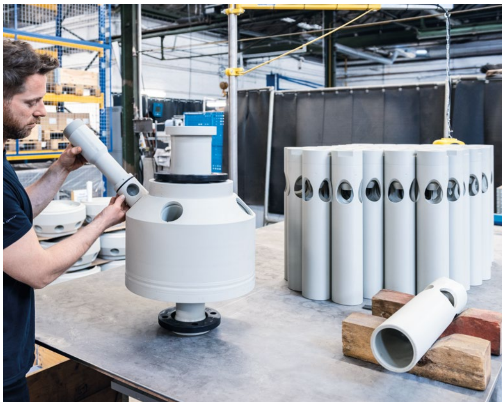
Ejectoarele Körting sunt finalizate în secția de montare.
