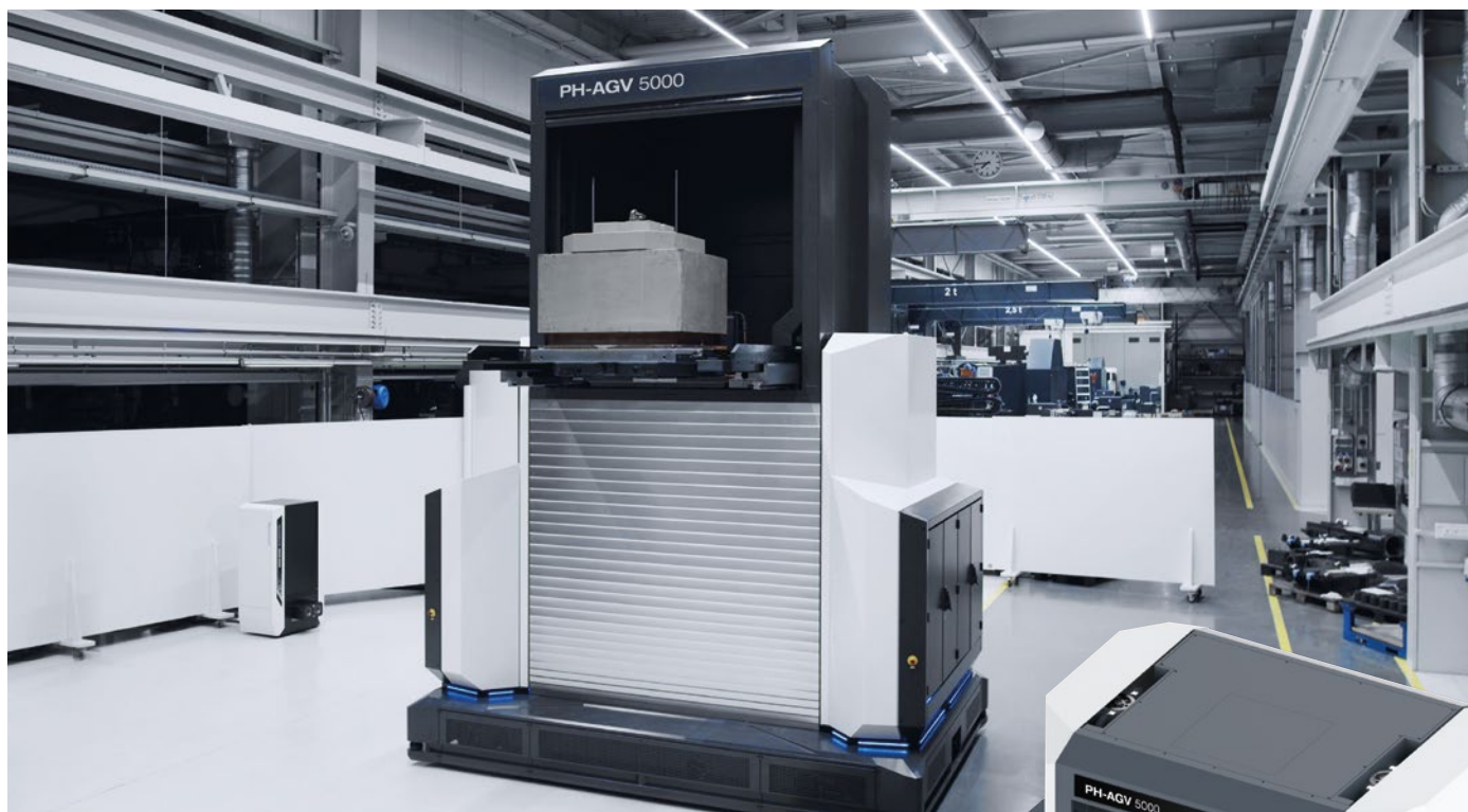
Cursă verticală mare de 2.010 mm până la raftul de palete din etajerele cu până la 3 m înălțime.
