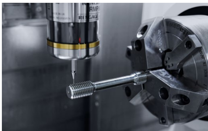
Dimensiunile filetului sunt măsurate în mașină cu ajutorul unui știft de palpare cu un diametru mic, cu \phi 1\text{mm} .
