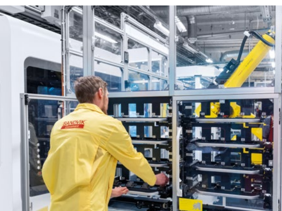
Schimbarea automată a sculei pentru turelă. Magazie de scule separată, cu spațiu pentru 32 de scule, integrată în MATRIS.
