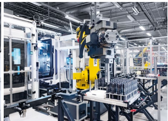
În celulă pot fi găzduite șase cărucioare cu corpuri de bază, astfel încât fabricația autonomă este posibilă și în timpul turelor de lucru de noapte fără personal.
