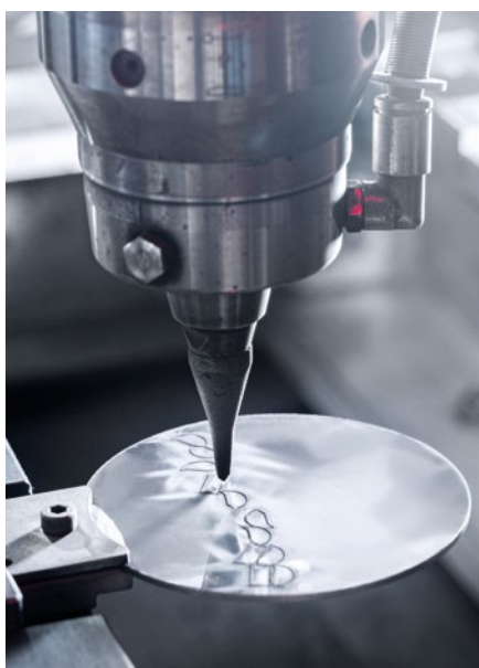
Elementele PCD și CVD ale sculelor sunt tăiate din semifabricate adecvate pe un LASERTEC 20 FineCutting.
