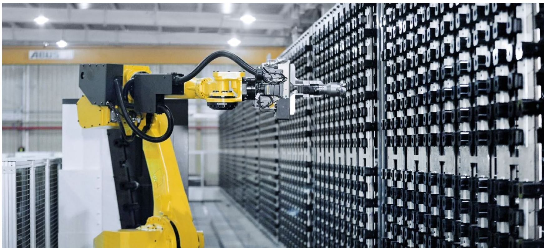
Magazia centrală de scule oferă spațiu pentru până la 4.000 de scule suplimentare. Sculele sunt echipate printr-o stație de încărcare (TSS) cu o capacitate maximă de 60 de scule, în care sculele sunt recunoscute de un cititor DMC și introduse și scoase automat din sistem, împreună cu datele.
