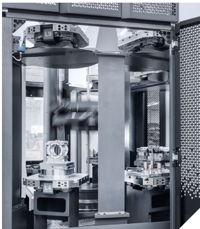
Grație modelului RPS 12 cu 12 paletă, DMC 65 H monoBLOCK este utilizat în mod optim timp de mai multe ore. Echiparea are loc în paralel cu timpul principal.
