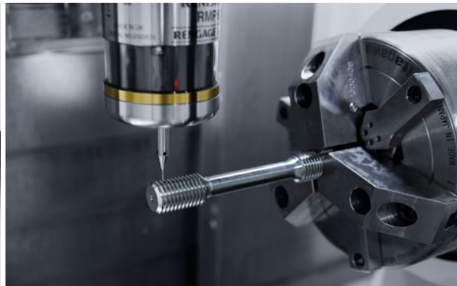
De schroefdraadmaat worden gemeten in de machine met behulp van een taster met een kleine diameter van \varnothing 1 mm.
