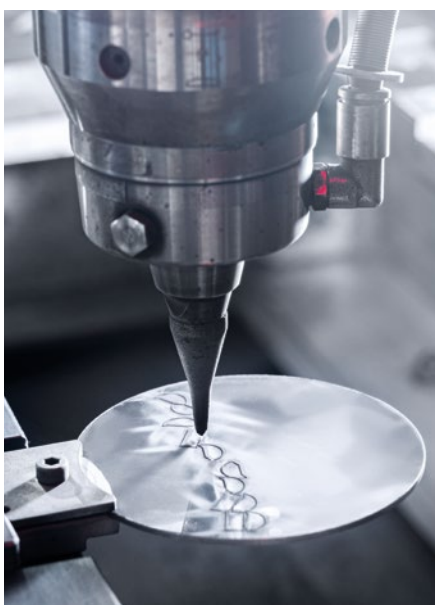
De PCD- en CVD-elementen van het gereedschap worden gesneden op een LASERTEC 20 FineCutting van de overeenkomstige vormstukken.
