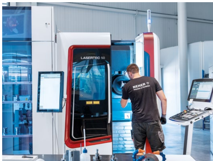
Op een LASERTEC 20 PrecisionTool en een LASERTEC 50 PrecisionTool van DMG MORI krijgen de PCD- en CVD-snikanten hun definitieve "slijpvorm" door laserafwerking.
