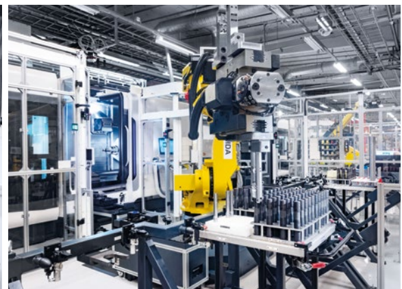
In de cel kunnen zes karren met basisvormen worden ondergebracht, zodat ook in de nacht toezichtloze productiecycli kunnen worden gedraaid.
