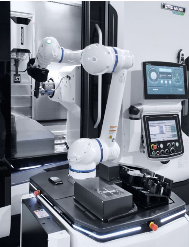
De WH-AGV 5* transporteert de werkstukken naar de twee NTX 1000's 2 nd Generation. De lengte van het werkstuk wordt automatisch gemeten op de werktuistafel.
