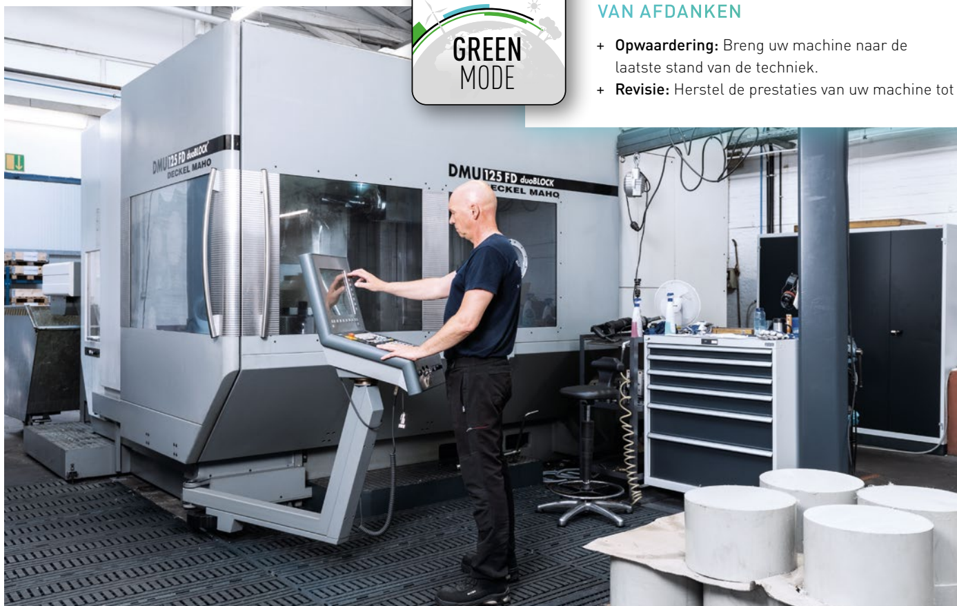
Met de revisie van een DMU 125 FD duoBLOCK door DMG MORI Used Machines heeft Körting het prestatievermogen van het frees-draaicentrum voor vele jaren verlengd.
