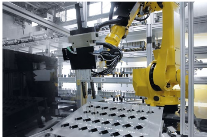
De koppeling met het palletmagazijn maakt autonome productie van een groot aantal werkstukken gedurende 24 uur mogelijk.
