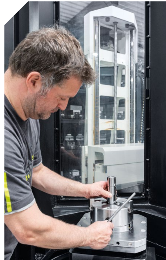
Het laadstation van de PH Cell 300 maakt het mogelijk om in te stellen gedurende de bewerking.
