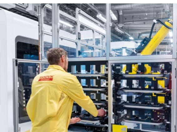
Automatische gereedschapswissel voor de revolver. Afzonderlijk gereedschapmagazijn met plaats voor 32 gereedschappen, geïntegreerd in MATRIS.
