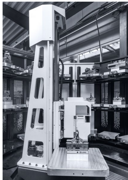
De PH Cell 300 heeft 19 palletplaatsen – 15 voor pallets tot 300 × 300 mm, vier voor pallets tot 400 × 400 mm.
