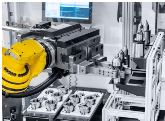
De robot in MATRIS laadt en lost de NTX 2000 met werkstukken en wisselt gereedschap in de revolver en de centreerpunten en klauwplaten.
