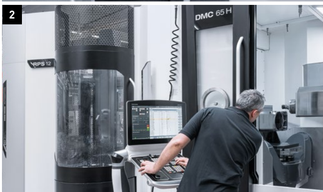
1. Bewerking van gietijzeren en RVS-onderdelen voor vacuümbehuizingen van pompen. 2. De open spananafvoer van het horizontale bewerkingsconcept maakt een procesbetrouwbare productie mogelijk.
