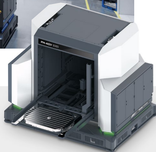
Nagy, 2.010 mm-es függőleges mozgási tartomány a paletták tárolásához akár 3 m magas állványokon.
