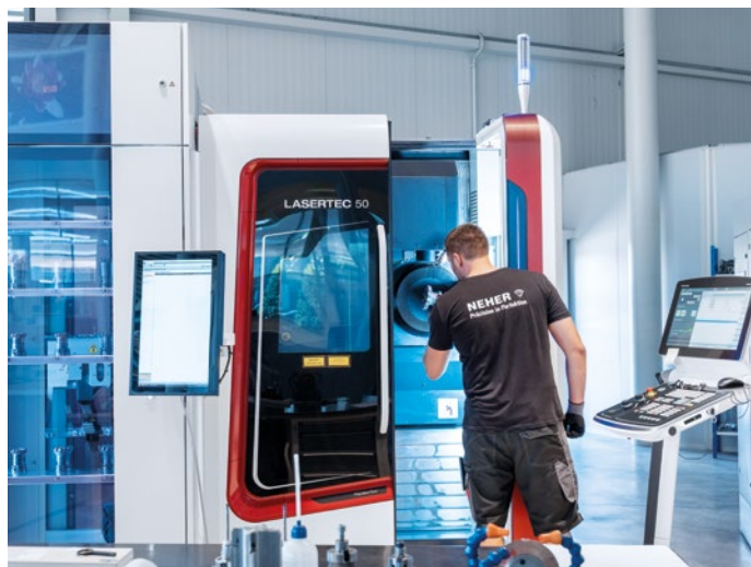
A PCD és a CVD forgácsolóeleket a DMG MORI LASERTEC 20 PrecisionTool és a LASERTEC 50 PrecisionTool lézeres „simítással” munkálják készre.
