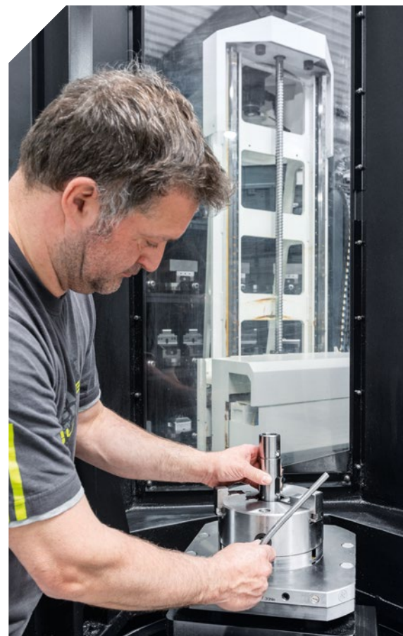
A PH Cell 300 beállító állomása lehetővé teszi a következő feladat előkészítését, amíg a gyártás halad.
