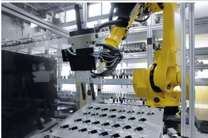
A palettás tárolórendszerhez való csatlakozás lehetővé teszi nagyszámú munkadarab 24 órán keresztül történő, személyzet nélküli gyártását.
