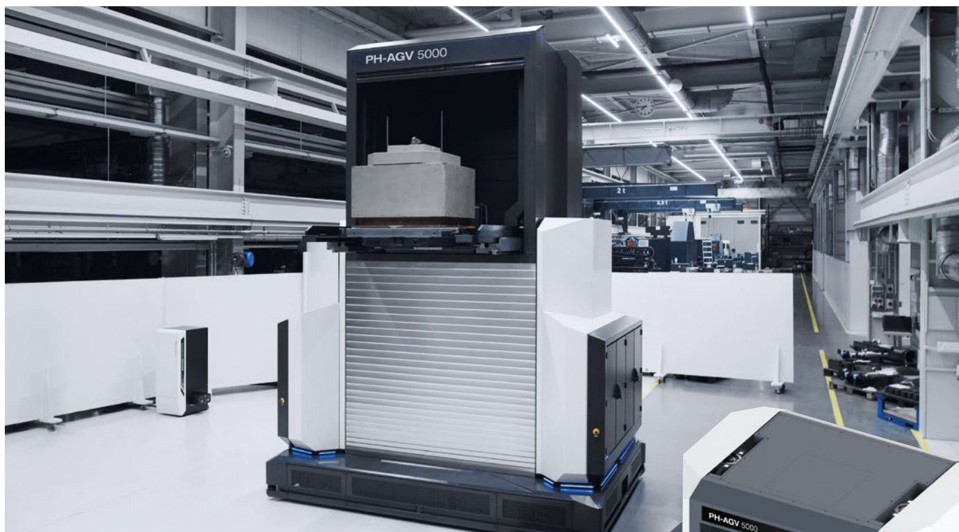
Nagy, 2.010 mm-es függőleges mozgási tartomány a paletták tárolásához akár 3 m magas állványokon.
