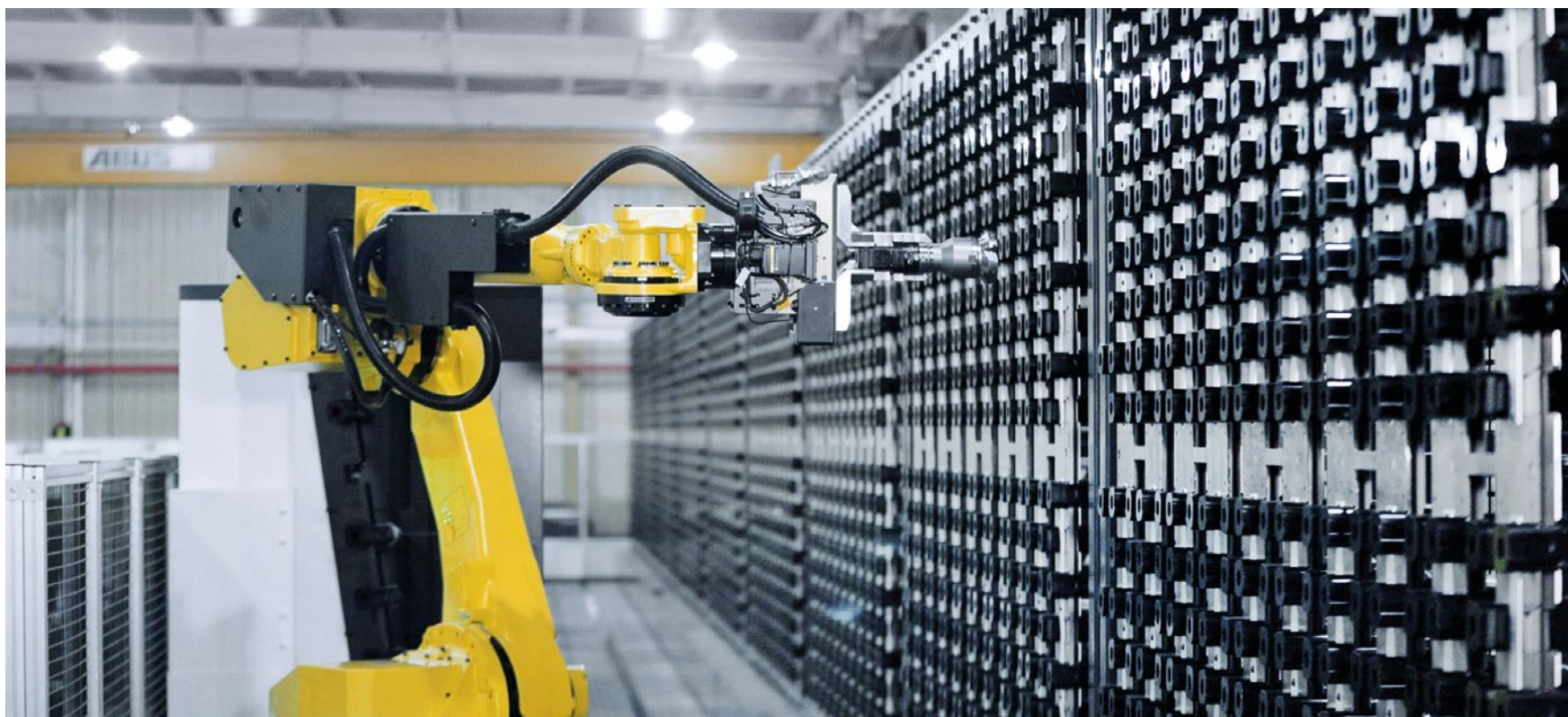
A központi szerszámtároló rendszer további 4.000 szerszámnak biztosít helyet. A szerszámok beszerelését egy szerszám beállító állomáson (TSS) végezzük, amely 60 férőhellyel rendelkezik. Itt a szerszámokat egy vonalkódolvasóval azonosítja a rendszert, a be- és kiszerelés teljesen automatikusan zajlik.
