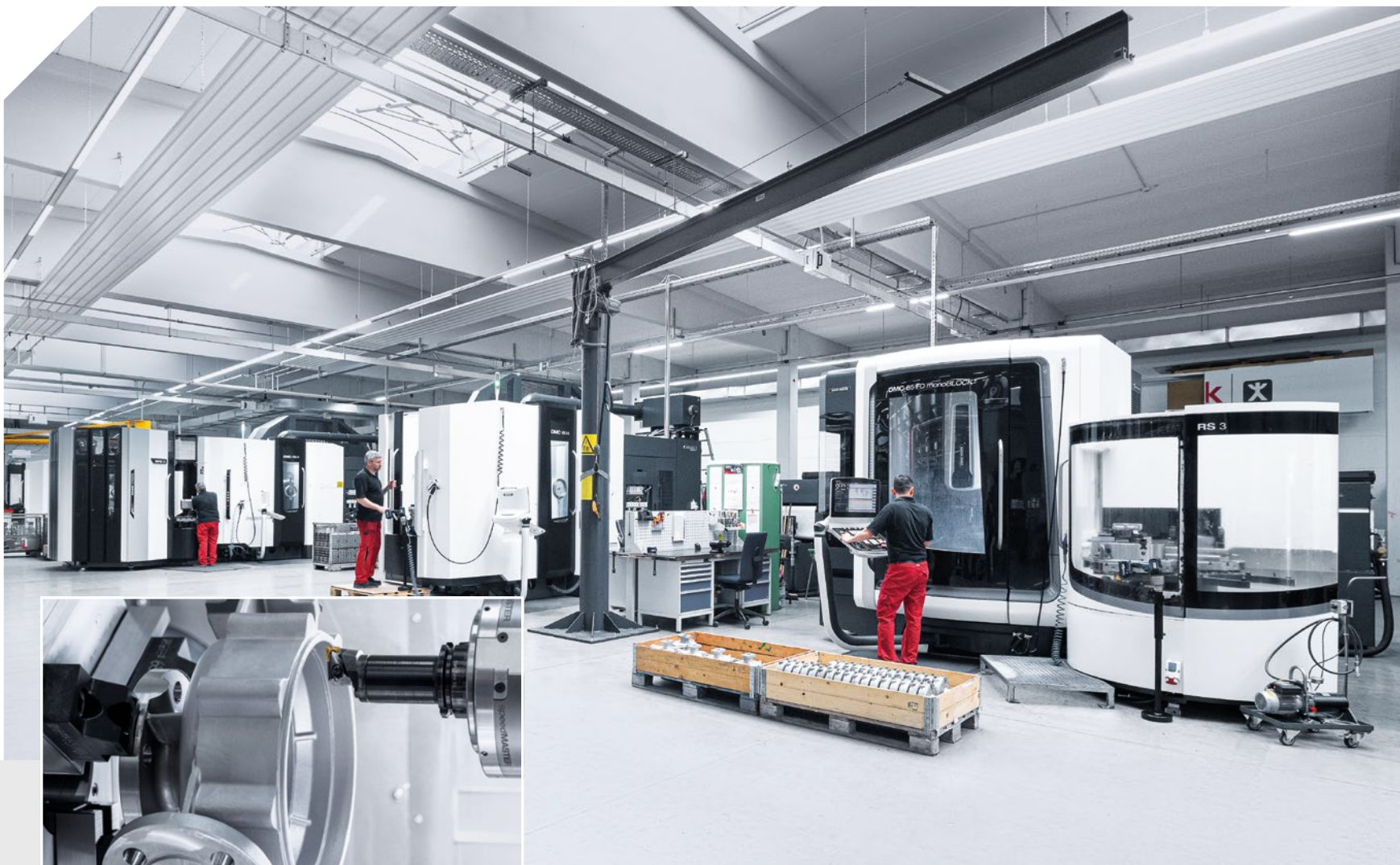
A SPECK Pumpen 75 gépet használ a nagy pontosságú szivattyúalkatrészek gyártásához a Rothban található telephelyén. Ezek közé tartozik egy DMC 65 FD monoBLOCK, az új DMC 65 FD H monoBLOCK és egy DMC 65 H monoBLOCK RPS 12 forgó palettátároló rendszerrel.
