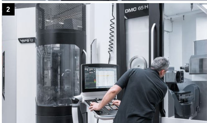
1. Szürkeöntvényből és korrózióálló acélból készült alkatrészek megmunkálása vákuumszivattyúk házához. 2. A vízszintes főorsójú szerszámgépeken a forgácselvezetés a gravitáció segítségével megbízható gyártást tesz lehetővé.
