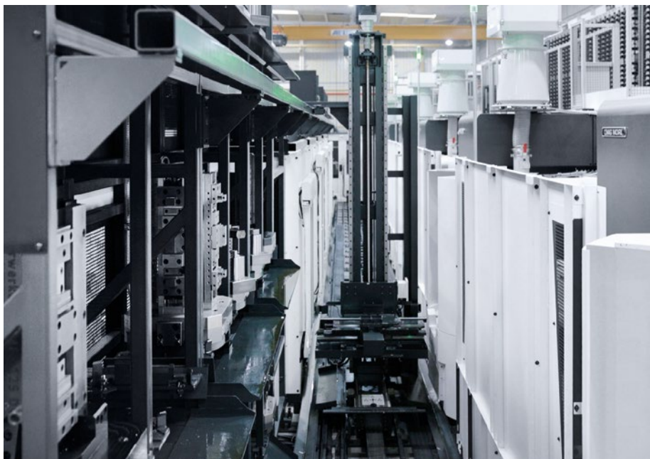
A 48 állású LPP rendszer cserélőkarja.
