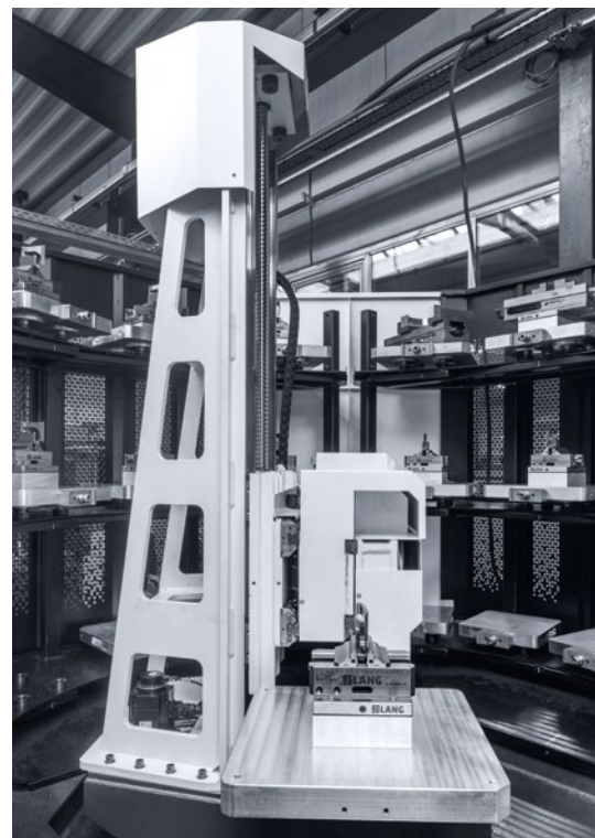
A PH Cell 300 egy 19 paletta tárolására alkalmas polcrendszerrel van felszerelve, – 15 helyre 300 × 300 mm méretű palettákat, a fennmaradó 4 helyre 400 × 400 mm méretű palettákat lehet tenni.
