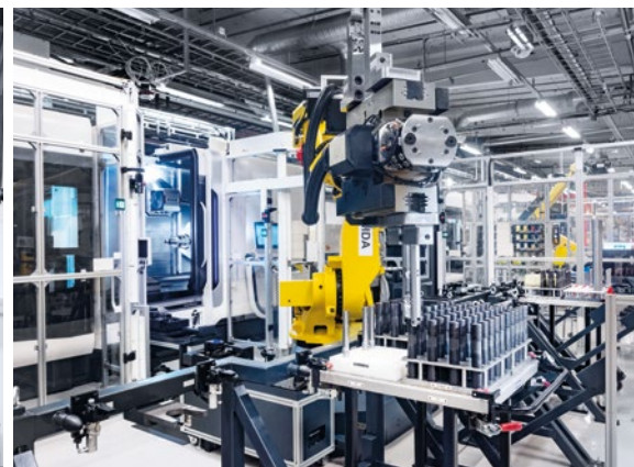
A cellában hat kocsit lehet elhelyezni alaptestekkel megrakva, ezzel önálló gyártást lehet végezni gépkezelő nélküli, éjszakai műszakokban.
