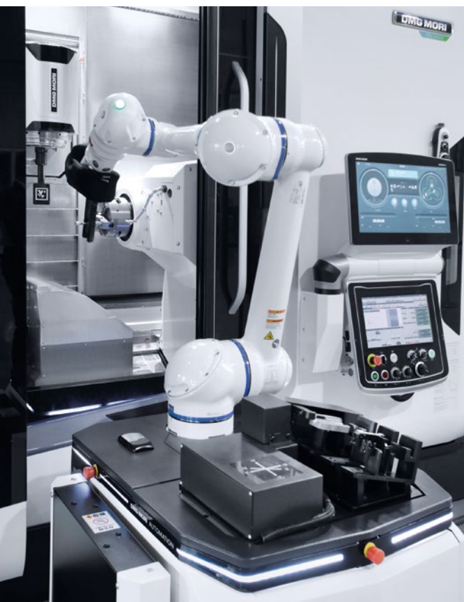
A WH-AGV 5* a munkadarabokat a két NTX 1000 szerzőszámigépre szállítja. A munkadarab hossza automatikusan mérésre kerül a munkadarab-tálcán.
