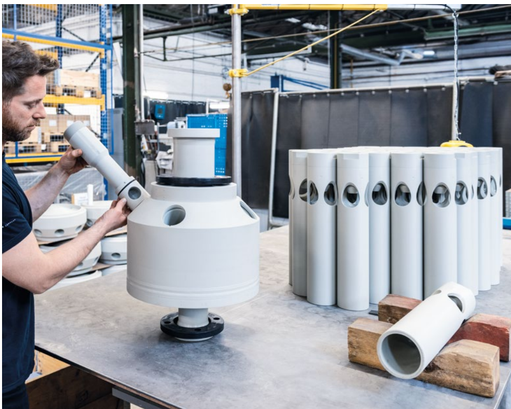
A Körting ejektorok szerelés közben.
