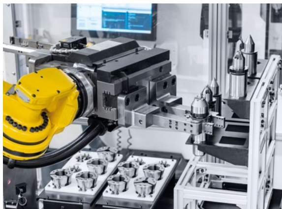
A MATRIS robotja végzi a munkadarabok be- és kisserelését, a szerszámcserét a revolverfejben, valamint a csúcsok és megfogópatronok cseréjét egyaránt az NTX 2000-ban.
