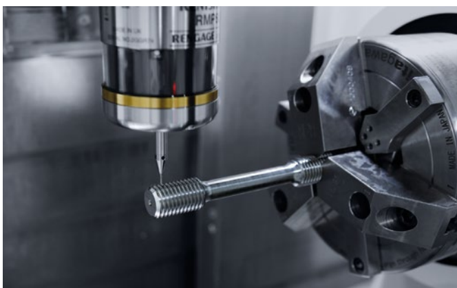
A menetek mérése a gépen egy Ø1mm-es tapintóval történik.
