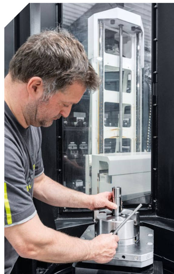
PH Cell 300's klargøringsområde muliggør klargøring under driften.
