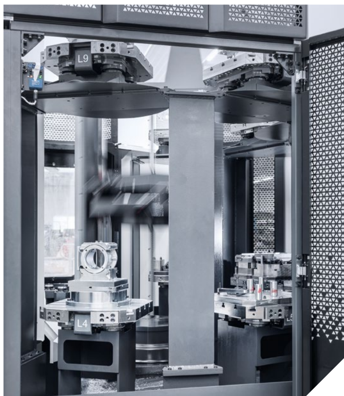
Takket være en RPS 12 med 12 paller udnyttes DMC 65 H monoBLOCK optimalt over flere timer. Opsætningen foretages under driften.
