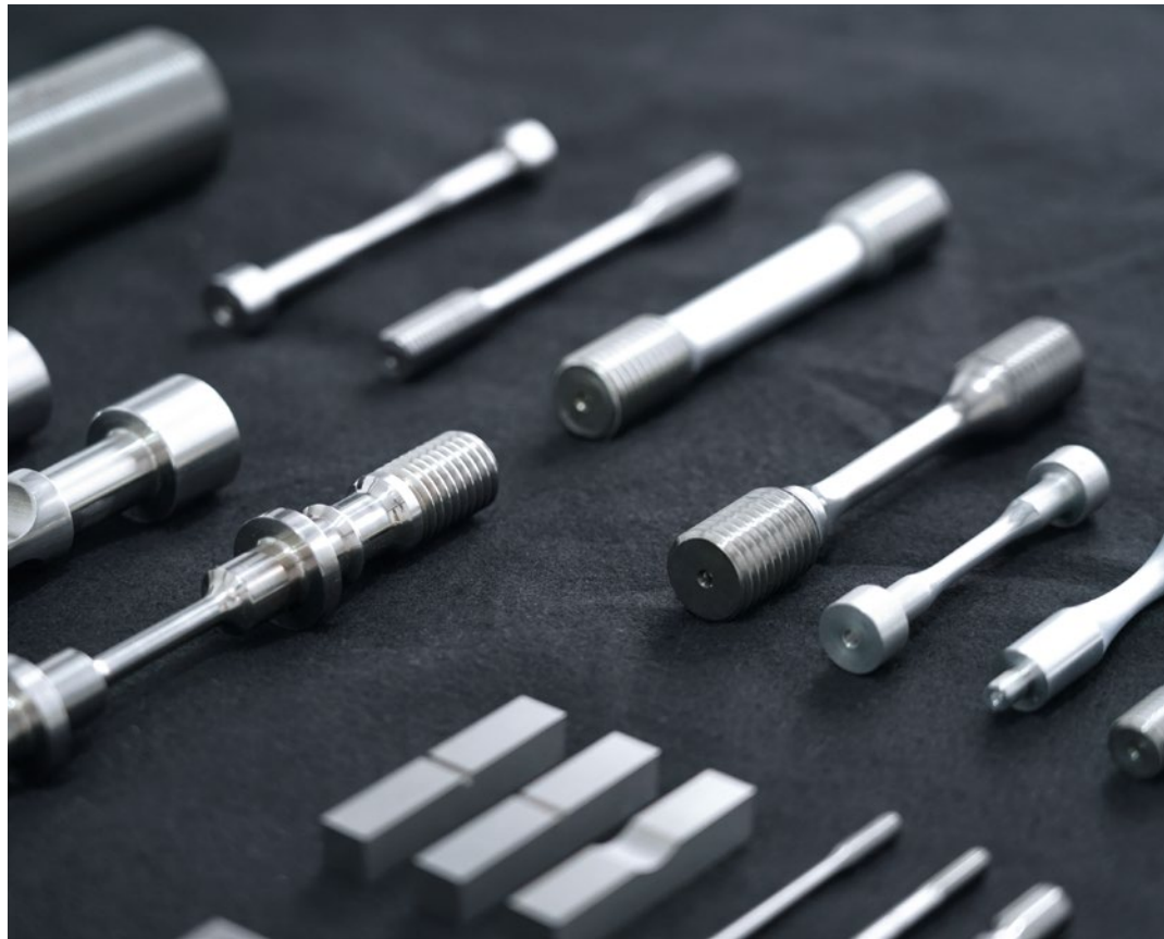
På de to NTX 1000 2 nd Generation bearbejder KIGUCHI TECHNICS cirka 50 forskellige materialetyper og 200 varianter af prøveemner.
