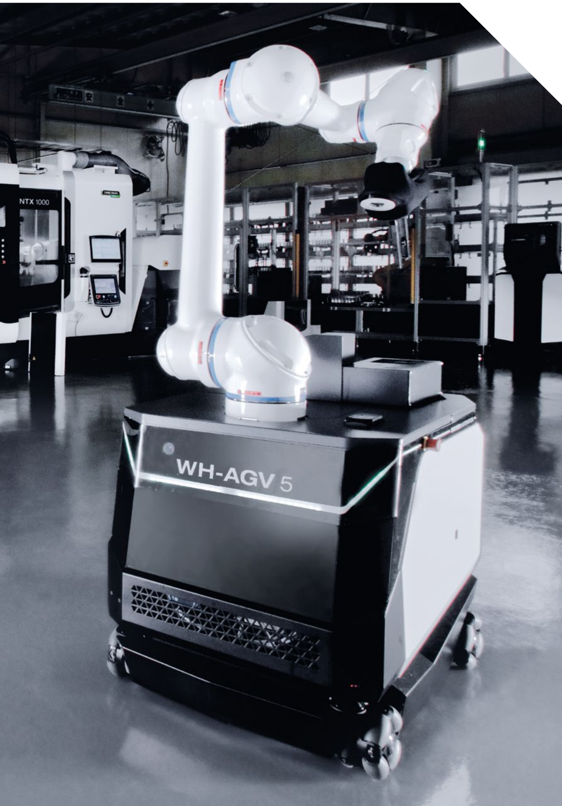
WH-AGV 5* kræver ikke skinner og kan undvige mennesker og forhindringer automatisk.
