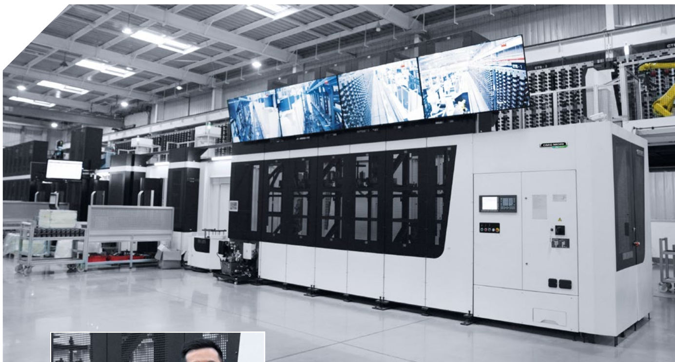
Automatiseringsløsning med 4.000 værktøjs- og 48 pallepladser. Inklusive styrecomputer til den integrerede styring af maskiner, pakker og værktøjsautomatisering.
