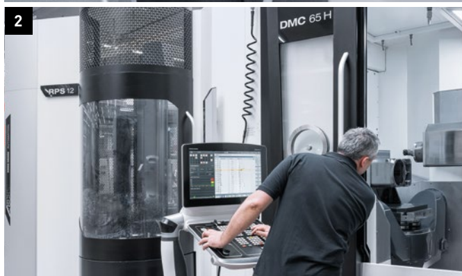
1. Bearbejdning af støbejernskomponenter og komponenter støbt i rustfrit stål til pumpernes vakuumhuse. 2. Det horisontale maskinkoncepts frie spånfald muliggør en processikker produktion.
