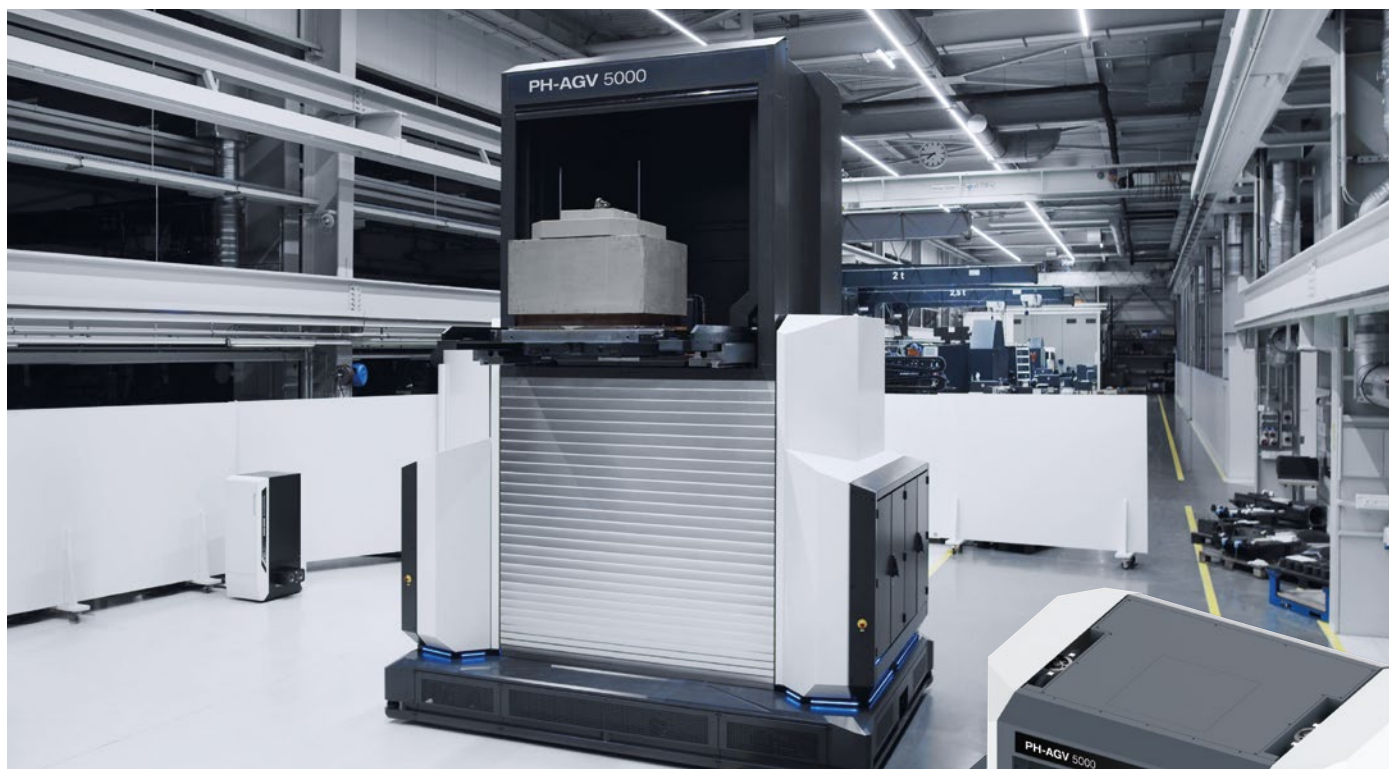
Stor lodret vandring på 2.010 mm til palleopbevaringen i reoler på op til 3 m i højden.
