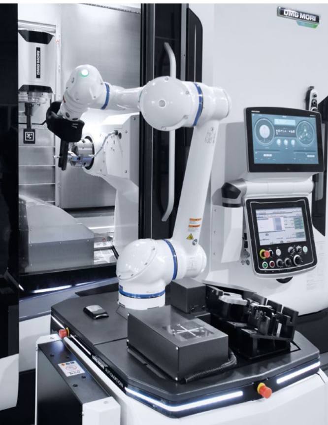
WH-AGV 5* transporterer emner hen til de to NTX 1000 2 nd Generation. Emnernes længde måles automatisk på emnehylden.
