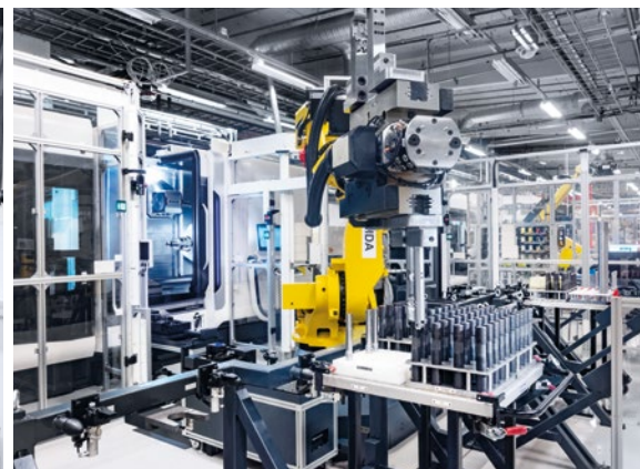
Der er plads til seks vogne med hoveddele i cellen, så der også er mulighed for en autonom produktion på de ubemandede nathold.
