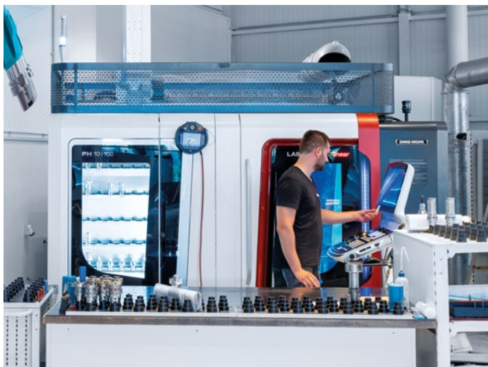
LASERTEC PrecisionTool-maskinerne arbejder automatiseret i ubemandede natthold, f. eks. med et PH 10-håndteringssystem til 54 HSK-værktøjer på LASERTEC 20 PrecisionTool.
