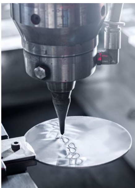
Værktøjernes PKD- og CVD-elementer skæres ud af råemnerne på en LASERTEC 20 FineCutting-maskine.
