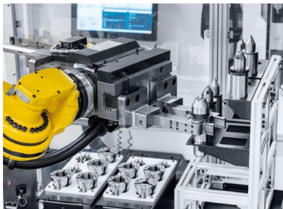
Robotten i MATRIS fylder og tømmer NTX 2000 for emner og skifter værktøjer i revolveren samt centreringspidser og spændepatroner.
