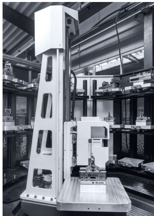
PH Cell 300 råder over 19 pallepladser – 15 til paller på op til 300 × 300 mm, fire til paller på op til 400 × 400 mm.
