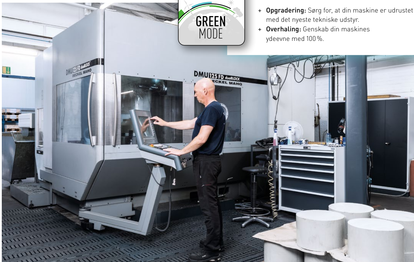
Gennem istsandsættelsen af en DMU 125 FD duoBLOCK hos DMG MORI Used kunne Körting forlænge sit dreje-/fræsecenters ydeevne med mange år.
