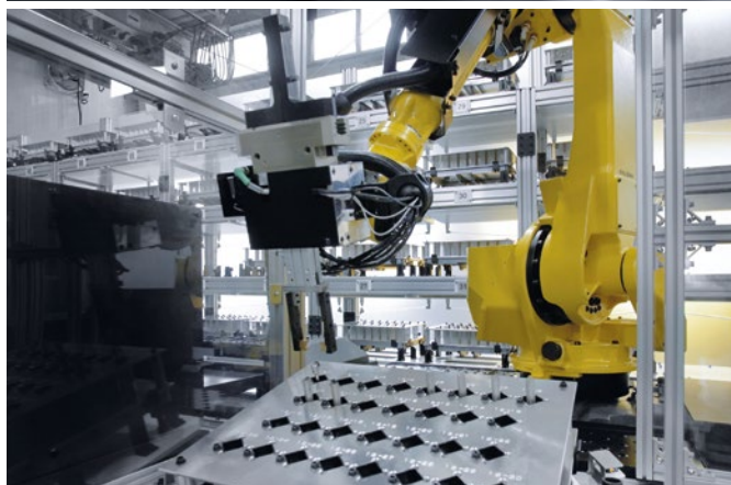
Tilslutningen til pallelageret muliggør en ubemandet produktion af et stort antal emner 24 timer i døgnet.
