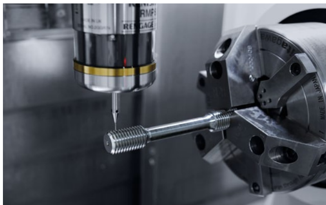
Størrelsen på gevindet måles i maskinen vha. en stylus med en lille diameter på \varnothing 1\text{mm} .
