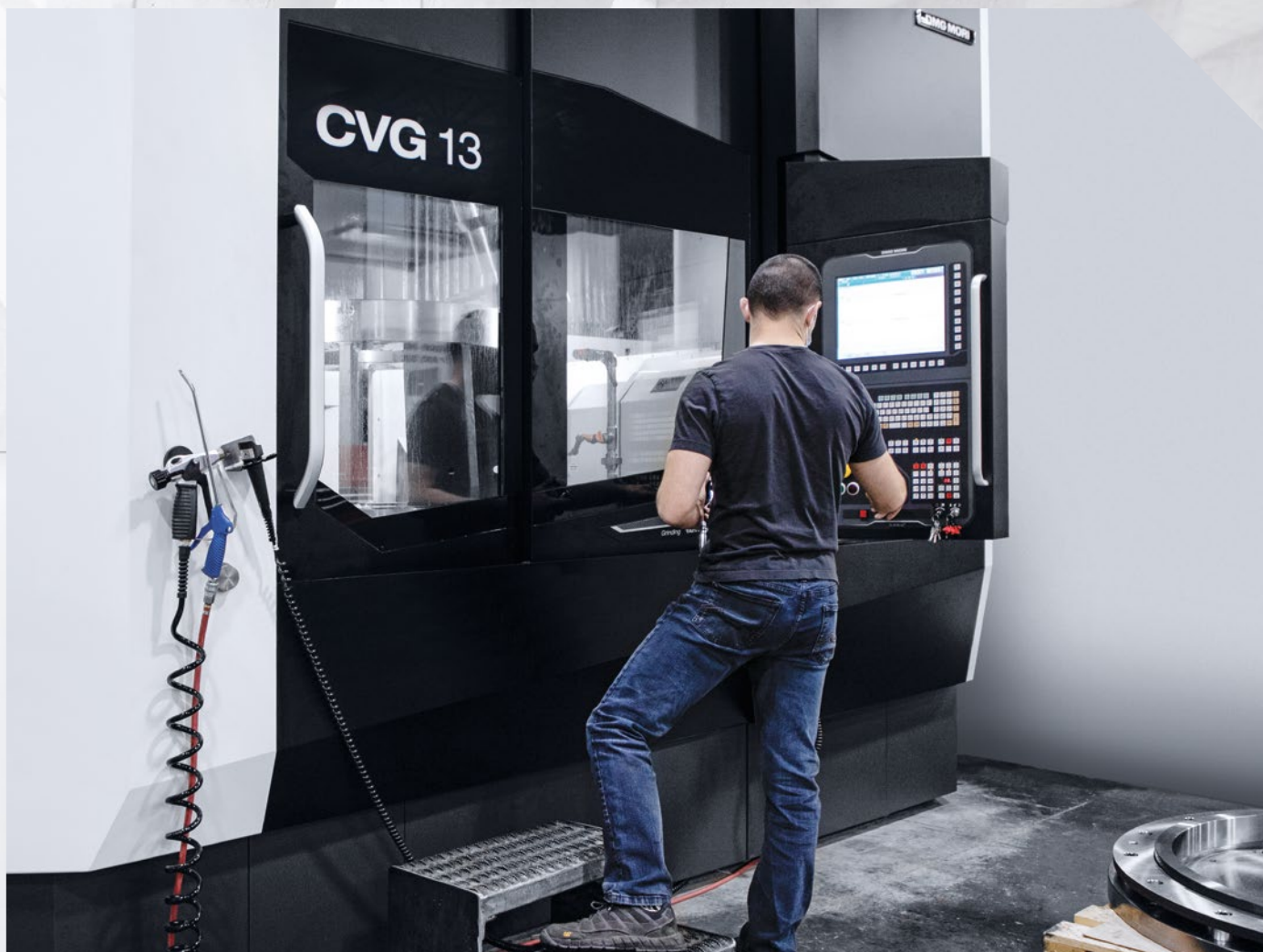
För slutbearbetningen använder NAMCO t. ex. en CVG 13. Här slipas stora komponenter med en diameter på upp till 1300 mm.
