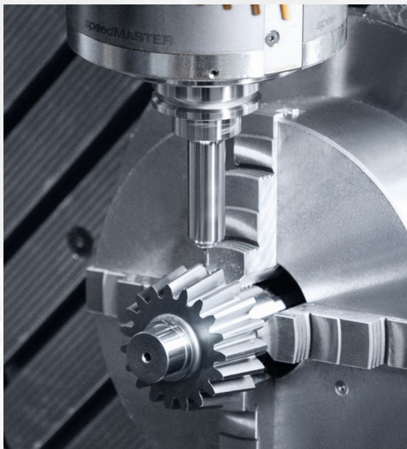
För mindre specialkugghjul använder NAMCO en DMU 65 monoBLOCK som är automatiserad med en PH 150.
