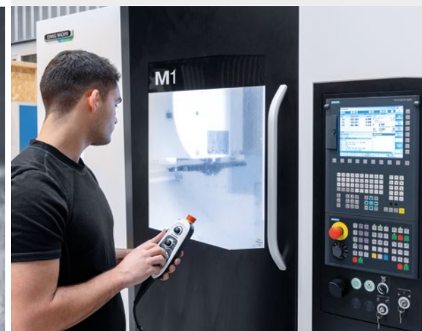
Az M1 nagyon merev és hőstabil gépágyának és a nagy teljesítményű, 12.000 fordulat/perc fordulatszámú orsónak a kombinációja ideális a HALI tex rendszeremlék gyártásához.
