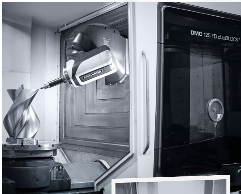
A DMC 125 FD duoBLOCK gépen a NAMCO a DMG MORI gearMILL szoftverével programozott fogaskereket, valamint más összetett munkadarabokat gyárt.
