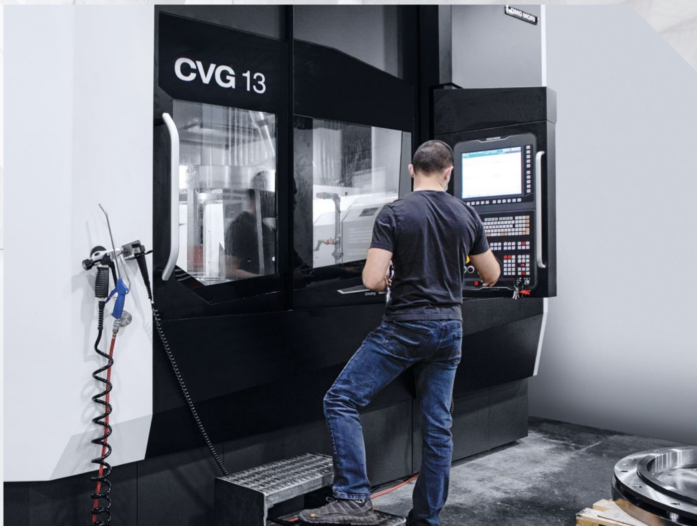
A NAMCO a simítási műveletekhez többek között egy CVG 13-as szerszámgépet használ. A nagyméretű, akár 1.300 mm átmérőjű alkatrészek köszörülése.
