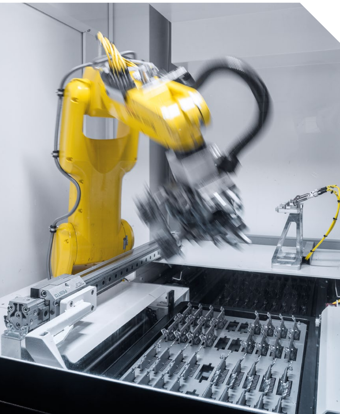
A DMP 70-et kiszolgáló WH 3 munkadarab-tároló akár 600 darabnak is helyet biztosít, ami akár 15 órás felügyelet nélküli gyártást tesz lehetővé.
