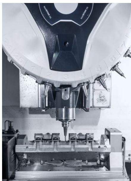
A befogó szerszámat kifejezetten a folyamathoz tervezték, és négy munkadarab számára van hely.
