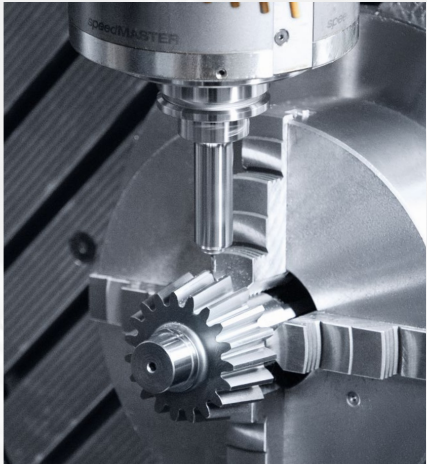
Til mindre specialtandhjul anvender NAMCO bl.a. en DMU 65 monoBLOCK, som er automatiseret med en PH 150.
