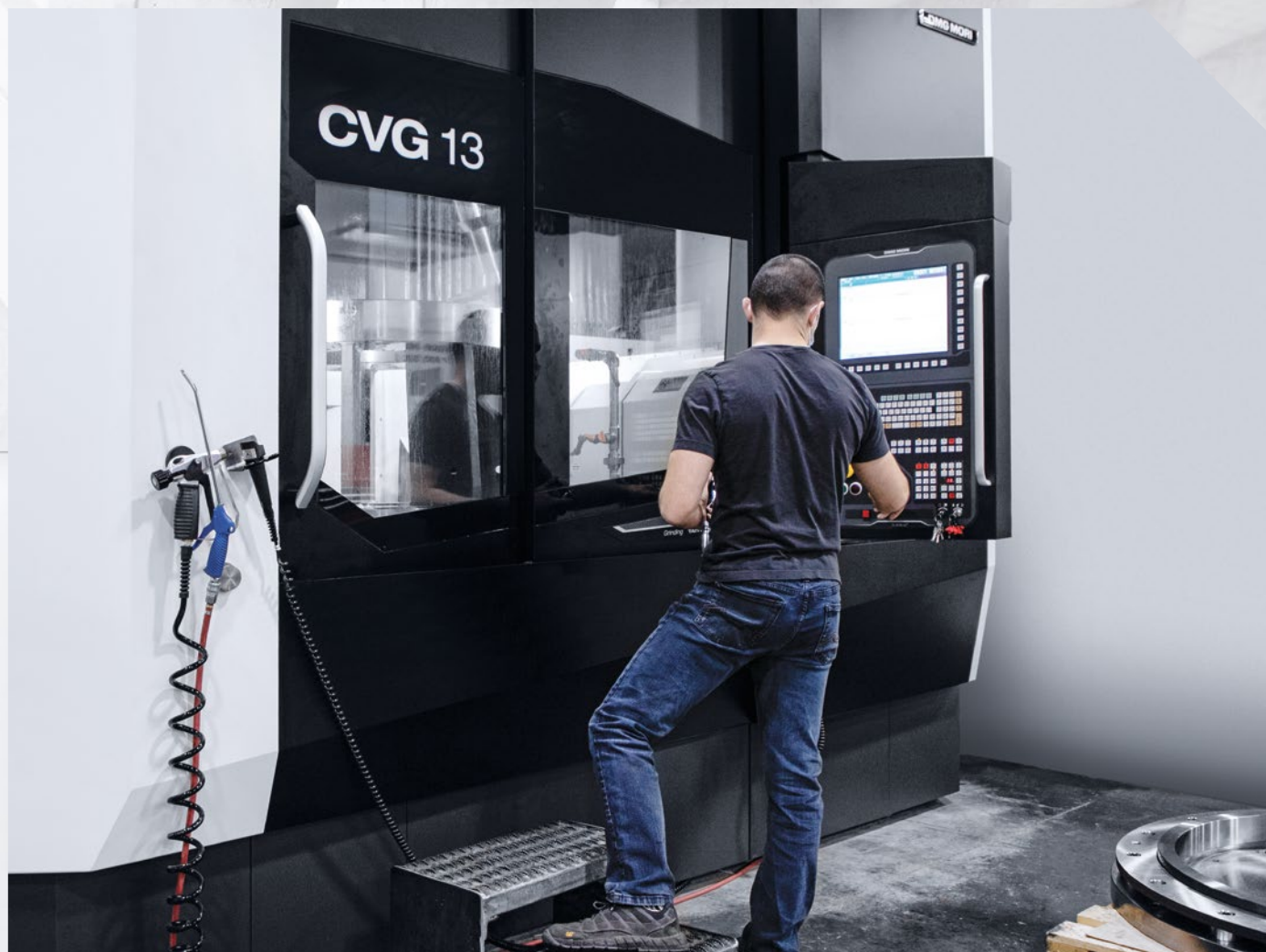
Til finish-bearbejdning anvender NAMCO bl. a. en CVG 13. Her slibes store komponenter med en diameter på op til \varnothing 1.300 mm.
