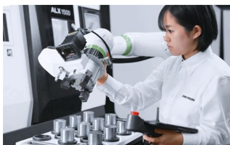
Direkte teach-in ved at robotten bevæges
