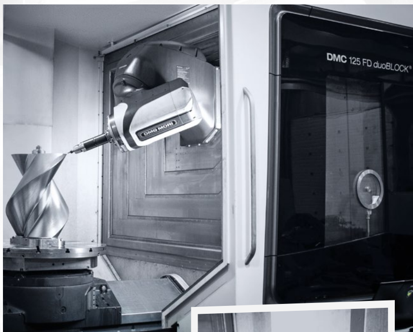
På DMC 125 FD duoBLOCK fremstiller NAMCO tandhjul, der programmeres vha. DMG MORI's software gearMILL, samt andre komplekse emner.
