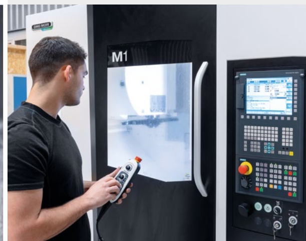
Den meget stive og varmestabile maskinseng til M1 er, sammen med den højtydende 12.000'er spindel, det optimale grundlag for fremstillingen af anlægskomponenter hos HALI tex.
