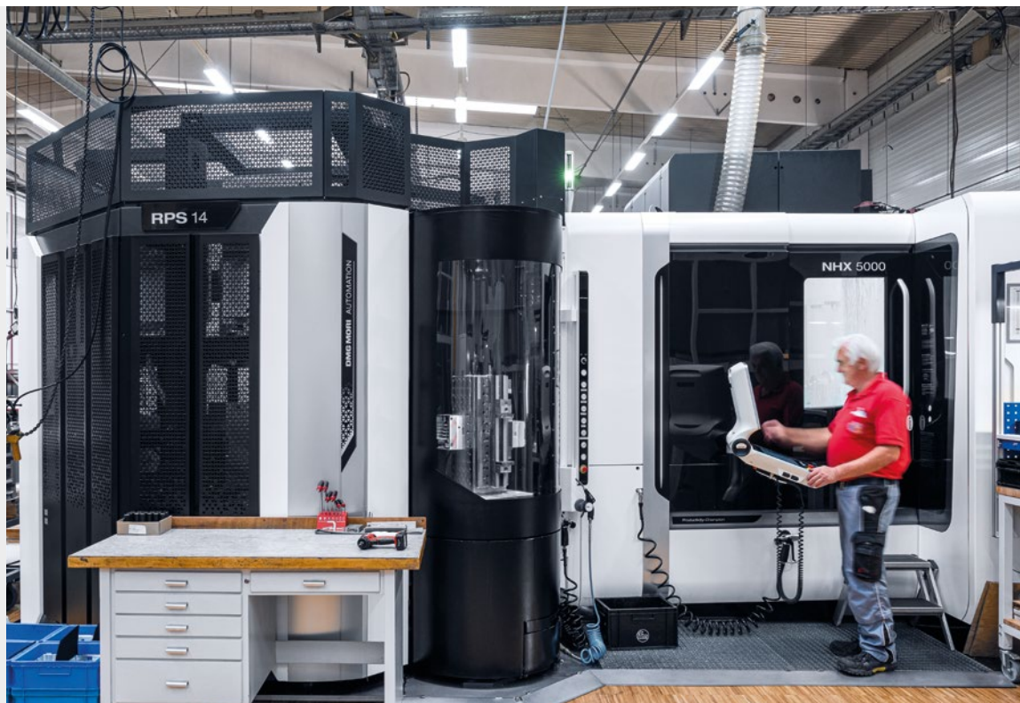
Heppler anvender tre NHX 5000, som hver er automatiseret med et RPS 14 rundlager til den automatiserede produktion af hydraulikkomponenter i rustfrit stål.
