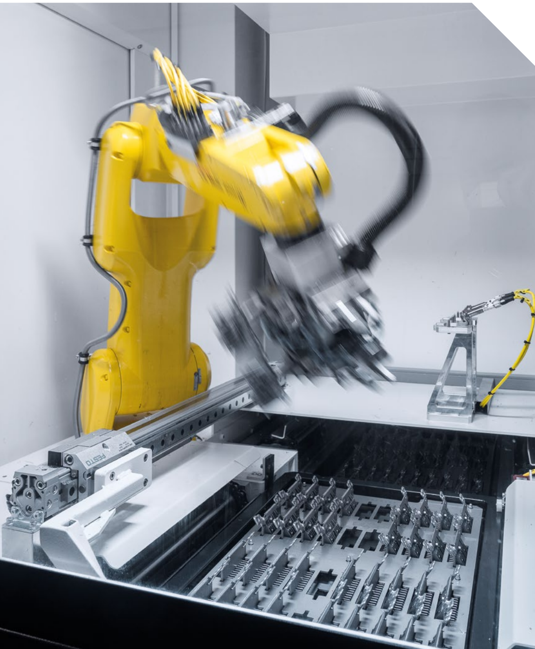
WH 3's emnemagasin på DMP 70 giver plads til op til 600 emner og muliggør dermed ubemandet drift i op til 15 timer.
