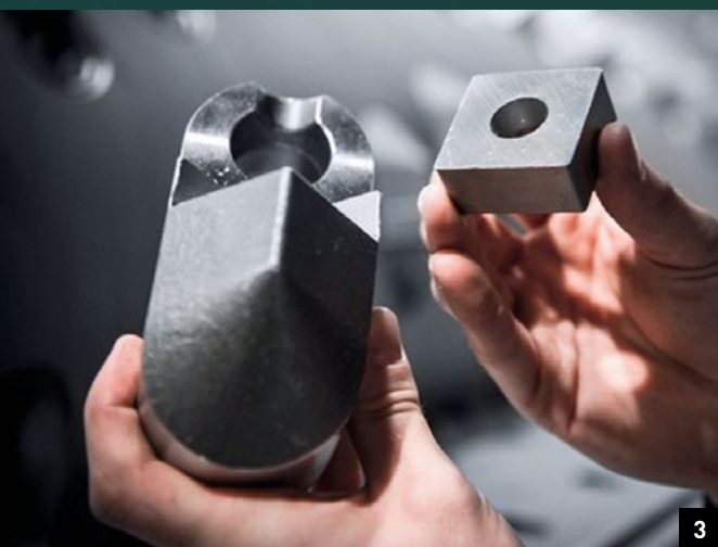
3. Mono-Fix-holder og knivindsats til en Micromat shredder.
