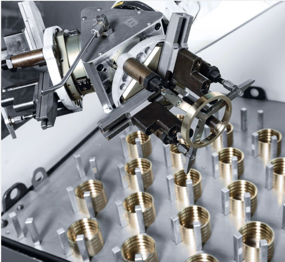
Stabelmagasinet i Robo2Go har tilstrækkeligt plads til, at der kan produceres døgnet rundt på CTX beta 800 TC.
