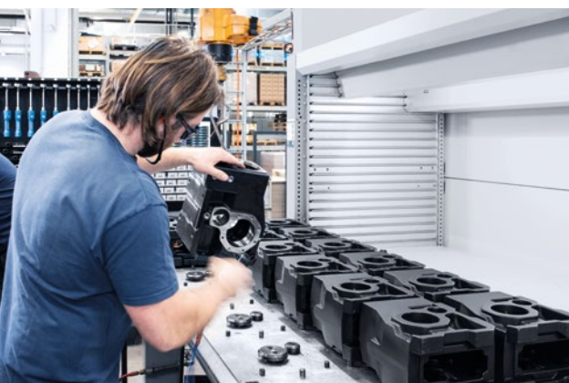
A gyártócella betöltése automatán történik egy automatizált kisalkatrész tároló segítségével. A forgácsolt alkatrészek tárolása itt történik.
