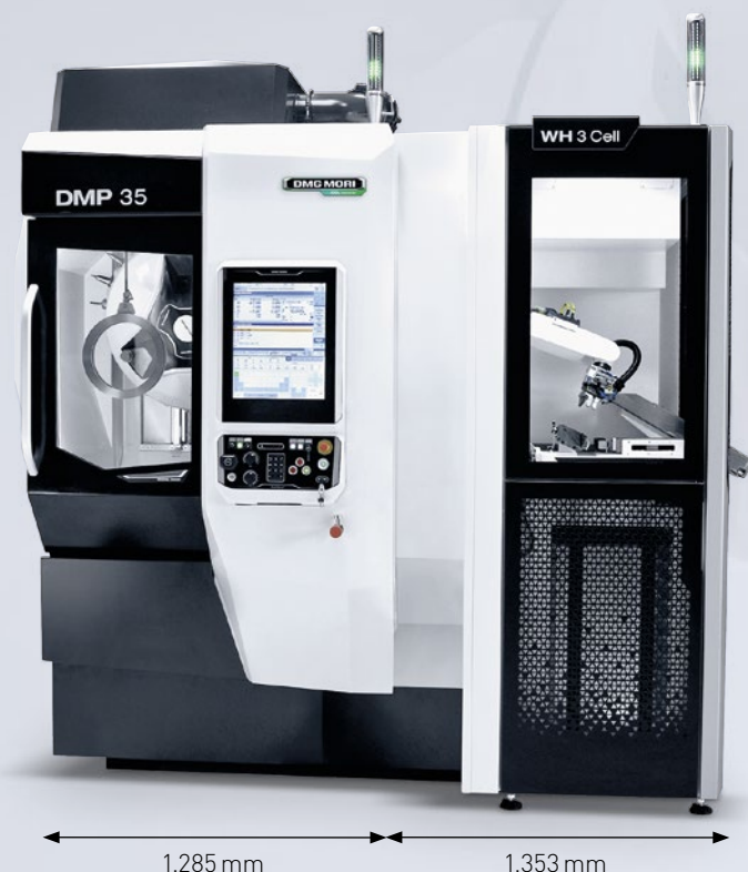
Mozgástartomány (X/Y/Z): 350 / 420 / 380 mm
