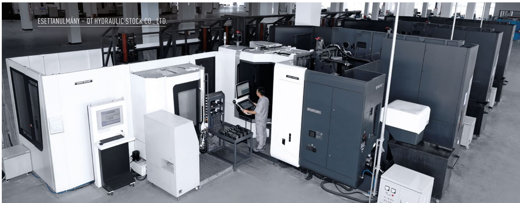
A QT Hydraulic gyártási megoldása három NHX 5500-as gépből áll, amelyeket 28 darabos lineáris palettarendszerrel és egy beállító állomással automatizáltak.
