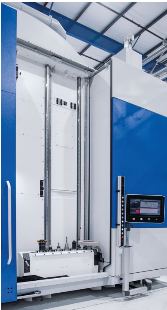
A TH-AGV-vel akár 8 szett szerszámot lehetséges teljesen automatán cserélni a szerszám betöltő állomás segítségével.
