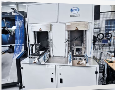
3. A tisztító állomás két cellából áll, egy-egy mindkét DMC 80 H duoBLOCK szerszámgéphez, amelyekhez egy program van hozzárendelve a DMG MORI cellavezérlőjében.
