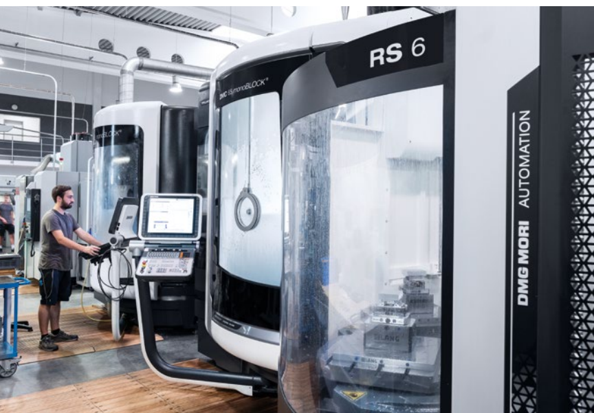
A két DMU 65 monoBLOCK RPS6-tal erőssége különösen előnyös a kis méretű, nagy pontosságú alkatrészek sorozatgyártásában.
