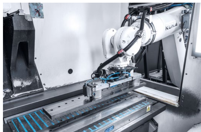
A robottal támogatott betöltés a CMX 1100 V-n oldalról történik.
