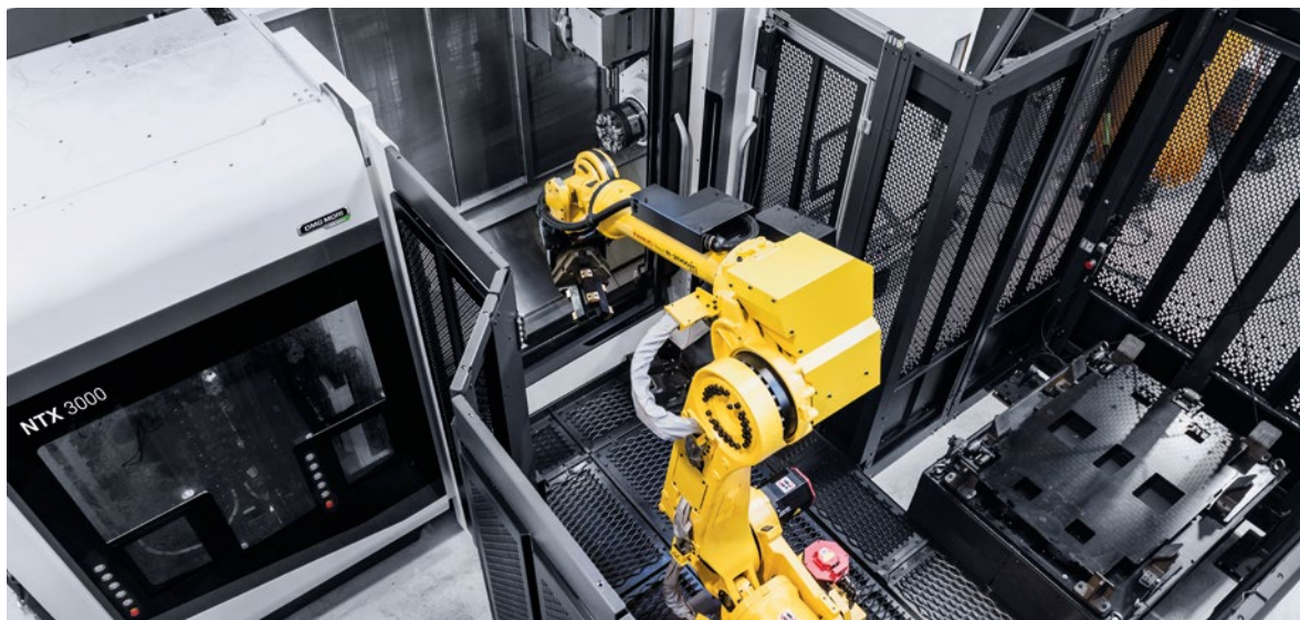
A Robo2Go-nak és a MATRIS-nak köszönhetően a két NTX 3000 sok órán keresztül képes önállóan működni.
