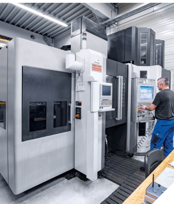
Loll Feinmechanik使用三部5軸加工中心NMV 3000, 每個加工中心都配備一個34站AWC 34托盤自動交換單元, 適用於一次性小批量的靈活生產。
