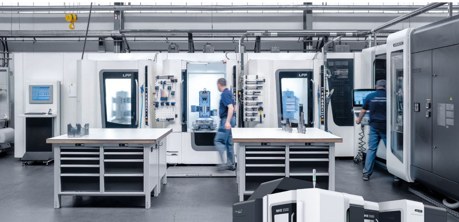
擴建後，位於Burghardt Zerspanung的LPP現在配備了兩部NHX 5000機台、一部NHX 5500和40個托盤站。自動化由系統上或辦公室中的MCC-LPS單元控制器作控制。
