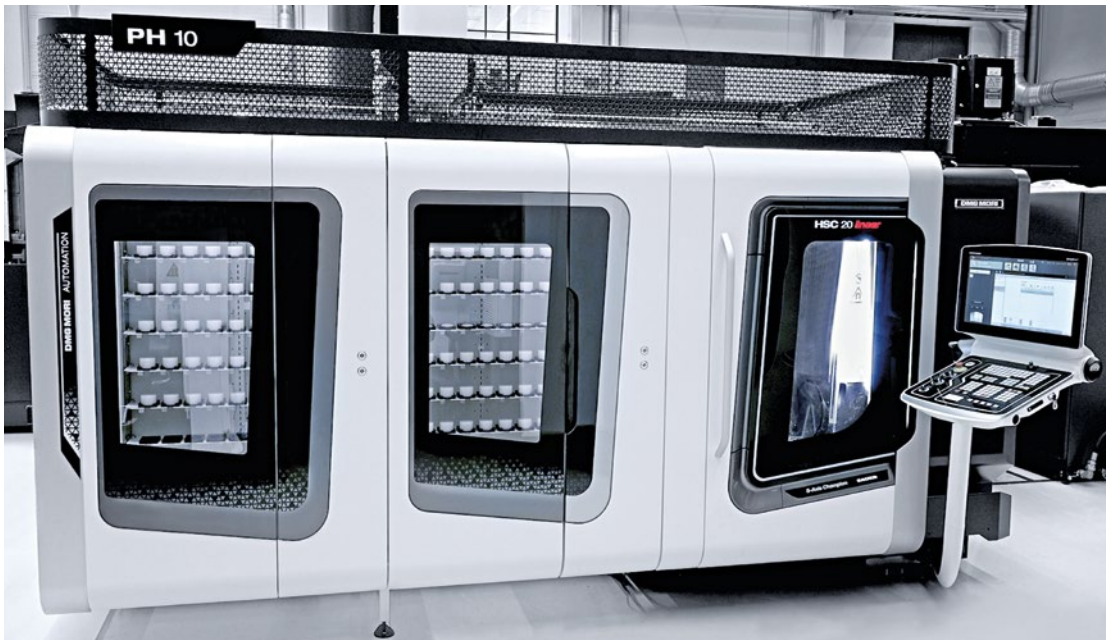
配備有PH 10雙料倉的HSC 20 linear ，作為工件自動交換系統
