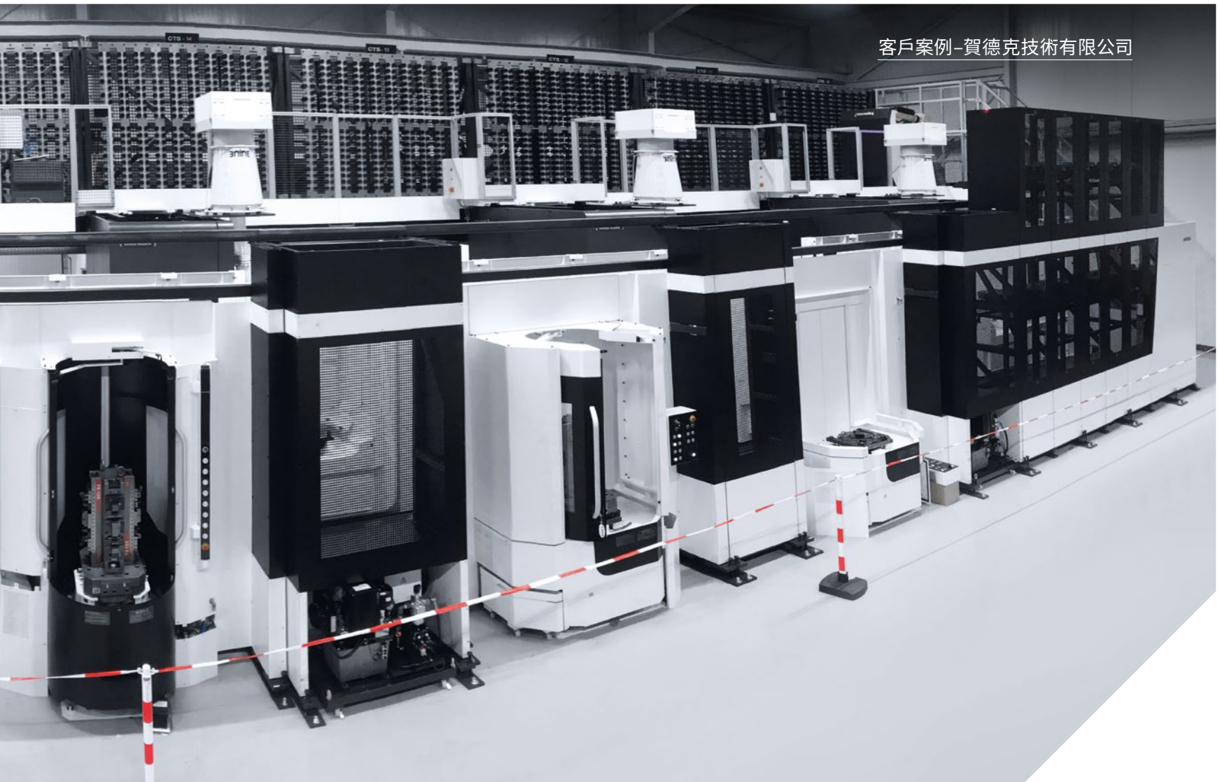
六部NHX 4000可存放48個托盤，形成了一個寬度超過33m的自動化系統。系統中還整合了一個配備有高達4,000個刀位的刀具庫。
