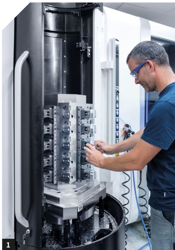
1. 臥式加工中心可使用四面或六面治具塔進行工件夾持。這使Hamilton大幅減少了設定時間。 2. 為了對生產過程作進一步最佳化,使用一半的治具塔裝載正面加工的零件,而另一半則裝載背面加工的零件。
