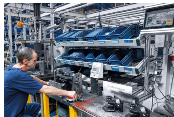
測試站會在組裝過程中確定扭矩，並將資料記錄在TULIP應用程式中，以供後續分析。
