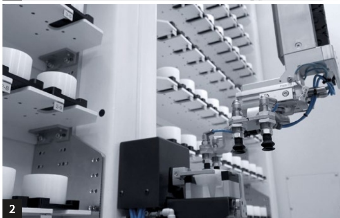
1. + 2. PH 10版作為工件自動交換系統,可處理多達126個原始零件和脛骨組件成品。
