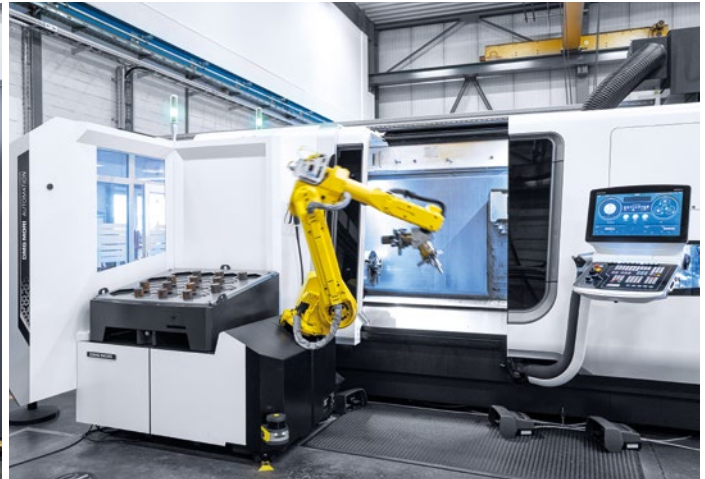
在CTX beta 1250 TC上進行的自動六面完全加工可將工件的加工時間縮短到1.5小時，最多可縮短80%。
