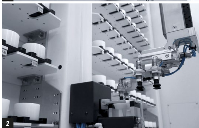
1.+2. Munkadarab kezelő rendszerként alkalmazott PH 10 akár 126 nyersalkatrészhez vagy kész sípcsont komponenshez.
