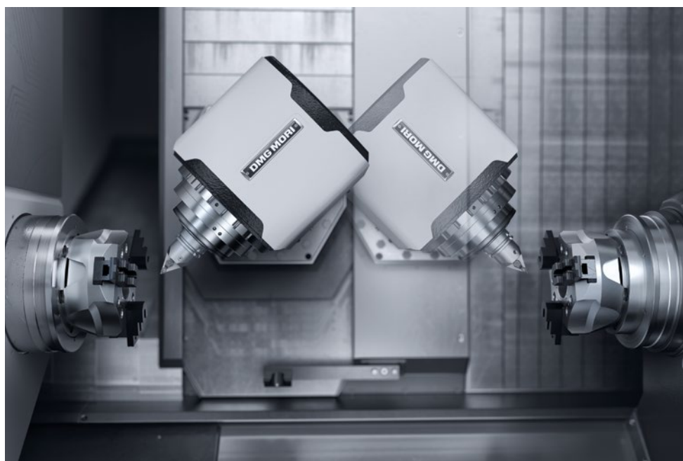
Egy szerszám a fő- és ellenorsóhoz egyaránt // 6-oldalas teljes megmunkálás.
