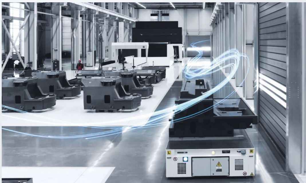
Az automatizáció és digitalizáció a FAMOT digitális gyárának alapelemei. A nagyméretű gépelemeket két különleges DMU 1000 szerszámgépen gyártják. A szállítást a legkorszerűbb autonóm járművek (AGV) végzik.
