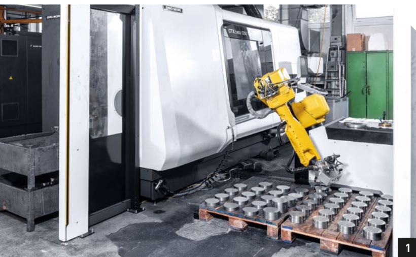
1.+ 2. A Robo2Go Vision kamerája felismeri a munkadarabokat. Így az alkatrészek fel- és lepakolhatók a standard palettákról
