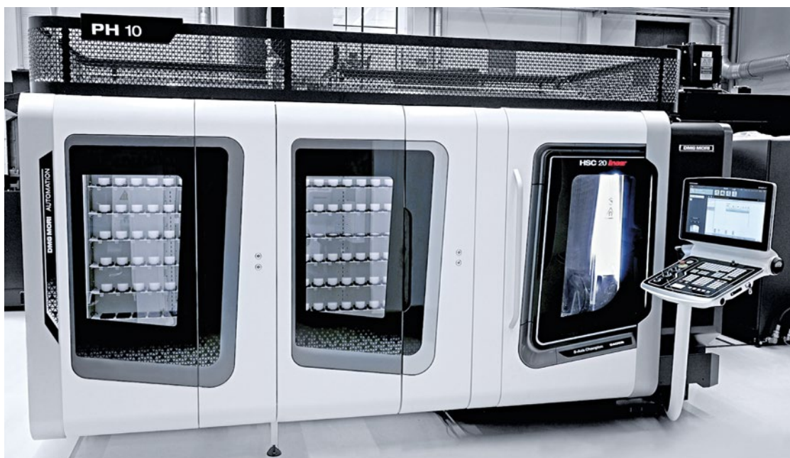
HSC 20 linear munkadarab kezelő rendszerként alkalmazott dupla kivitelű PH 10-zel
