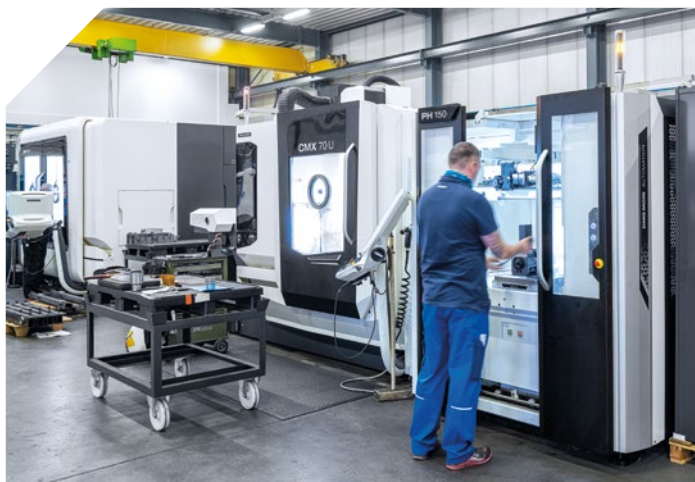
A CMX 70 U-hoz használt PH 150 lehetővé teszi az egyedi alkatrészek és kisebb munkadarabok automatizált megmunkálását és azok szükségalapú prioritizálását.
