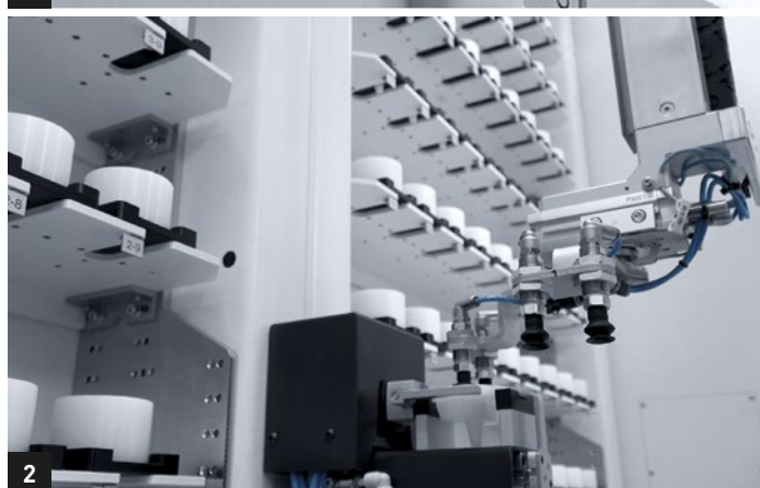
1+2. PH 10 som emnehåndteringssystem til op til 126 rå og færdige dele til skinnebensorer.
