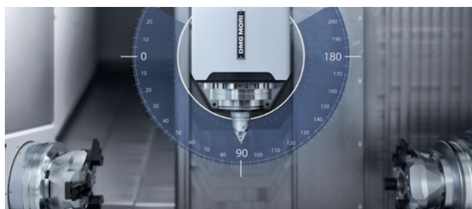
B-akse, der kan programmeres trinfri \pm 120 grader.
