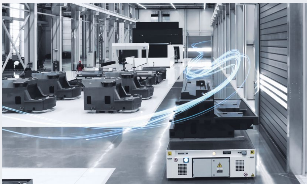
Automatisering og digitalisering er de centrale elementer i Digital Factory hos FAMOT. Store maskinkomponenter bearbejdes på to DMU 1000 Special Edition. Transporten sker på hypermoderne AGV'er.
