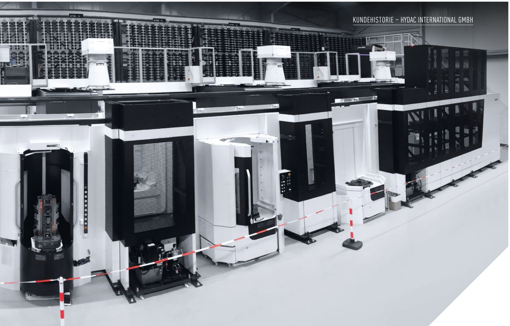
6 x NHX 4000 med et pallelager med 48 rum udgør et automatiseret system med en bredde på 33 m. Desuden indeholder systemet et værktøjslager med op til 4.000 pladser.
