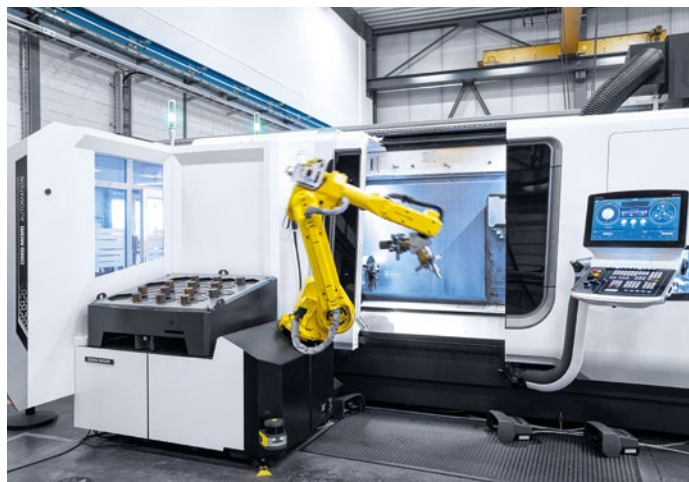
Díky automatizovanému kompletnímu obrábění z 6 stran na centru CTX beta 1250 TC klesl čas obrábění obrobků až o 80 % na 1,5 hodiny.
