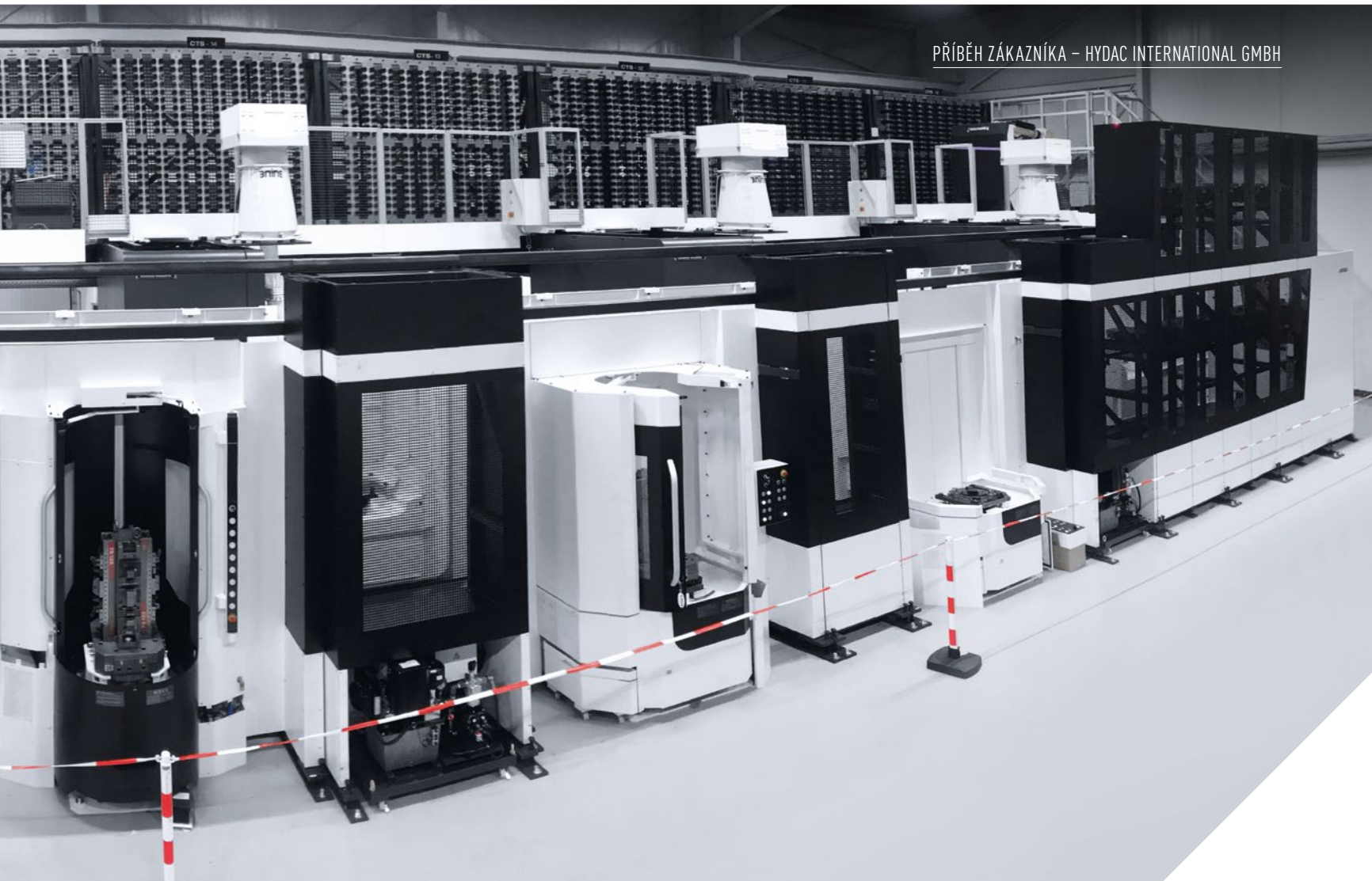
Na šířce 33 m se nachází 6 center NHX 4000 s 48místnou paletovou automatizací. Kromě toho byl do systému integrován sklad nástrojů s až 4.000 místy.
