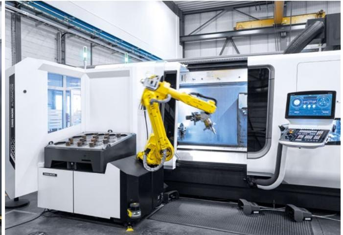
在CTX beta 1250 TC上自动进行6面完整加工, 将工件的加工时间缩短至1.5小时, 相当于缩短80%。
