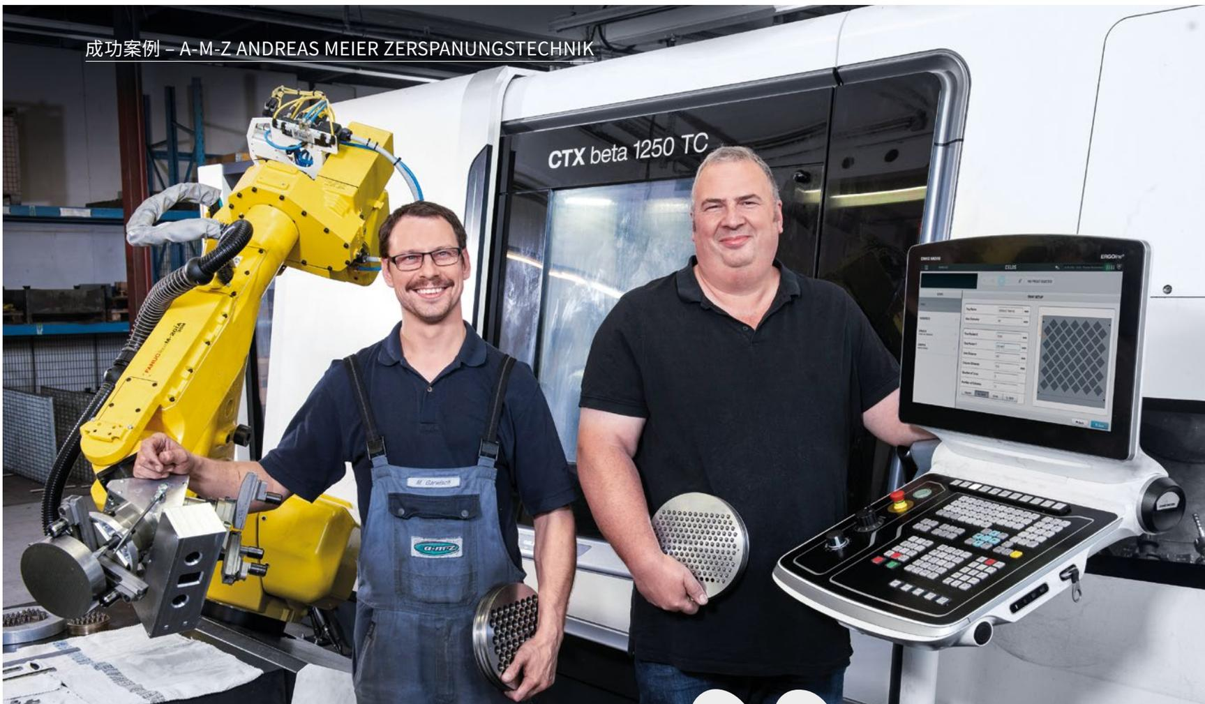
2020年3月，a-m-z引进DMG MORI的配Robo2Go Vision的CTX beta 1250 TC。APP应用程序简单易用，在设置Robo2Go Vision时，无需任何特殊的机器人编程知识。
