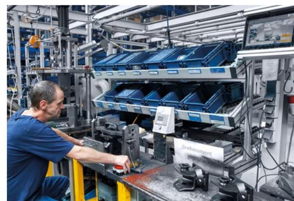
在测试位确定组装中使用的扭矩，在TULIP APP应用程序中记录数据，进行后续分析。
