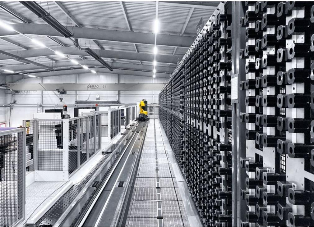
中央刀库另外提供多达4,000刀位。用刀具预调仪(TSS)设置刀具,刀位数达60个。在刀具预调仪上,由DMC读码器识别刀具并全自动地装入刀库系统或从刀库中取出,并提供刀具数据。
