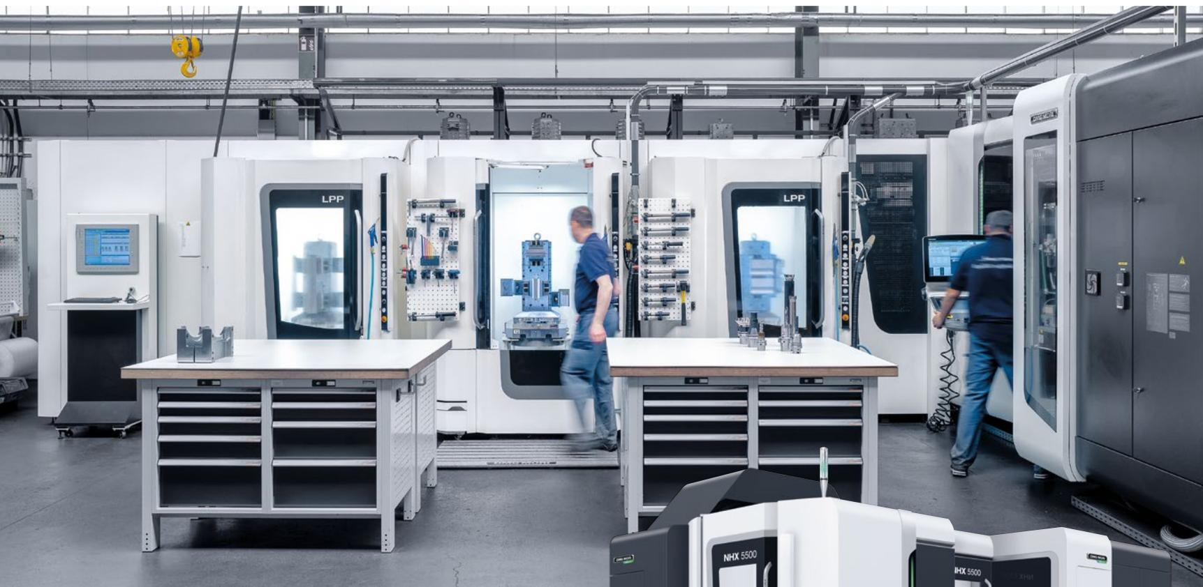
扩大自动化系统后,现在,Burghardt Zerspanung的40工位LPP托盘系统用于两台NHX 5000卧式加工中心、一台NHX 5500卧式加工中心。MCC-LPS生产单元控制系统控制整个自动化系统,可用该控制系统或用办公室计算机控制。
