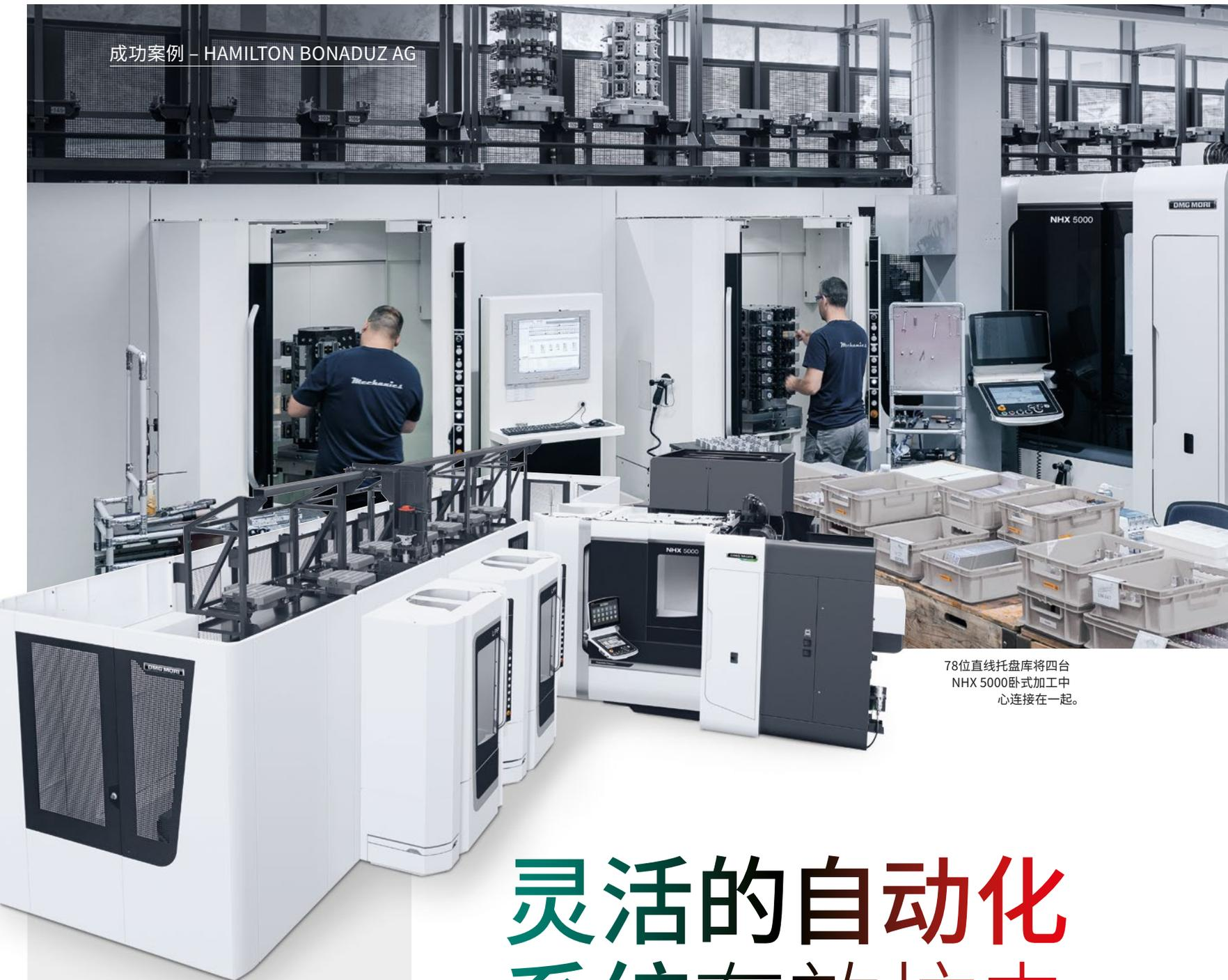
78位直线托盘库将四台NHX 5000卧式加工中心连接在一起。
