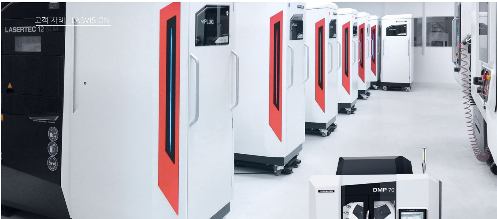
적층 가공 및 고정밀 밀링: LABVISION은 LASERTEC 12 SLM 6대, DMP 70 2대 및 MILLTAP 700 1대를 통해 치과 기술 분야에서 하이브리드 프로세스 체인을 구축했습니다.
