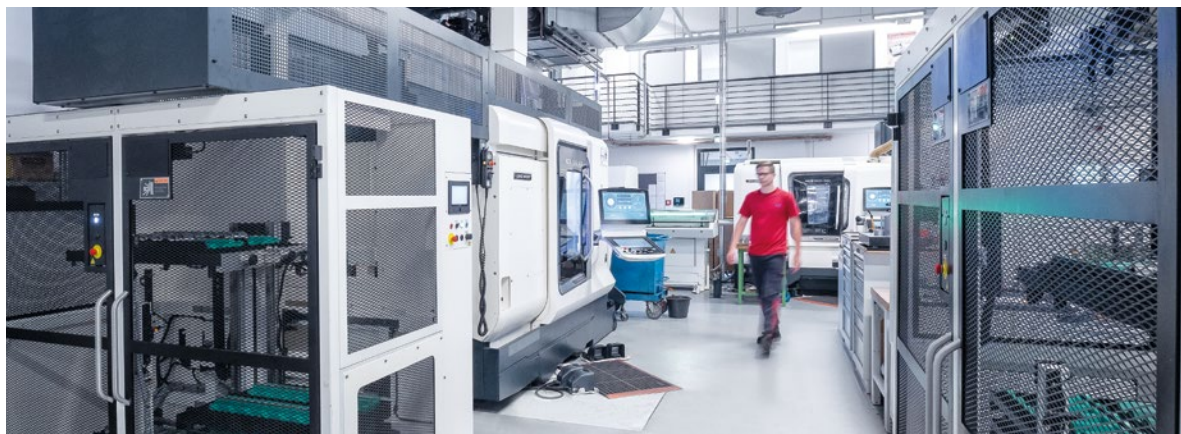
두 개의 GX10 갠트리 로터와 NXZ2000, NLX2500 그리고 NLX2000의 바 로더를 사용하면 효율적으로 기계를 가동시킬 수 있습니다.
