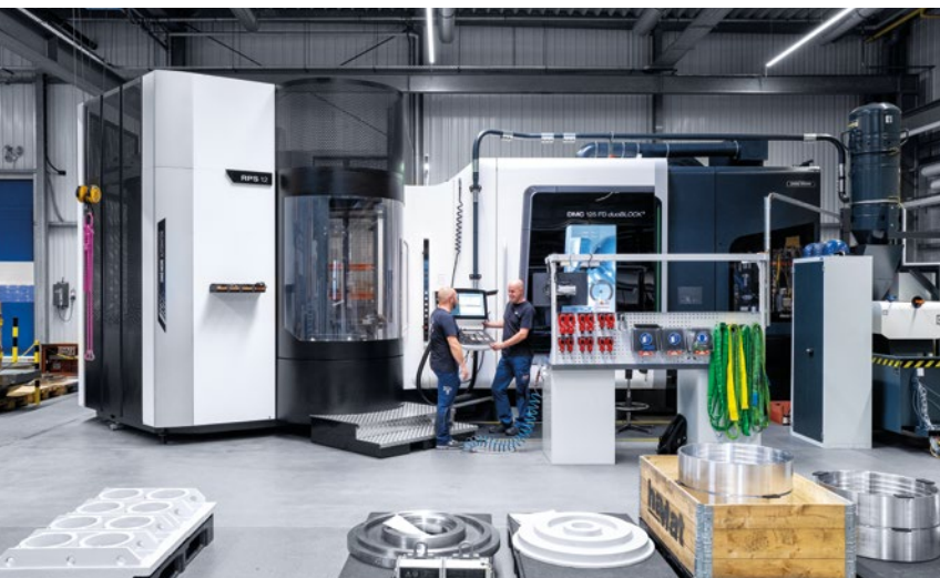
그라인딩 주기가 장착된 DMC 125 FD duoBLOCK은 반지름 0.4 \mu m까지의 표면 품질과 5 \mu m의 원형도를 달성합니다.
