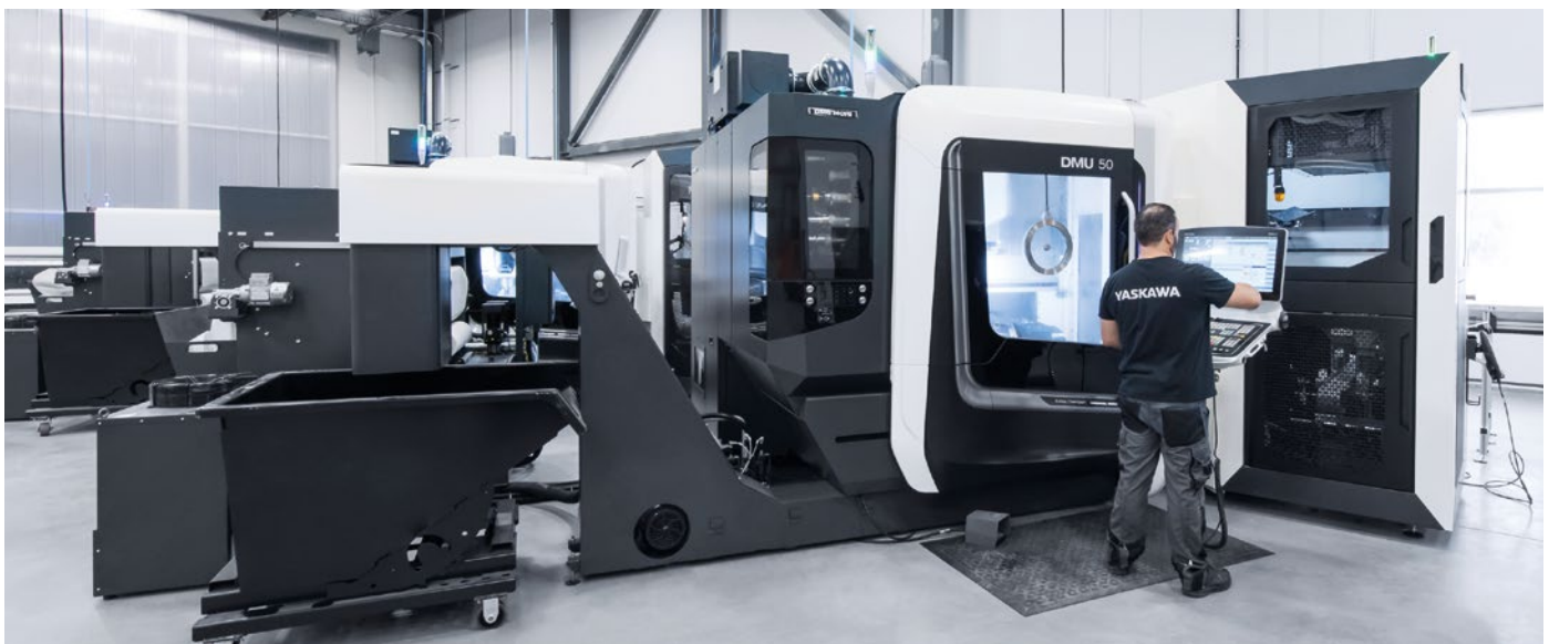
Attabotics는 WH 6 Cell이 장착된 DMU 50를 통한 생산 자동화로 생산량이 최대일 때도 스토리지의 기반인 컬럼 및 기타 구성 요소에 대한 높은 수요를 충족합니다.
