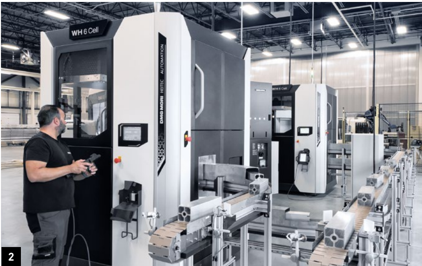
1. Attabotics는 제조 자동화를 통해 생산량이 최대일 때도 스토리지의 기반인 컬럼 및 기타 구성 요소에 대한 높은 수요를 충족합니다. 2. DMU 50 3세대의 자동 적재 및 하역은 높은 생산 능력과 더 뛰어난 제조 유연성을 달성합니다.
