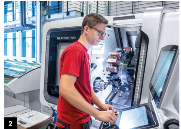
1. NLX 2000에서 MT Marchetti의 구동 도구 사용. 2. WTE Präzisionstechnik는 주로 바 로더가 장착된 NLX2000에서 자동화 프로세스를 통해서 부품을 생산합니다. 3. 2019년에 구매한 NZX 2000 및 NLX 2500에는 모두 GX10 T 갠트리 로더가 장착되어 있습니다.
