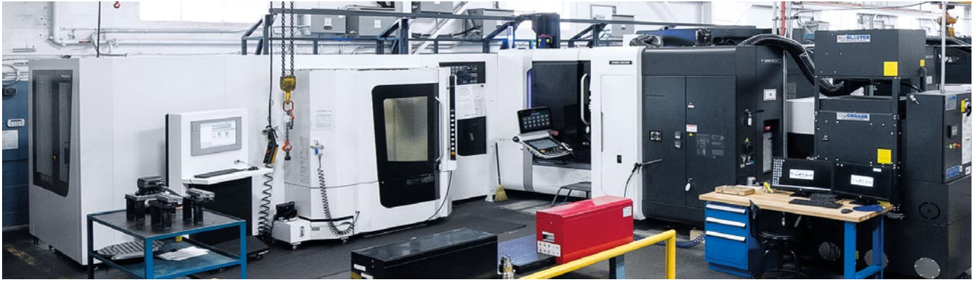
Top Grade Molds의 장비에는 2개의 선형 팔레트 풀이 장착된 4 개의 NHX 5000이 포함되어 있으며 자동 작동이 가능합니다.
