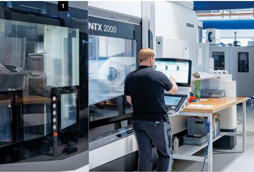
1. SQ Products가 총 6 대의 NTX 2000 센터를 통해 생산 프로세스를 대폭 최적화한 덕분에 어깨용 임플란트의 처리 시간이 몇 주에서 단 하루로 단축되었습니다. 2. SQ Products는 의료용 임플란트 생산에서 요구되는 정확성을 최고 수준으로 만족시킵니다.
