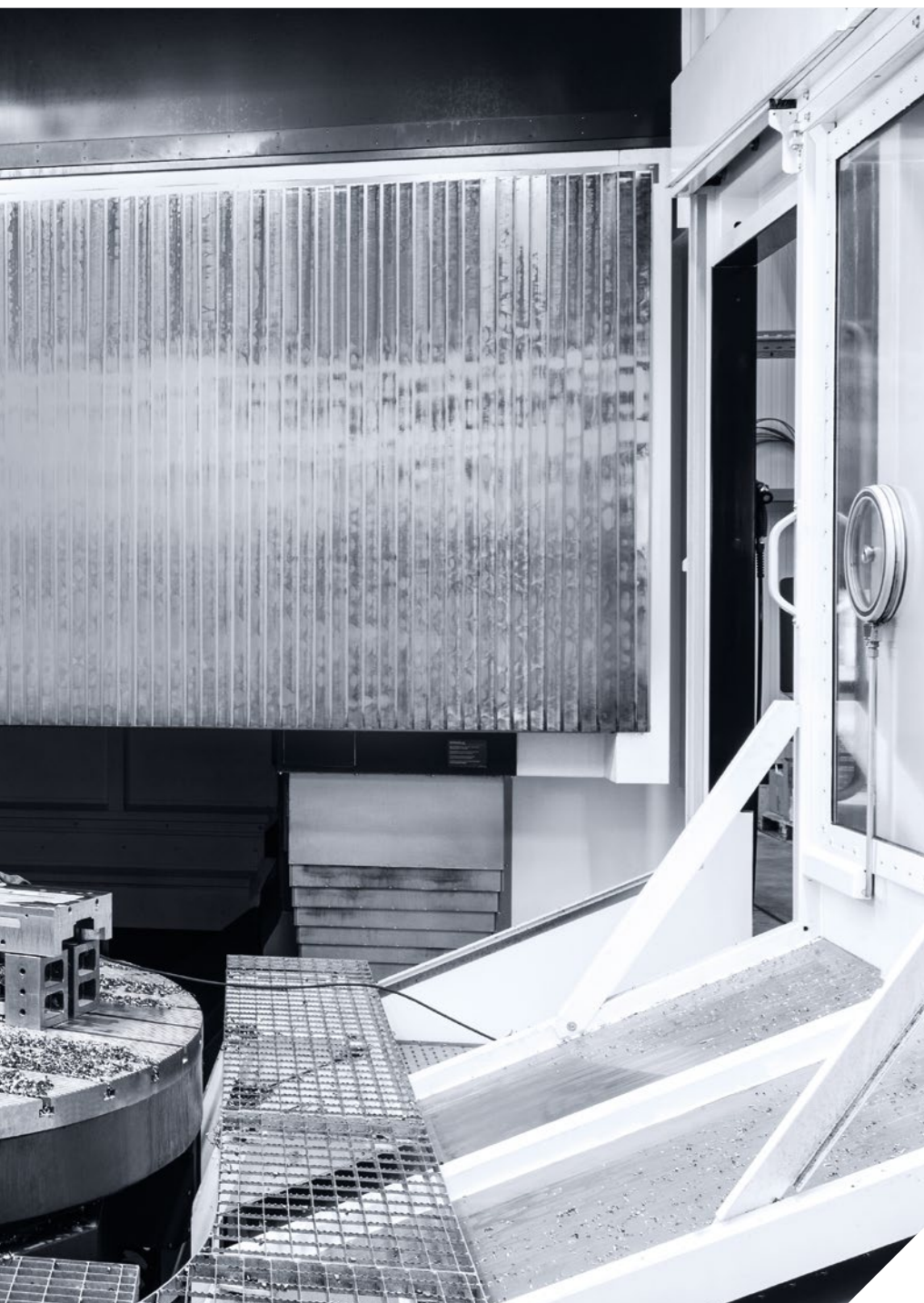
A área de trabalho da DMU 340 P mede 3.400 x 3.400 x 1.600 mm com uma carga de mesa de até 16 t.
