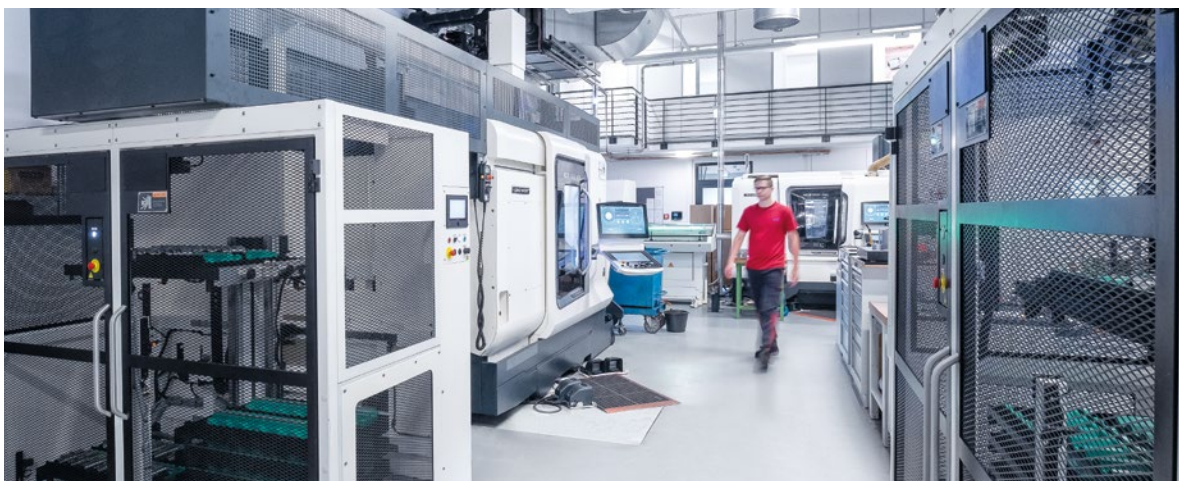
Os dois carregadores Gantry GX 10 T do NZX 2000 e NLX 2500, bem como o carregador de barras do NLX 2000 permitem uma operação eficiente das várias máquinas.
