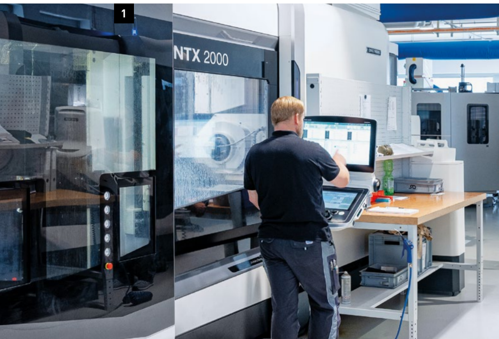
1. Met in totaal zes NTX 2000's heeft SQ Products de productieprocessen dermate ingrijpend geoptimaliseerd dat de procestijd van de kom van een schouderimplantaat is teruggebracht van soms enkele weken tot één dag. 2. Bij de vervaardiging van medisch-technische implantaten voldoet SQ Products aan de hoogste nauwkeurigheidseisen.
