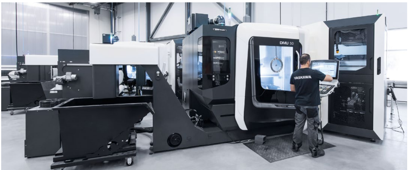
Dankzij de geautomatiseerde productie op de DMU 50 met WH 6 Cell kan Attabotics de grote vraag naar basiskolommen en andere componenten aan, zelfs bij volledige bezettingsgraad.
