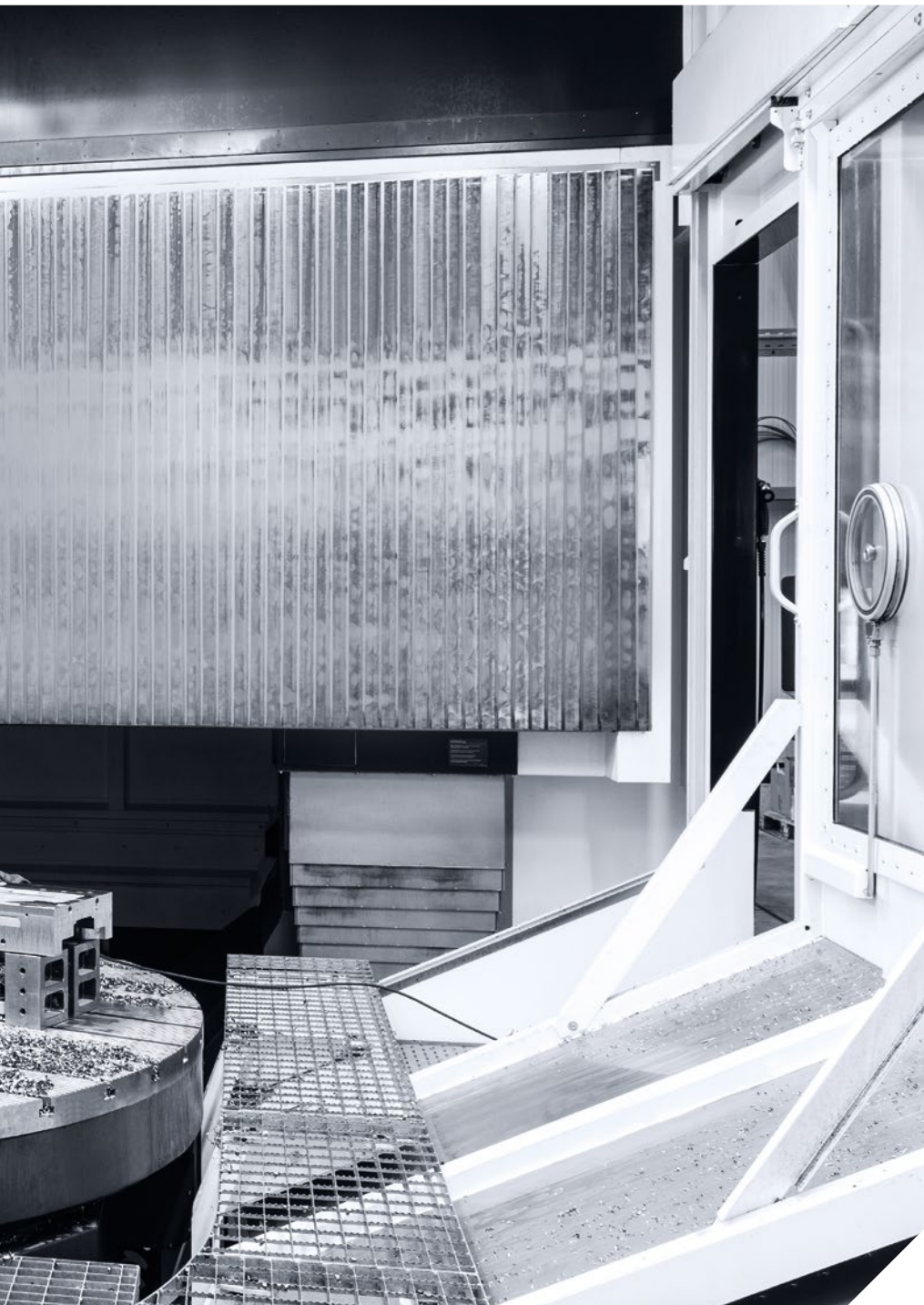
De werkruimte van de DMU 340 P meet 3.400 x 3.400 x 1.600 mm bij een tafelbelasting van maximaal 16 ton.
