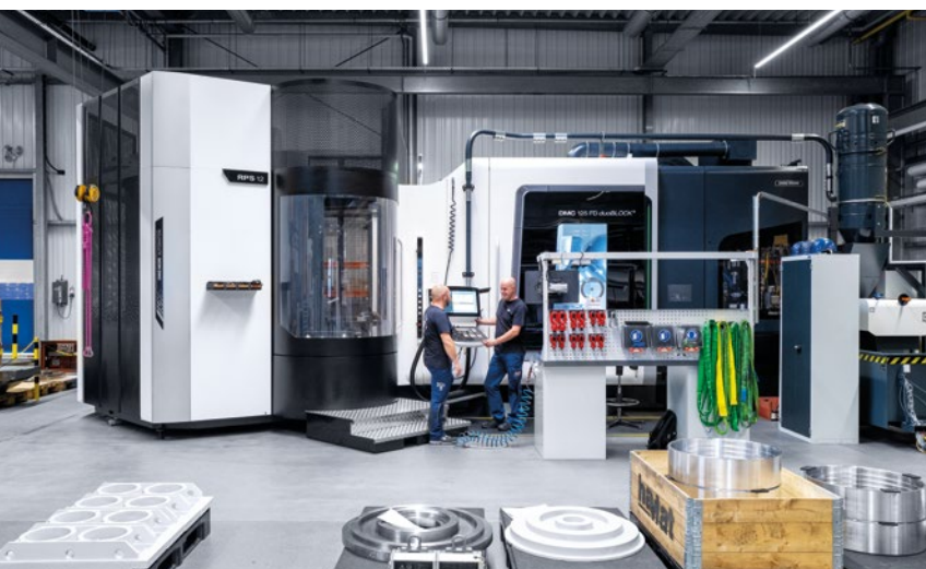
Uitgerust met de slijpcycli haalt de DMC 125 FD duoBLOCK oppervlaktekwaliteiten tot 0,4 \mu\text{m} Ra bij een rondheid van 5 \mu\text{m} .
