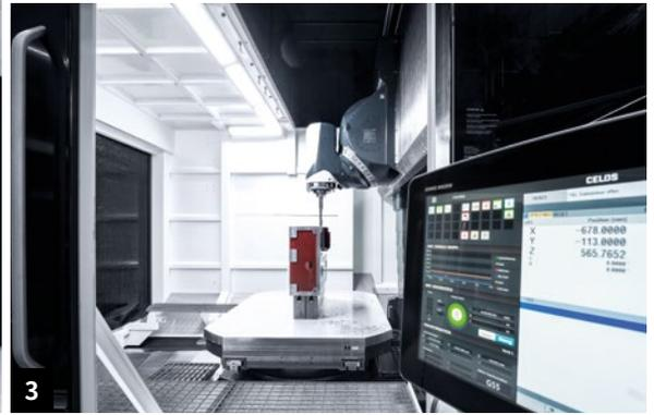
1+2. DMU 210 U  $\mu$ Precision的空間精度為13  $\mu$ m, 所有軸向的定位精度皆為4  $\mu$ m。
