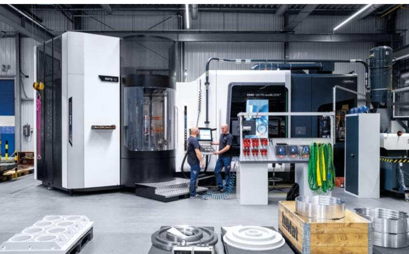
配備研磨加工循環的DMC 125 FD duoBLOCK可達成表面品質Ra 0.4µm和真圓度5µm。
