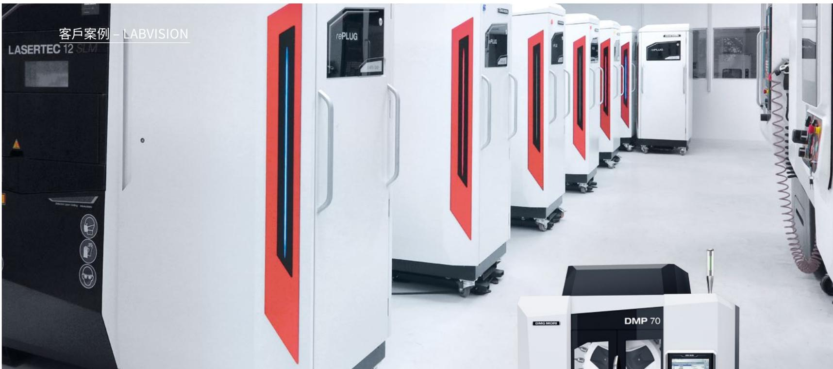
積層製造和高精度銑削：LABVISION擁有六部LASERTEC 12 SLM、兩部DMP 70和一部MILLTAP 700，已在牙科技術領域建立了混合工藝鏈。
