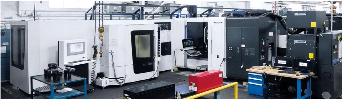
Top Grade Molds的機台陣容中，包括了四部NHX 5000，它們可以自動地跟兩個線性托盤池一起運作。
