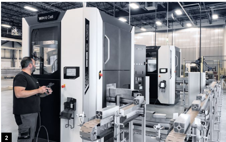
1. Dankzij geautomatiseerde productie kan Attabotics de grote vraag naar basiskolommen en andere componenten aan, zelfs bij volledige bezettingsgraad. 2. Het autonoom laden en lossen van de DMU 50 3 rd Generation resulteerde in een voldoende hoge productiecapaciteit en meer flexibiliteit in de productie.
