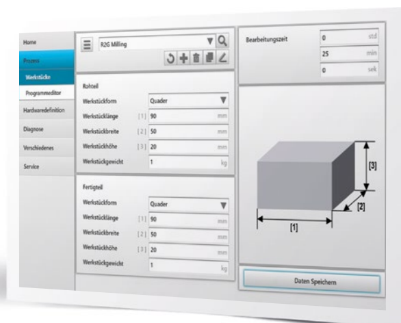
Programmeersjabloon voor werkstuk inleren in < 15 min.
