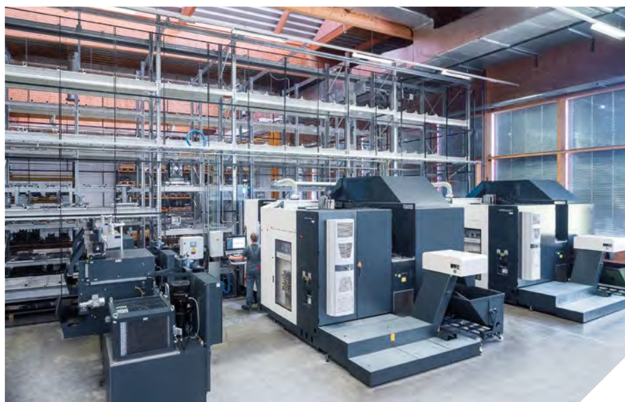
Dwie frezarki DMC 60 H linear są podłączone do magazynu na 100 palet. Wraz z magazynem na 303 narzędzia zapewniona została autonomiczna produkcja w nocy i w weekendy.
