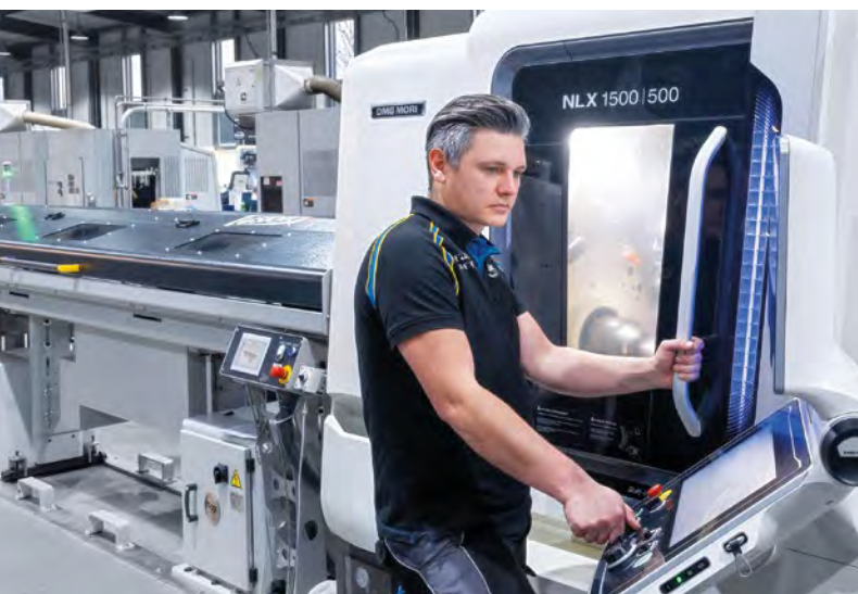
Jeden operator odpowiada za dwie tokarki NLX 3000 i jedną zautomatyzowaną tokarkę NLX 1500 z podajnikiem prętów.
