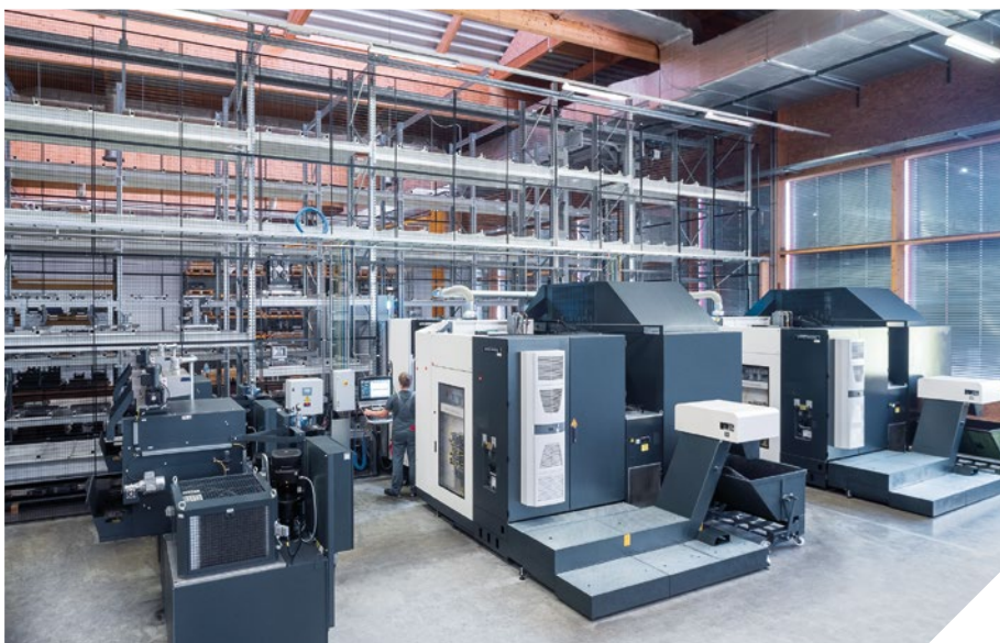
將兩台DMC 60 H linear 連接到100個位置的托盤儲存系統。結合配備有303個刀位的刀具庫，可確保在夜間和週末進行自主生產。
