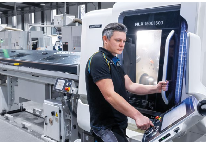
一位作業員負責兩台NLX 3000機台和一台配備有桿式裝載機的自動NLX 1500。
