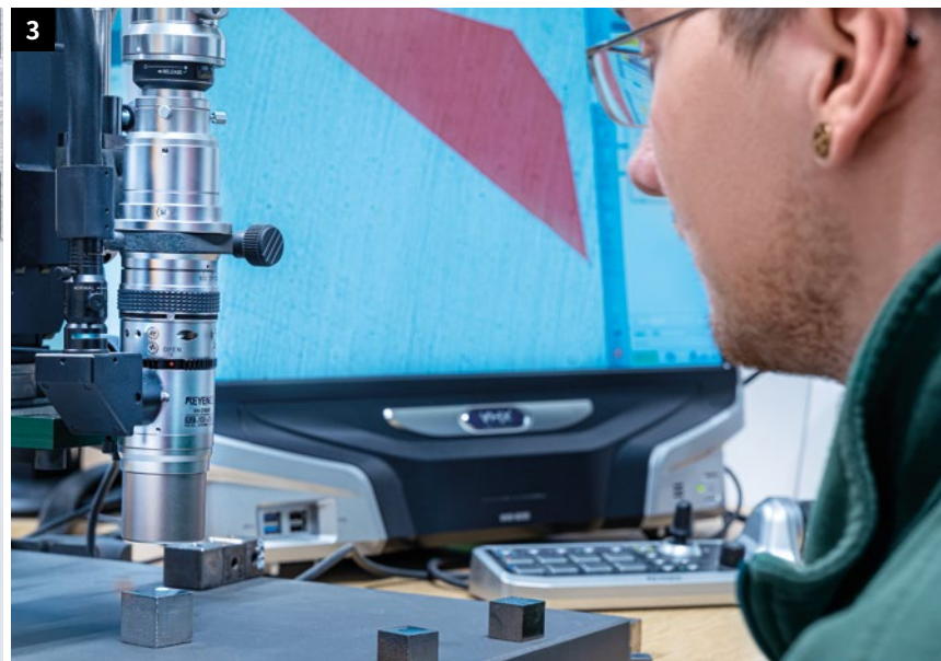
1. 對工件進行外部程式編輯, 然後將其轉到CELOS APP RDesigner。從CAD資料進行簡易操作的CAM程式編輯。 2. 床製程中, 即使是最細絲的幾何形狀也能輕鬆達成。 3. Modellbau Clauß 使用顯微鏡檢查粉床中所生產工件的結構密度。
