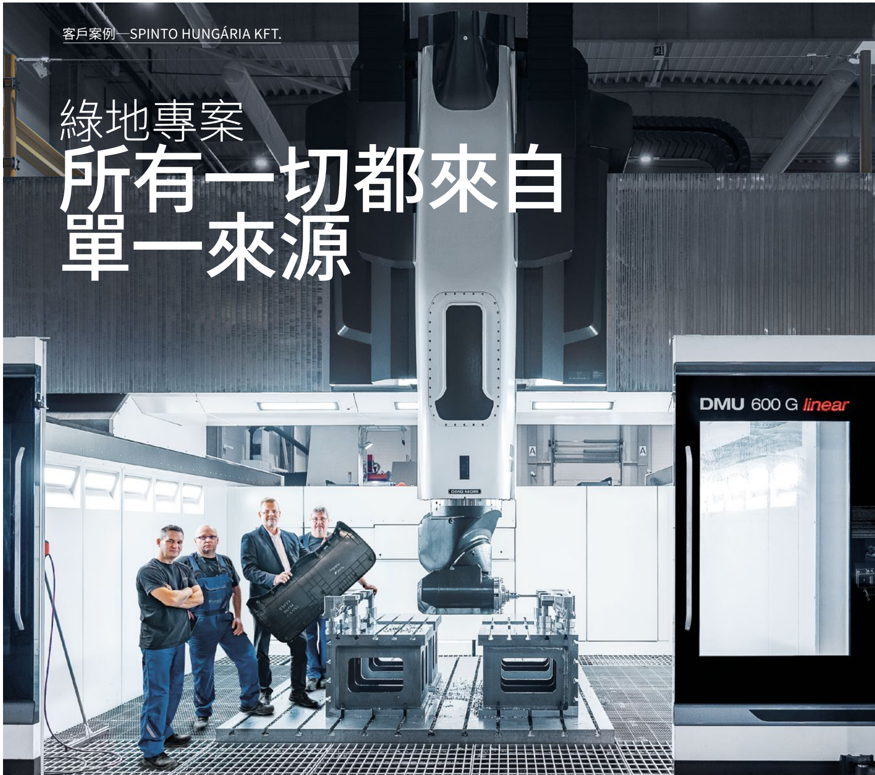
DMU 600 Gantry linear 工具機是在SPINTO生產的亮點。它可以對達150公噸/6,000 mm的大型零件，進行5軸同步加工，而輪廓精度達10 \mu m。
