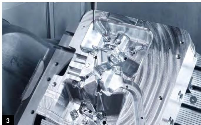
1. SPINTO ha instalado un total de ocho máquinas herramienta de DMG MORI. 2. La exhaustiva gama de servicios de SPINTO va desde el diseño CAD, pasando por la programación CAM... 3. ... hasta la producción orientada a la calidad de exigentes componentes de moldes, p. ej. en la DMU 75 monoBLOCK.
