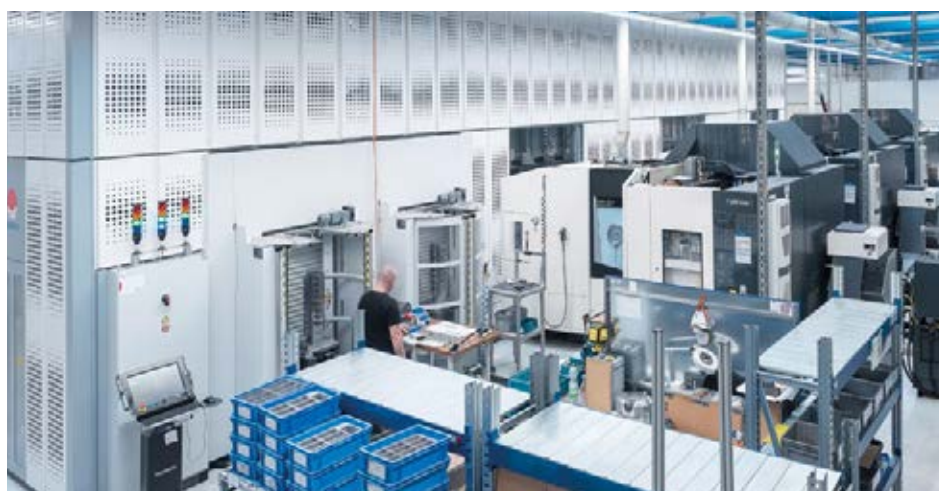
Największa z dotychczas zainstalowanych zautomatyzowanych linii obejmuje trzy centra DMC 60 H każda z magazynem na 303 narzędzia.
