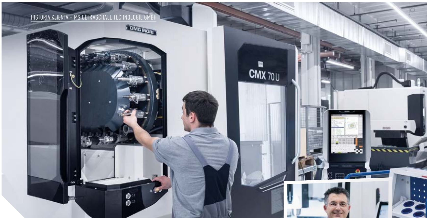
Przebrabianie w trakcie obróbki, dzięki dostępowi do magazynu narzędzi na frezarce CMX 70 U.
