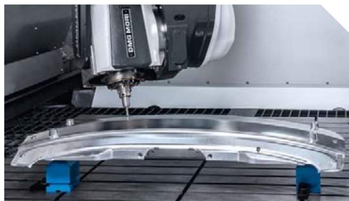
Formy i matryce: 5 osiowa obróbka symultaniczna wsadu do formy z aluminium.
