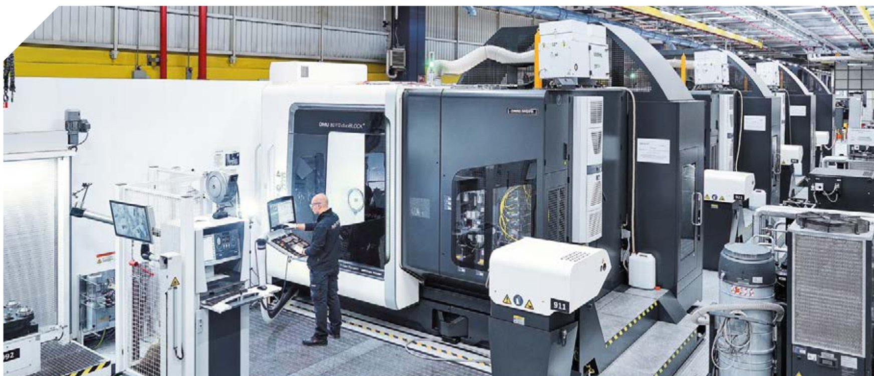
Automatyzacja dostosowana do potrzeb klienta: cztery zautomatyzowane frezarki DMU 80 FD duoBLOCK z magazynem palet.
