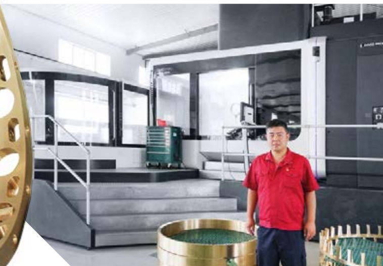
Kierownik produkcji RUIGU pan Chen przed frezarką DMC 210 U, na której produkuje się ponadwymiarowe koszyczki łożyska.
