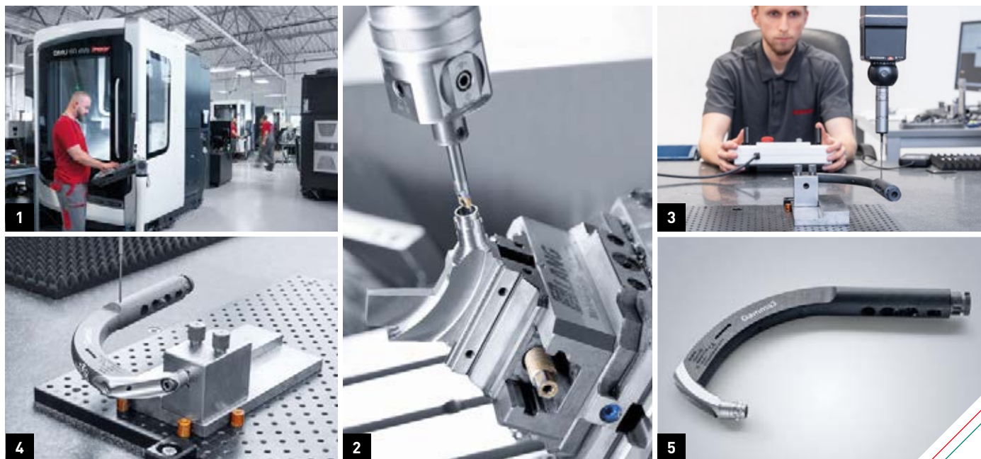
1. DMU 60 eVo zainstalowany w 2019 roku jest jedną z 14 obrabiarek tego typu pracujących w firmie Moll Engineering 2. 5-osiowa symultaniczna obróbka części wykonanych z włókna węglowego oraz stali nierdzewnej 3. + 4. Tolerancje wyrobów dla przemysłu medycznego często wynoszą zaledwie kilka mikrometrów 5. Moll Engineering jest w bliskiej współpracy z DMG MORI Medical Excellence Center, które mieści się w Seebach. Razem optymalizują proces produkcyjny złożonych i dokładnych części.
