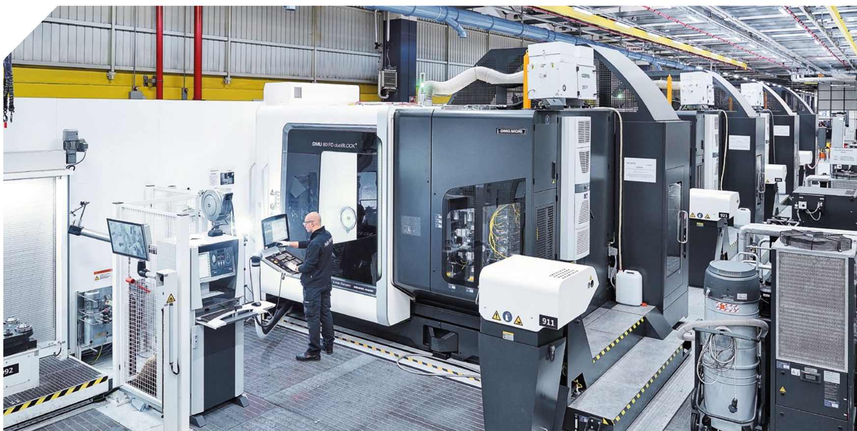
量身定制自动化： 四台与托盘库系统互联的自动化DMU 80 FD duoBLOCK加工中心。
