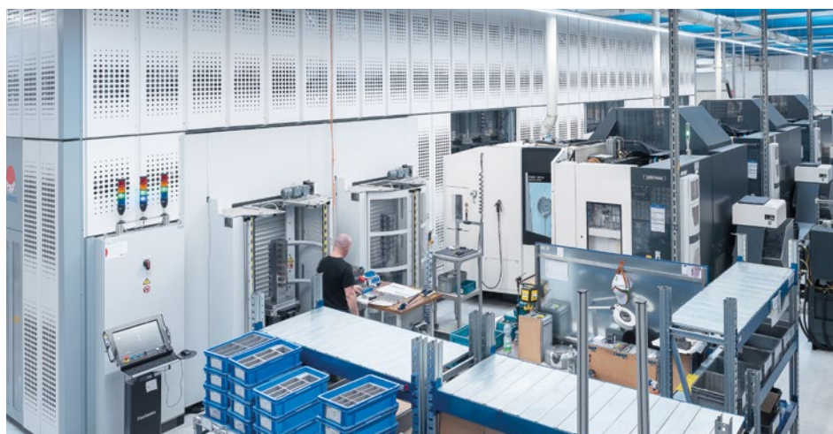
迄今为止，安装规模最大的自动化系统，包括三台DMC 60 H加工中心，每台加工中心各配5个轮式刀库，共达303刀位。
