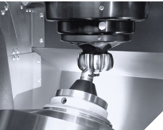
内滚道圈在CTV 250 DF立式车削中心上进行5轴铣削加工。
