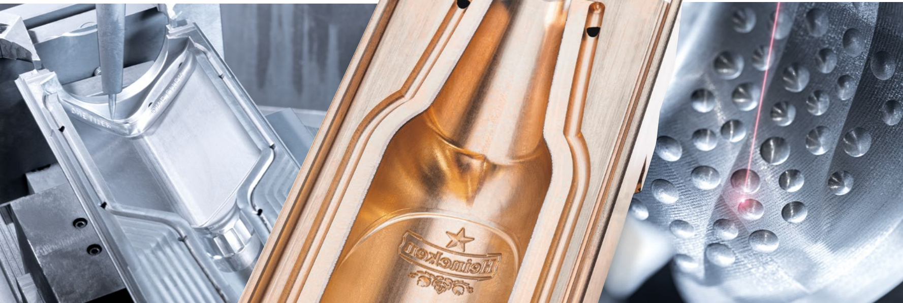
OMCO生产高精度玻璃模，共使用180台DMG MORI机床，其中包括10台HSC 55 linear 高速切削加工中心和5台LASERTEC 45 Shape激光表面纹理加工机床。
