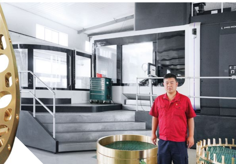
瑞谷公司生产厂长陈先生在DMC 210 U前， 该机用于加工大型轴承保持架。
