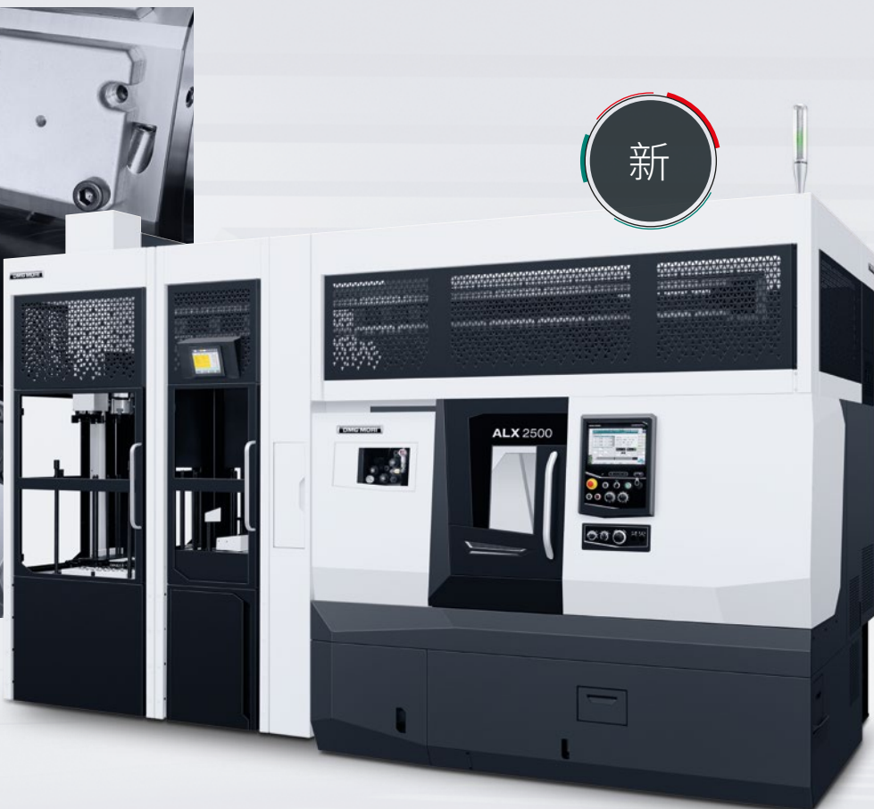
配GX15桁架式机械手的ALX 2500，最大工件尺寸可达 \phi 200 \times 150 mm
