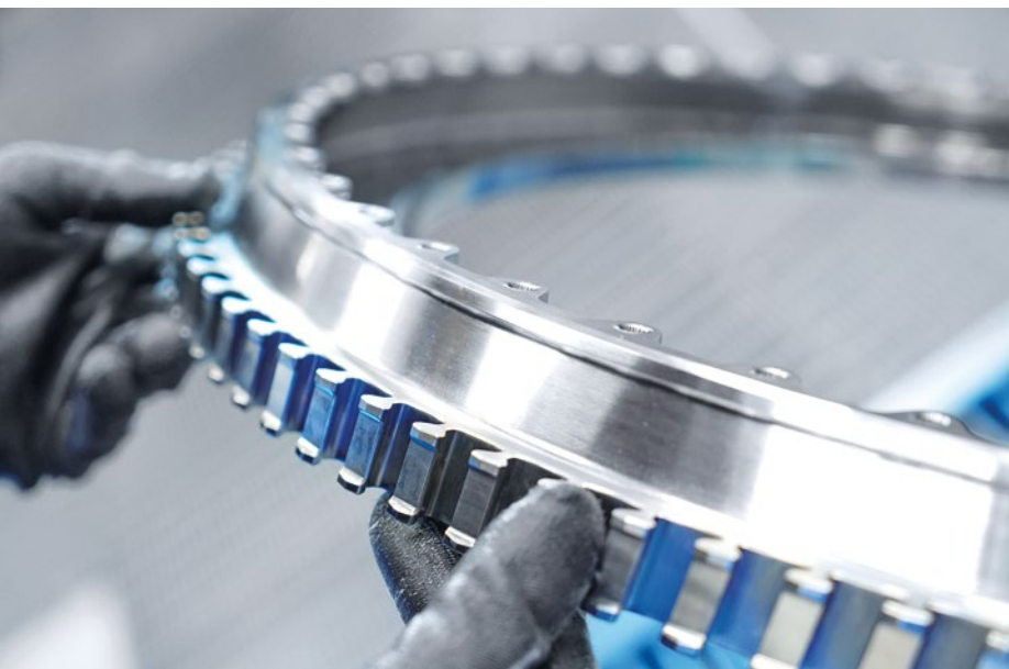
质量控制:正在检查Inconel 718材质的涡轮盘外观
