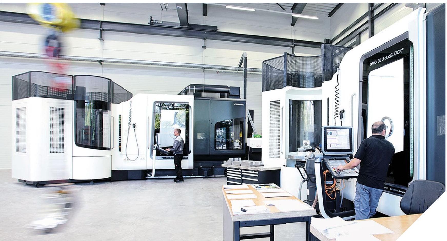
配RS 12回转托盘库, 多达12盘位, 两台DMC 80 U duoBLOCK 加工中心高效率地全天24小时生产。
