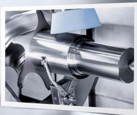
Medição no processo durante a usinagem de retificação. Repetibilidade das medições 5 µm.
