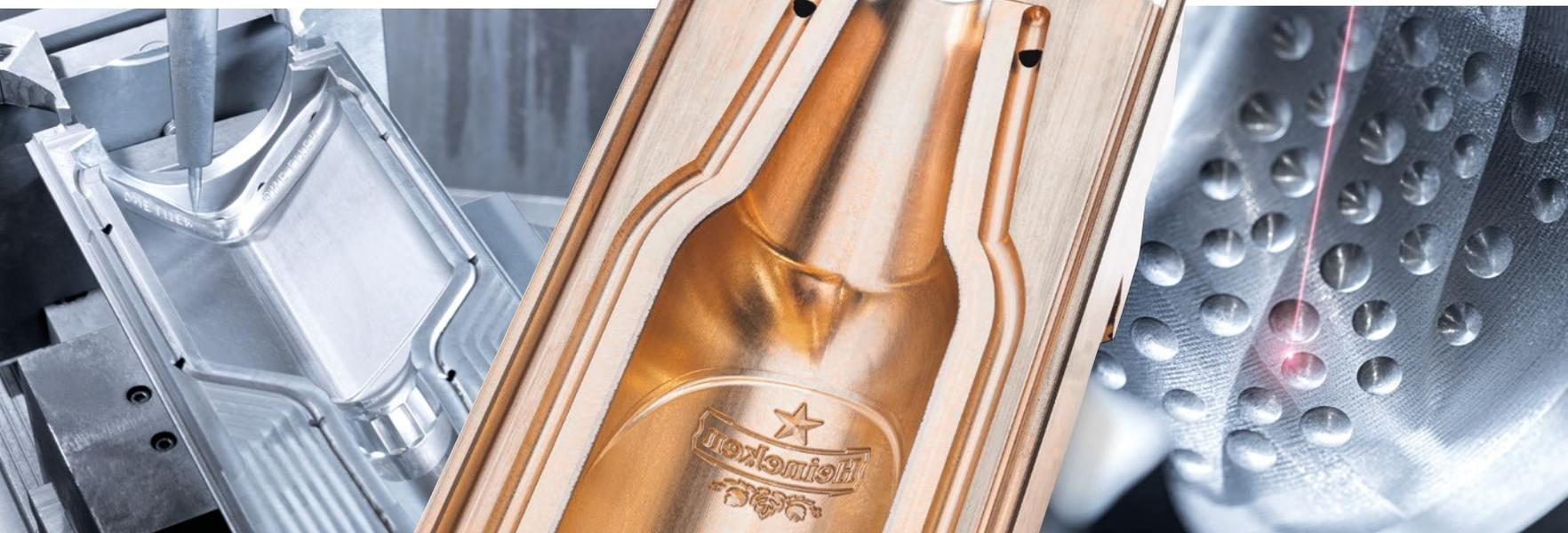
Em 180 máquinas DMG MORI – incluindo dez HSC 55 *linear* para corte de alta velocidade e cinco LASERTEC 45 Shape para texturização de superfície – a OMCO fabrica moldes para vidro altamente precisos.
