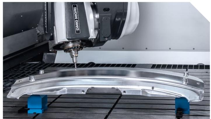
Die & Mold: Usinagem simultânea em 5 eixos de um inserto do molde em alumínio.
