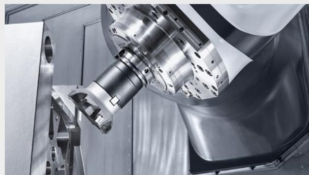
Fuso speedMASTER com 20.000 rpm e 130 Nm | 35 kW
