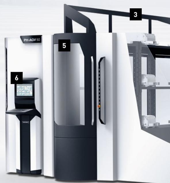
Também imensamente importante: Uma vez que o AGV manobra e posiciona sem trilhos de guia, o acesso às máquinas permanece livremente acessível em todos os momentos. Assim, as barreiras de segurança são completamente supérfluas.
