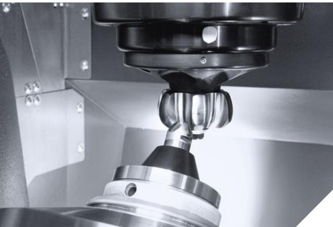
Usinagem de fresamento em 5 eixos de um cubo de esferas no CTV 250 DF.
