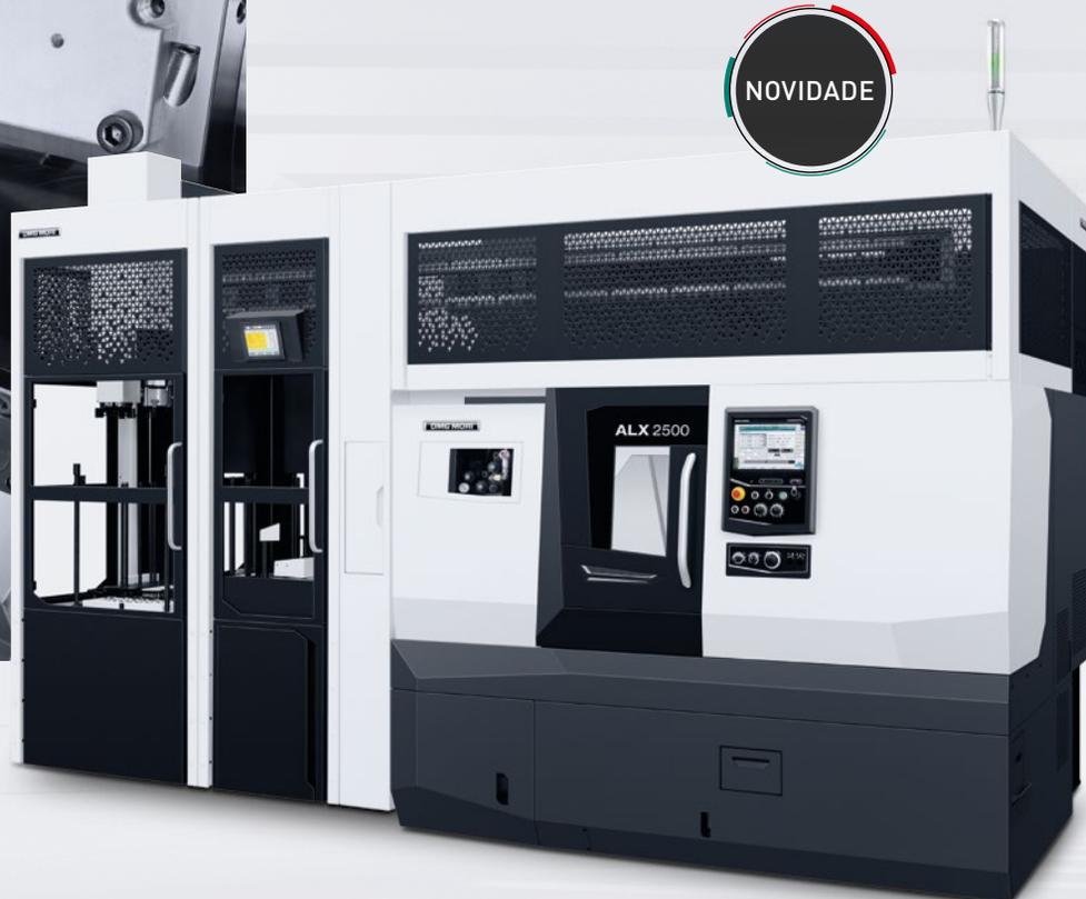
ALX 2500 com Gantryloader GX15 para peças até  $\varnothing 200 \times 150$  mm
