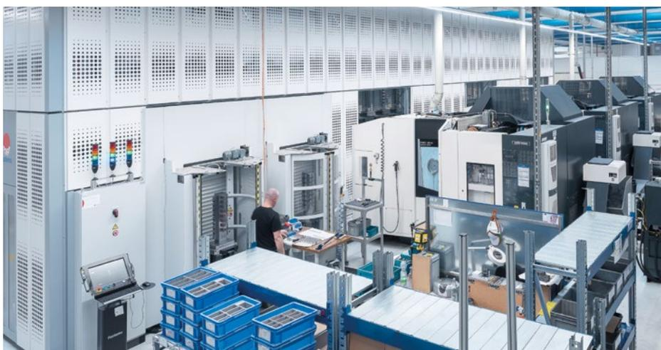
O maior dos sistemas de automação instalados até agora compreende três DMC 60 H, cada uma com um magazine tipo carrossel de 5 posições para 303 ferramentas.
