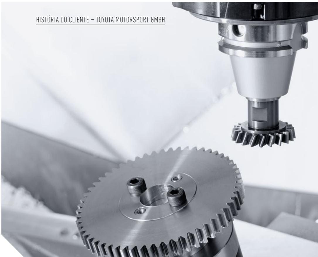
DMG MORI gearSKIVING — Usinagem de engrenagens em uma DMU 60 eVo em qualidade de retificação.
