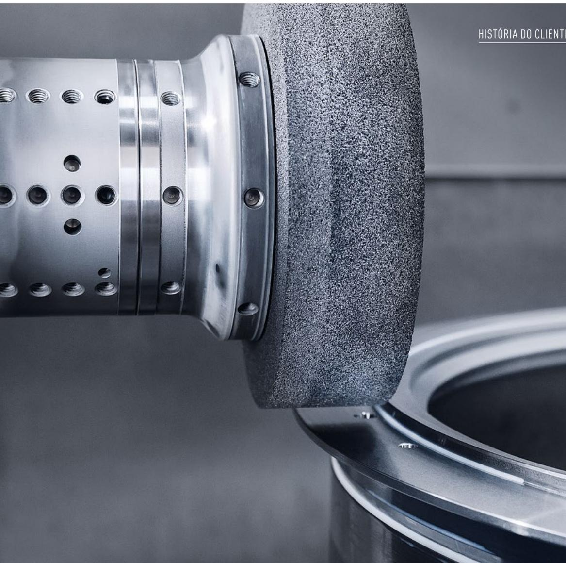
A DMC 125 FD duoBLOCK, incluindo o pacote de retificação, combina fresamento, torneamento e retificação em uma fixação.
