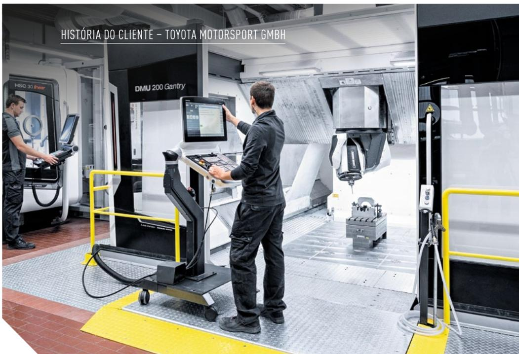
Instalação ao nível do chão da DMU 200 Gantry em um fosso, para carregar e descarregar os componentes sensíveis de carbono com uma empilhadeira.
