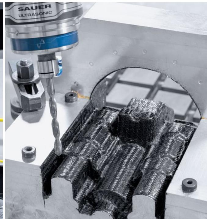
Usinagem de compósito segura no processo na DMU 200 Gantry graças ao fuso ULTRASONIC trocável de forma totalmente automática.
