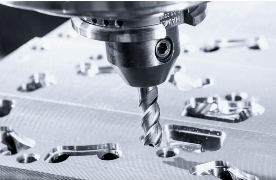
A produção de moldes por sopro e extrusão varia da perfuração e do fresamento das refrigerações, através do desbaste, até o acabamento e, com isso, necessita de centros de usinagem aplicáveis universalmente.
