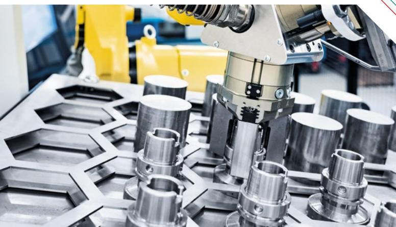
Em caso de diferentes diâmetros, o Robo2Go calcula automaticamente o ponto central das peças para agarrá-las com precisão.
