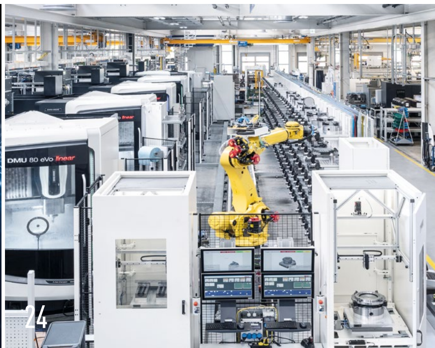
客戶案例Schaeffler集團： 5×DMU 80 eVo linear 搭配180個托盤裝置。
