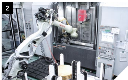
1. 胚料重量在40到50kg之間的工作範例 2. NT 4300 DCG的自動機器人裝載
