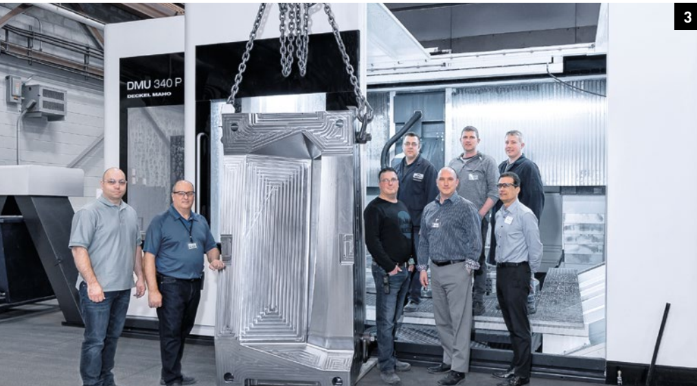
1. DMC 85 monoBLOCK上的複雜五軸加工 2. 附有三個托盤系統, DMC 85 monoBLOCK允許長達20小時的無人值班操作 3. DMU 340 P可加工大型工件, 精度 \pm 0.05 mm
