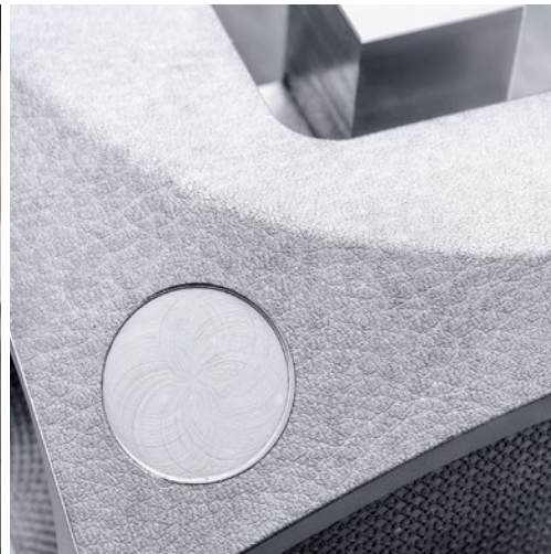
與傳統製程相比，雷射咬花在許多情況下明顯優越，因為可以不再需要如腐蝕和蝕刻之類的製程步驟。
