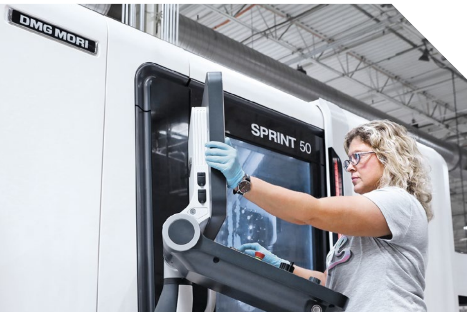
作業員Erica Williams操作SPRINT 50。 生產車床可以自動加工棒材， 並且在最多36個刀具站上切削夾頭零件。
