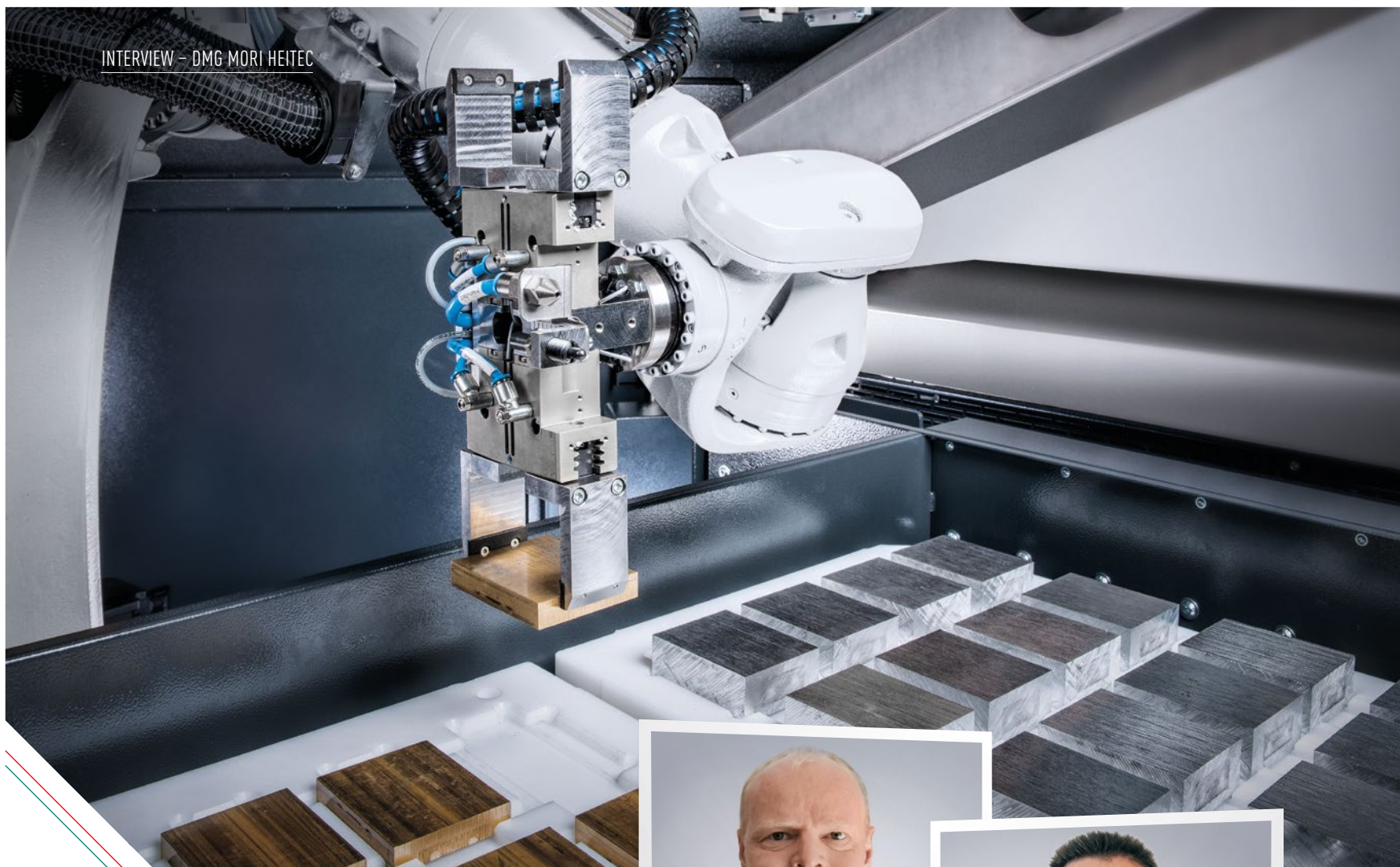
WH 15 CELL: Modulair automatiseringssysteem voor werkstukken tot 15 kg
