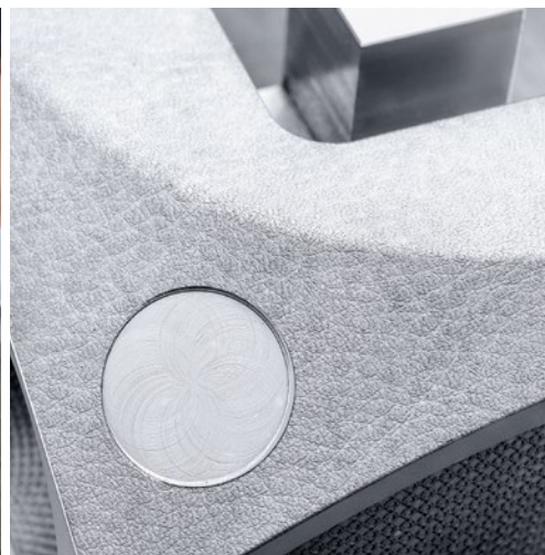
Jämfört med konventionella processer är lasertextureringen i många fall klart överlägsen, eftersom processsteg som erodering och etsning elimineras.
