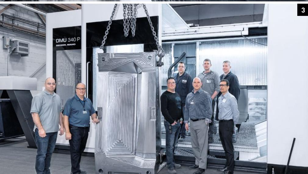
1. Lavorazione a 5 assi ad elevata complessità sulla DMC 85 monoBLOCK 2. Con il sistema di cambio a tre pallet, la DMC 85 monoBLOCK può lavorare in completa autonomia fino a un massimo di 20 ore 3. La DMU 340 P produce pezzi di grandi dimensioni con una precisione di  $\pm 0,05$  mm
