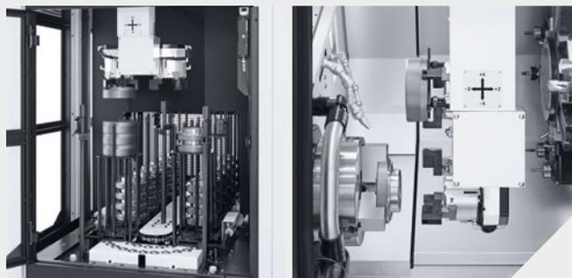
1. Magazzino di impilaggio pezzi con carico di 35 kg per ciascun posto pallet
