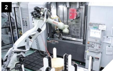
1. Esempio di pezzo con un peso da grezzo compreso tra 40 e 50 kg 2. Caricamento automatico mediante robot sulla macchina NT 4300 DCG
