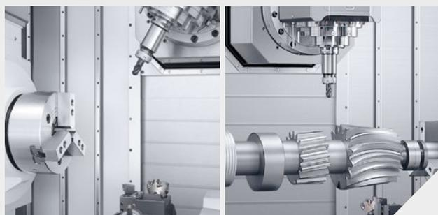
Lavorazione completa su 6 lati di pezzi complessi con diametro fino a  $\varnothing 670$  mm e 1.500 mm di lunghezza con il mandrino Turn & Mill compactMASTER e secondo portautensili (torretta inferiore) con asse Y di 80 mm.
