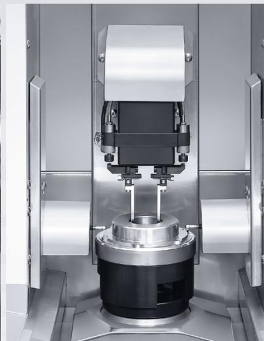
Stazione di misura per la misurazione in tempo mascherato durante il processo produttivo.
