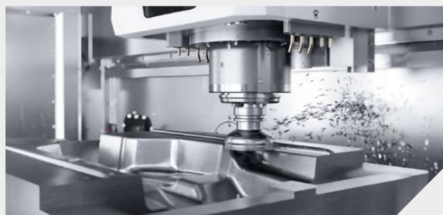
Mandrino inlineMASTER\* con velocità di 15.000 giri/min, in opzione speedMASTER fino a 20.000 giri/min o 200 Nm, e mandrino powerMASTER\* con coppia pari a 288 Nm (SK50).
