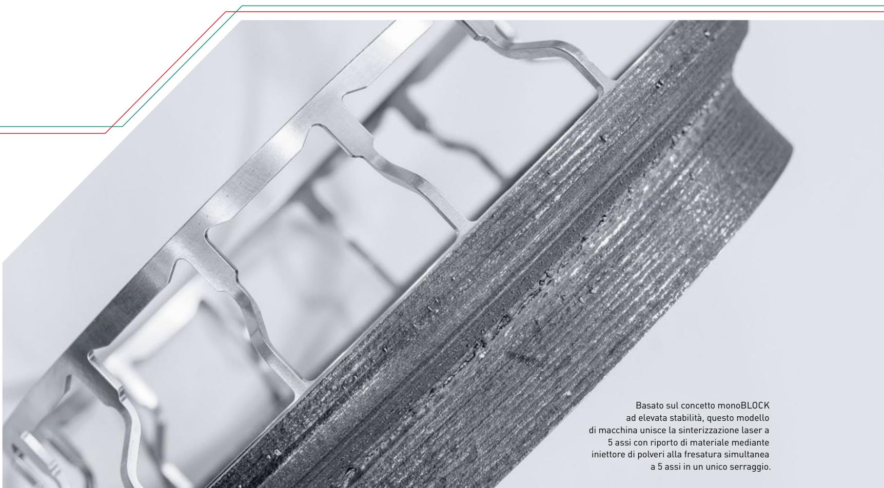
Basato sul concetto monoBLOCK ad elevata stabilità, questo modello di macchina unisce la sinterizzazione laser a 5 assi con riporto di materiale mediante iniettore di polveri alla fresatura simultanea a 5 assi in un unico serraggio.
