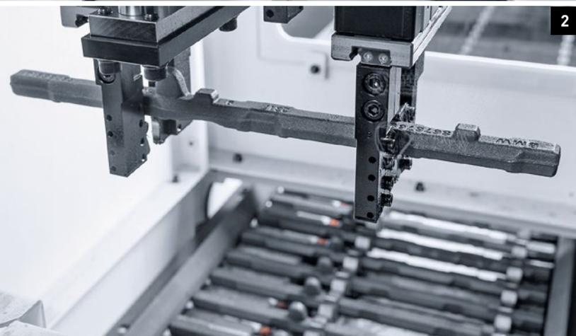
1. Nel 2016, la Eisenwerk Erla ha costruito un reparto di lavorazioni meccaniche automatizzate con sistemi di concatenazione di 18 NLX 2500 complessivamente 2. Il robot preleva i pezzi grezzi dal nastro trasportatore
