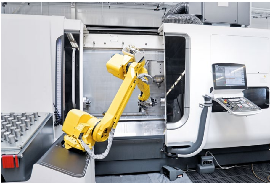
Entladen des fertigen Werkstückes durch den Robo2Go aus der Gegenspindel.
