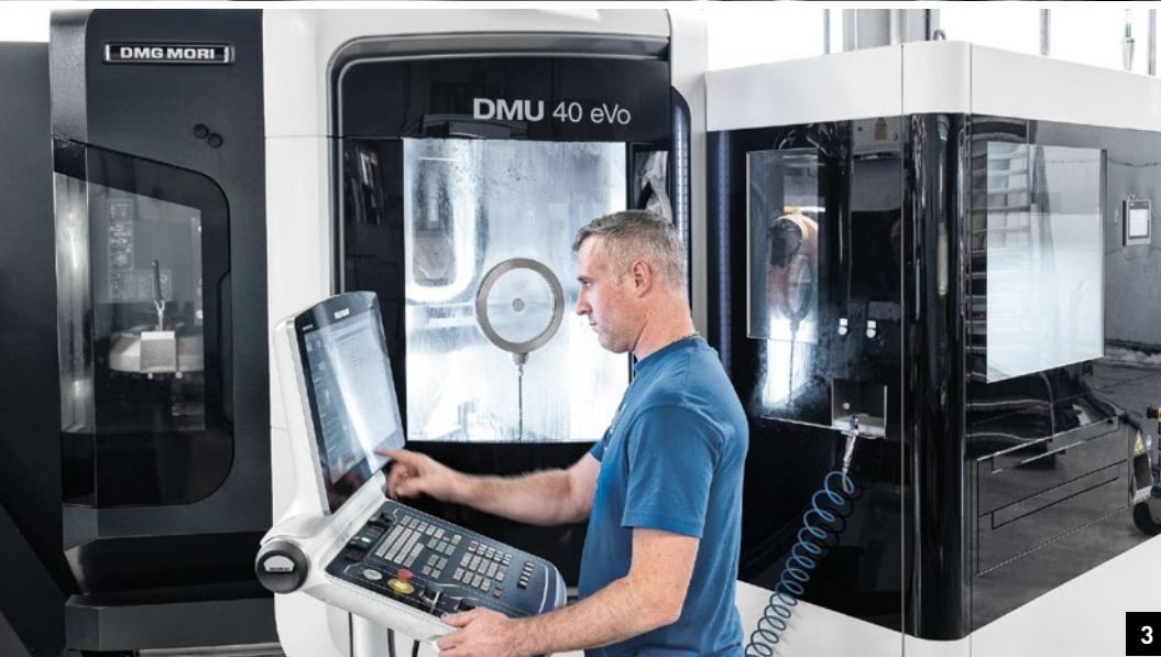
1. DMG MORI imalat hücresi anahtar proje olarak özgün biçimde blade işleme için tasarlandı 2. 3 vardiyalı işletimde birkaç yüzdelik milimetre aralığında hassas sonuçlar 3. Manüel kullanımda bile mükemmel erişilebilirlik
