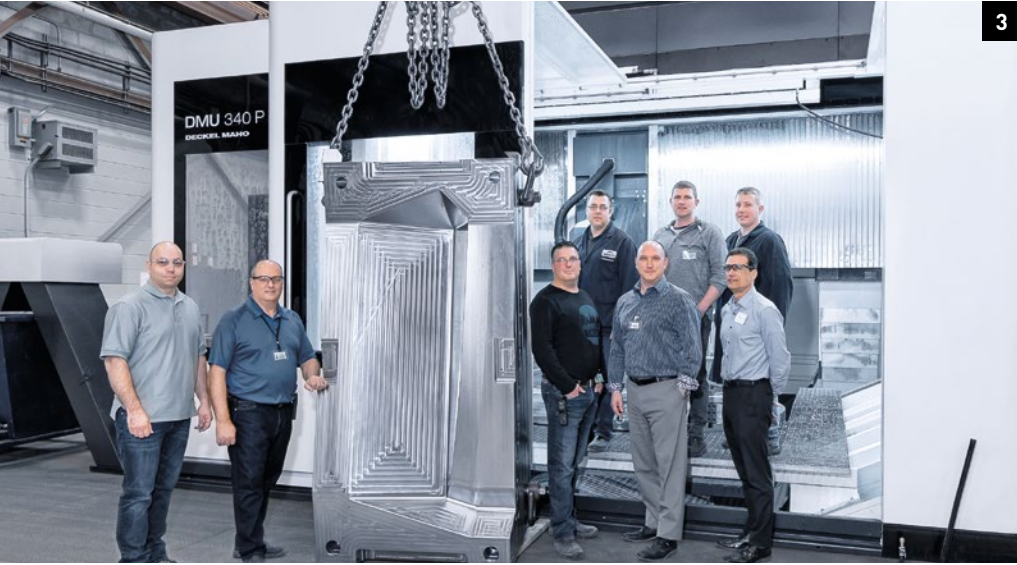
1. DMC 85 monoBLOCK'ta özel 5 eksenli işleme 2. Üç palet için bir değiştirici ile DMC 85 monoBLOCK 20 saate kadar özerk çalışıyor 3. DMU 340 P büyük iş parçalarını ±0,05mm'lik bir doğrulukla imal ediyor
