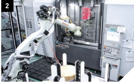
1. 40 ve 50 kg arasında işlenmemiş parça ağırlığı ile iş parçası numunesi 2. NT 4300 DCG'nin otomatik robot yüklemesi
