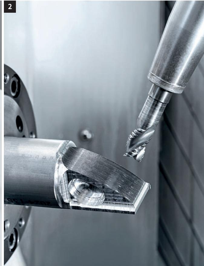
1. - 3. DMG MORI機床的穩定性和切削能力可完成複雜的義肢鋁／鋼或鈦金屬製元件的高精度加工。
