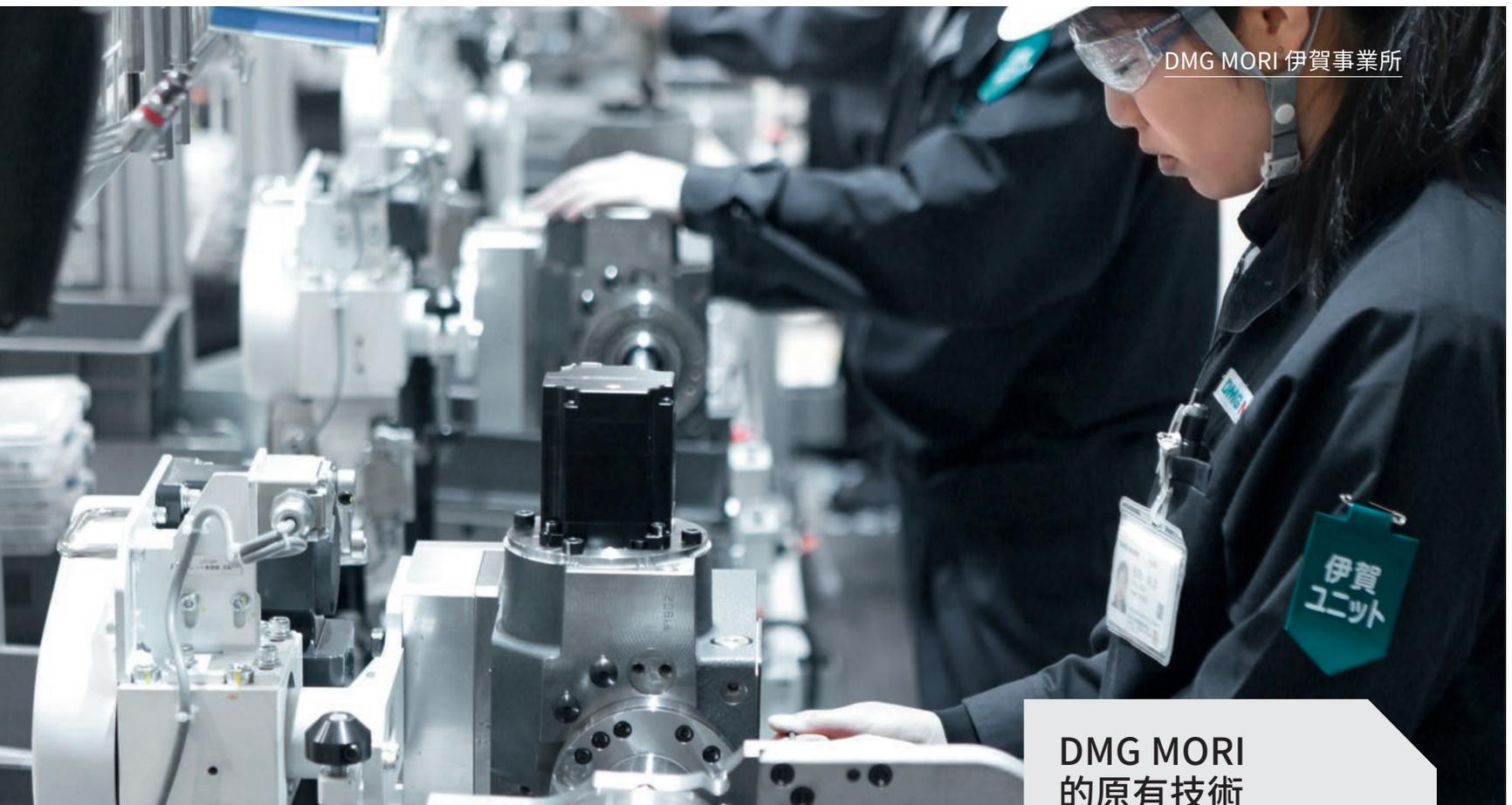
伊賀工廠的特點在於高水平的垂直整合，包含針對下列系列來生產主軸：speedMASTER, powerMASTER, torqueMASTER, compactMASTER和車削主軸turnMASTER。伊賀工廠每年生產近 7,000種高科技主軸。
