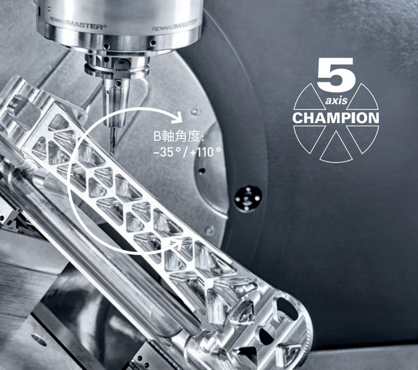
5軸同動加工的旋轉工作臺，最高可放置重量300 kg的工件
