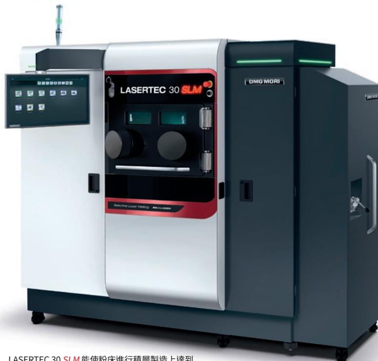
LASERTEC 30 SLM能使粉床進行積層製造上達到300 × 300 × 300 mm加工量(X/Y/Z) – 包含粉末準備作業
