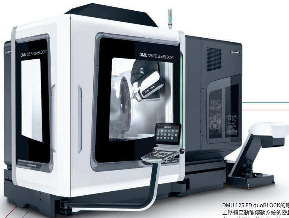
DMU 125 FD duoBLOCK的應用範圍從重加工移轉至動能傳動系統的密封加工精度控制在 $\mu\text{m}$ 範圍內，其直徑可達1,600 mm，原料類型非常廣泛，從灰鑄鐵到鉻鋼和青銅都有。
