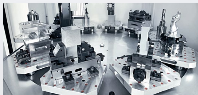
PH 150 – 8-組托盤存放空間，包含托盤載重可達250 kg（另可選購350 kg）
