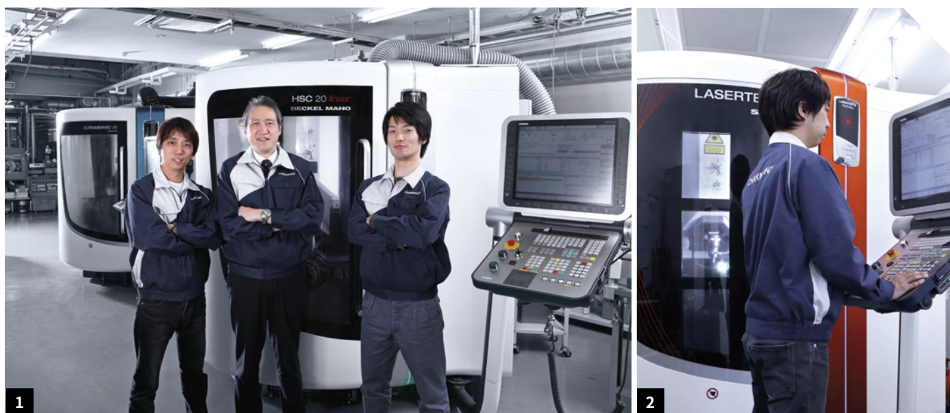
1. 由左至右：工程師Yuki Kataoka、董事總經理Kazuo Iwahori及工程師Terukazu Mizuguchi，站於HSC 20 linear 高速加工中心前，另外後方則是ULTRASONIC 20 linear 2. 在溫控室內搭配LASERTEC 20 FineCutting 完成5軸雷射切削，以符合精度要求
