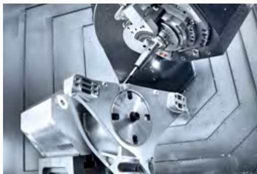
toolcraft 透過高精度、高效 5 軸加工製造精密零件, 如車輪架。
