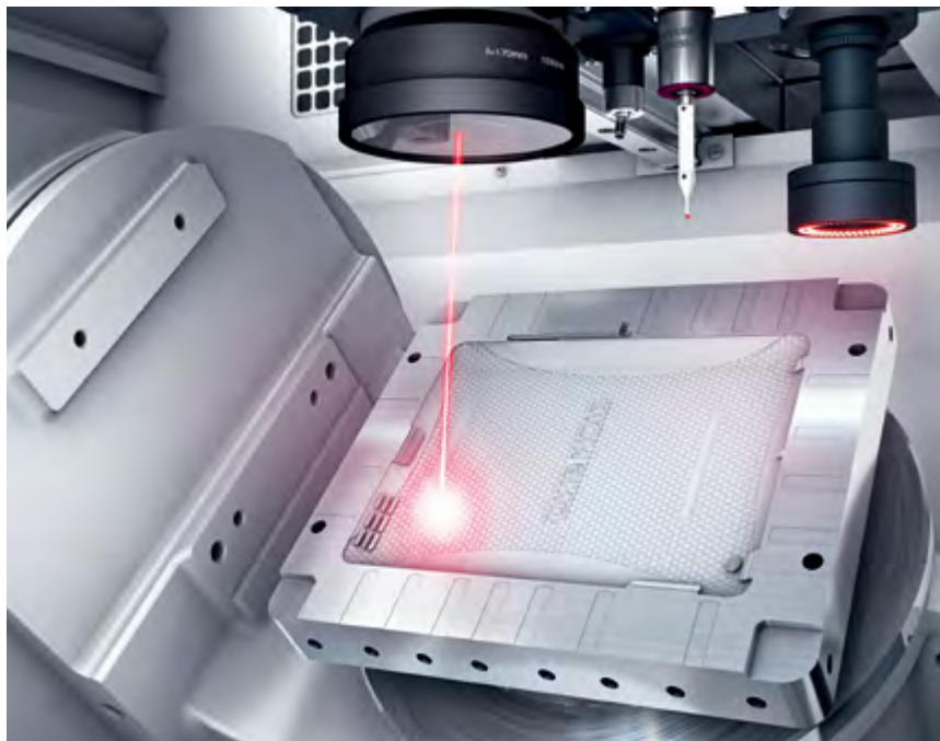
鐳射燒蝕: 微型模型的鏤空輪廓。
