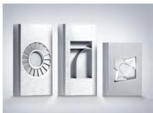
借助皮秒雷射器對硬金屬深度 3D 輪廓進行鐳射加工
