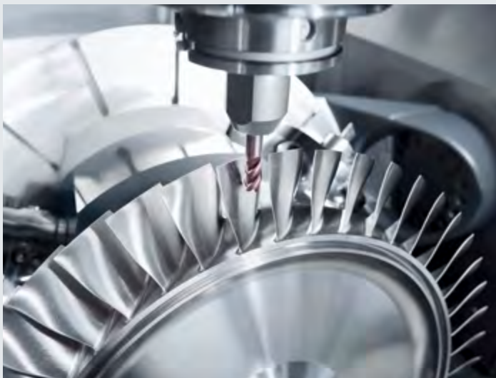
monoBLOCK® 系列的極高穩定性和動態性能是葉盤零件加工的理想選擇。
