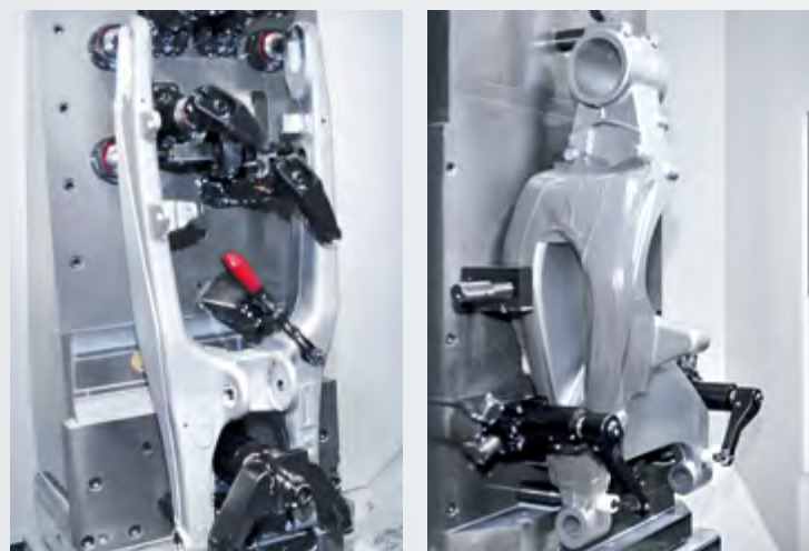
與滾珠螺桿臥式加工中心相比，DMC 60 H linear 讓 ZBG 加工此類工件的單件加工時間縮短了約 20% 至 25%。
