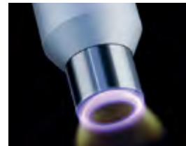
獨特複合加工技術: 用於表面活化 / 清洗的常壓等離子加工
