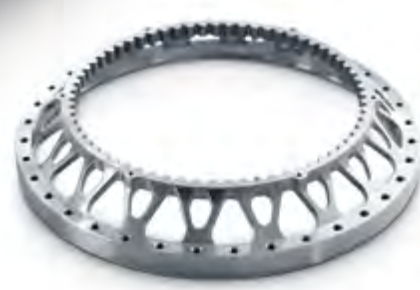
制動盤固定轂 CTX beta 800 車削 銑削 DMU 80 eVo linear 材質: 鈦 加工時間: 5 軸銑削約 7 小時
