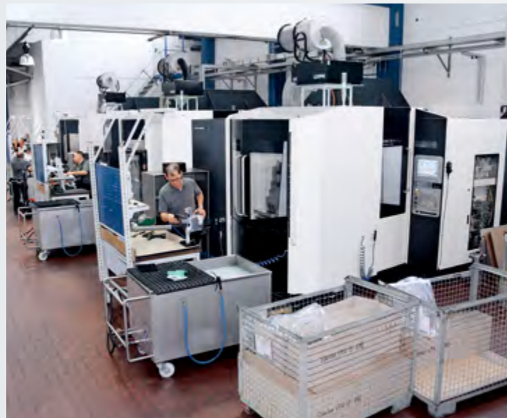
ZBG 的三款新款 DMC 60 H linear 機器正在快速且高效的為高難度的摩托車零件加工。
