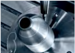
5. 外部輪廓 5 軸銑削
