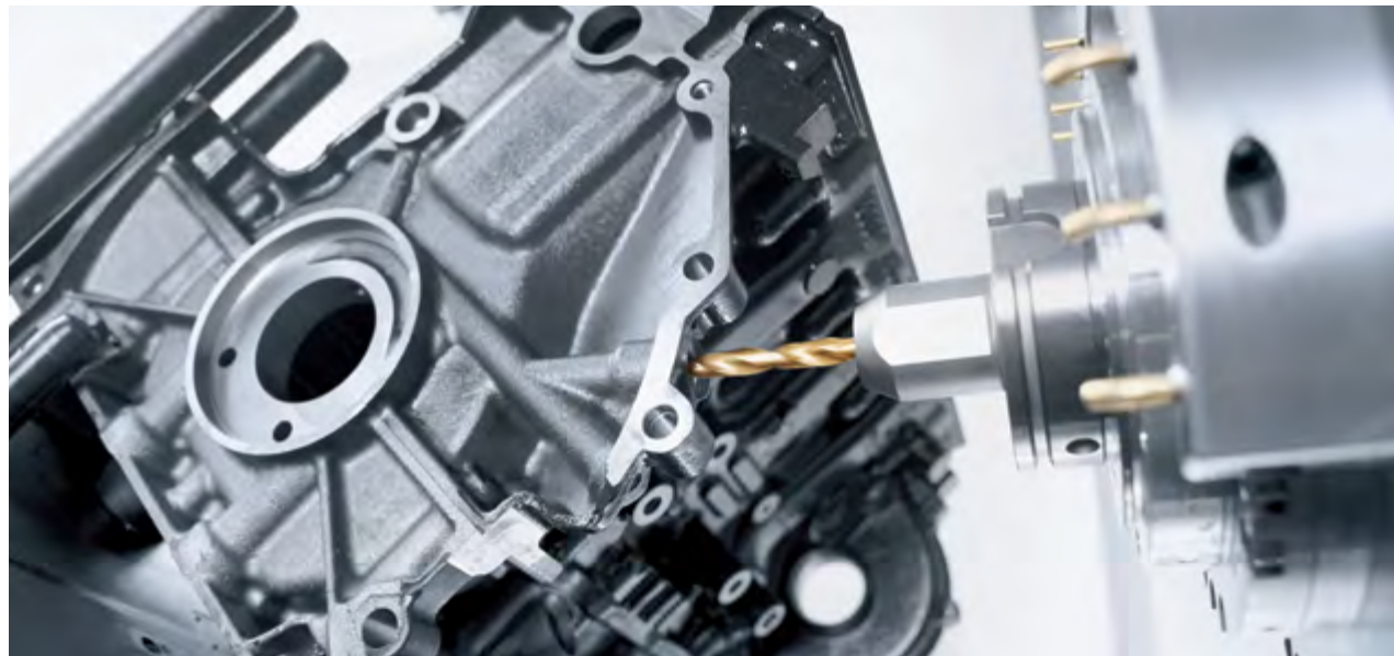
回轉擺動工作臺的擺轉範圍 225° – 一次裝夾完成高生產力的 5 軸全套加工。
