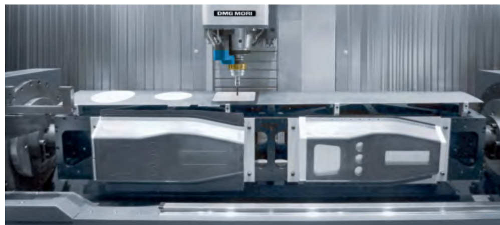
帶複合加工技術及特殊工件夾具的 ULTRASONIC 260: 轉子葉片根部；碳纖維合成材料中心儀錶盤的修邊、鑽孔和型腔。
