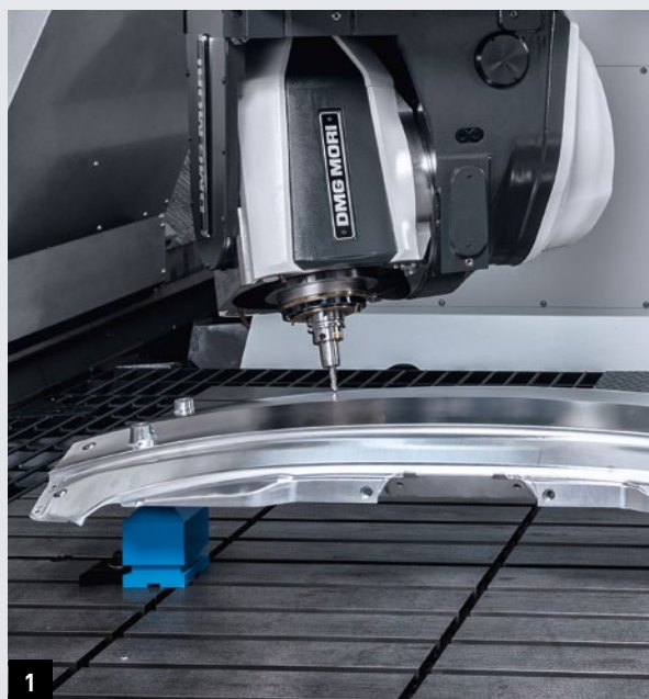
1. Głowica frezarska z zakresem obrotu 45° lub 90° do 5-osiowej obróbki z prędkością obrotową do 30 000 obr/min
