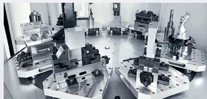
PH 150 – 8-pozycyjny magazyn palet (opcjonalnie 4 lub 10); max. obciążenie: 250 kg z paletą (opcjonalnie 350 kg)
