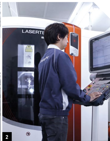
1. Od lewej do prawej: Yuki Kataoka, Inżynier, Kazuo Iwahori, Dyrektor Zarządzający i Terukazu Mizuguchi, Inżynier przed centrum obróbkowym HSC 20 linear . ULTRASONIC 20 linear można zobaczyć w tle. 2. 5-osiowa obróbka laserowa na LASERTEC 20 FineCutting odbywa się ze względu na wymagania dotyczące precyzji w pomieszczeniu o kontrolowanej temperaturze.
