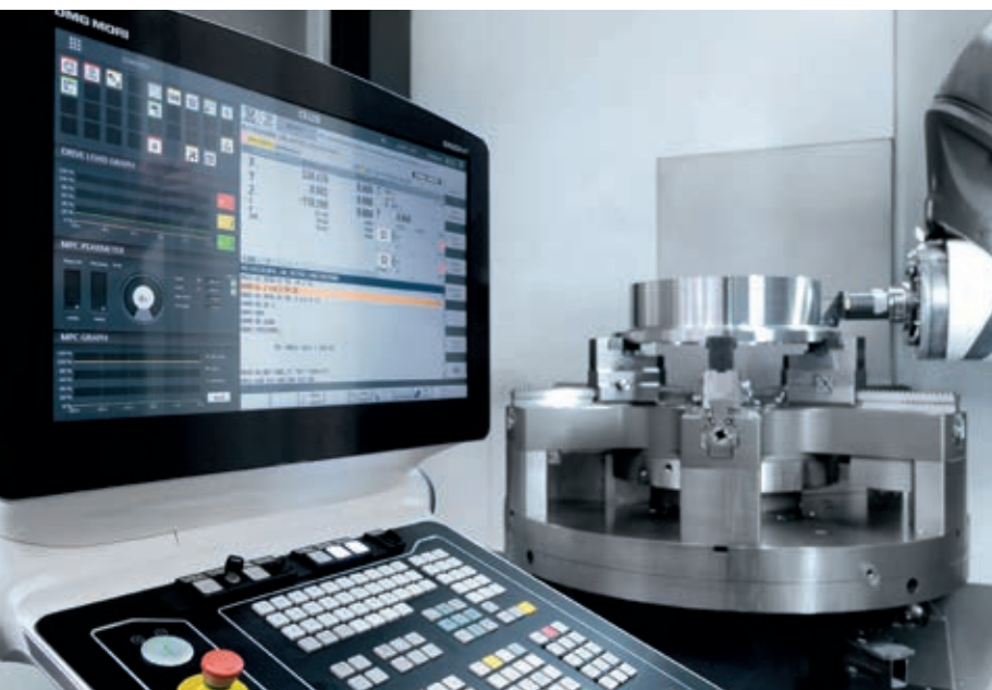
CELOS配西门子数控系统被选为统一的数控系统, 允许灵活地分配铣/车复合加工中心的操作员。
