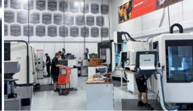
为生产赛车零件,Andretti Autosport选用DMG MORI的车削和铣削技术,(左起)NLX 2500 SY | 700, CMX 1100 V和DMU 50。
