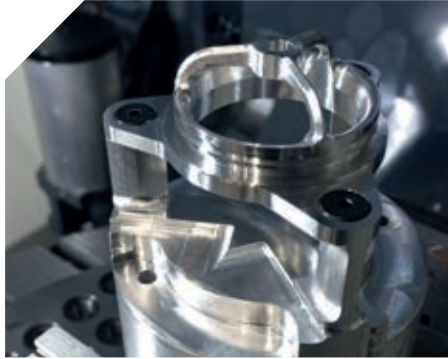
样件:Andretti Autosport赛车的高精度阀座,由DMG MORI的DMU 50 5轴万能铣削加工中心加工。
