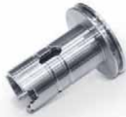
Ø 80 x 100 mm Bucha guia / Indústria automobilística Material: S45C Tempo de usinagem: 13 min 29 s
