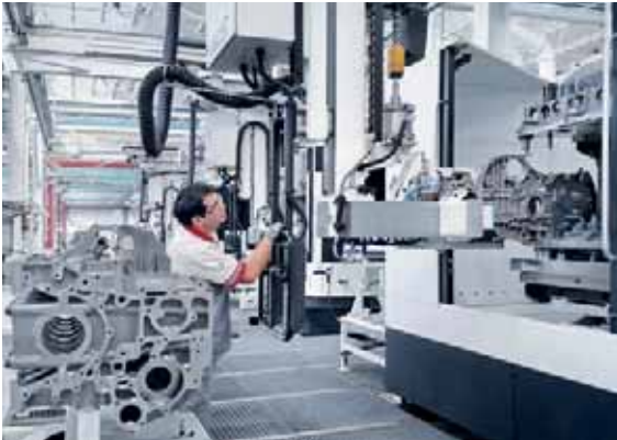
A alimentação dos componentes é feita na estação de setup. O primeiro plano mostra uma estação de giro e inversão.
