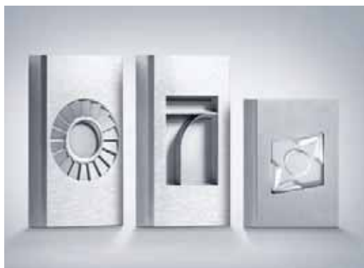
Usinagem de contornos 3D com cavidades em metal duro com laser de picosegundos.
