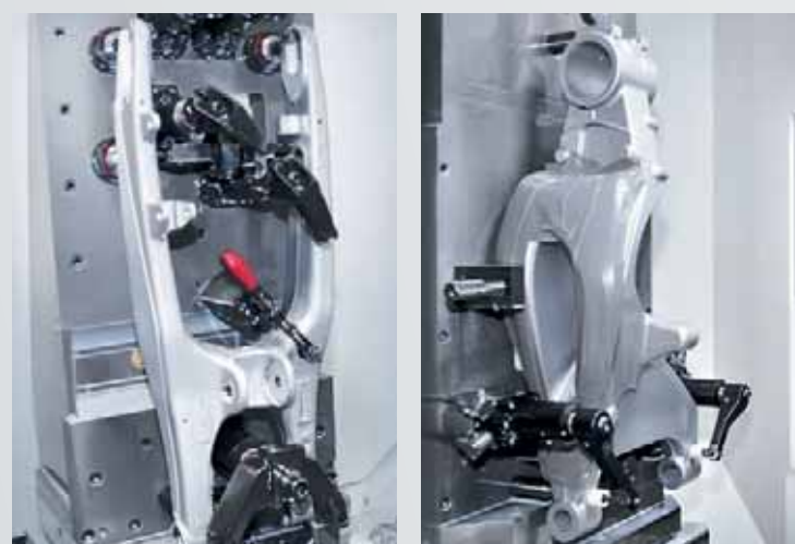
Em comparação a centros horizontais com fuso de esferas, a ZBG economiza de 20 a 25 % do tempo na produção de cada uma dessas peças graças às DMC 60 H linear .
