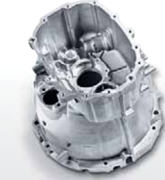
Exemplo carcaça de transmissão do conjunto de acionamento, fabricado em uma DMC 60 H linear
