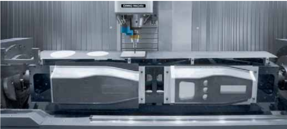
ULTRASONIC 260 com quadro de tecnologia integrado e dispositivo de fixação específico para o componente: Hastes em segmentos de lâminas de rotor; rebordeamentos, furações e bolsões em console central de CFK.
