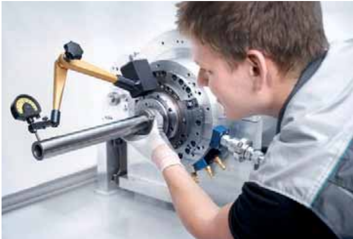
18 horas de check-up da geometria de máquina e fusos.
