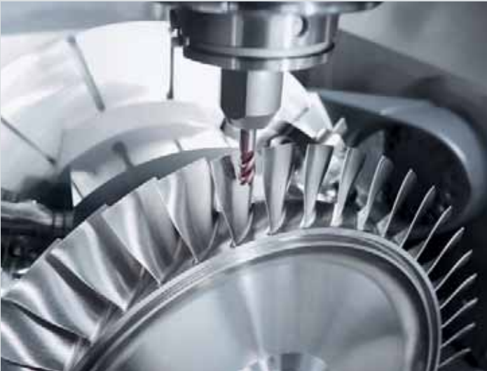
Excelente estabilidade e alta dinâmica da Série monoBLOCK® são condições ideais para a usinagem de componentes para BLISK.
