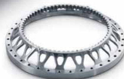
Câmara de disco de freio Torneamento na CTX beta 800 Fresamento na DMU 80 eVo linear Material: Titan Tempo de ciclo: Fresamento de 5 eixos em aprox. 7 horas
