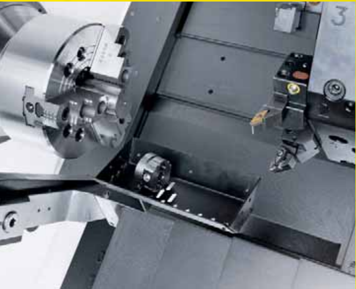
Dispositivo de pick-up de peças (parte do pacote de barras).
