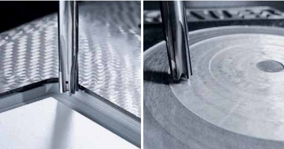
Usinagem de bordas und hastes em compostos de fibra de carbono CFK sem quebra de cantos, lascamento ou delaminação.
