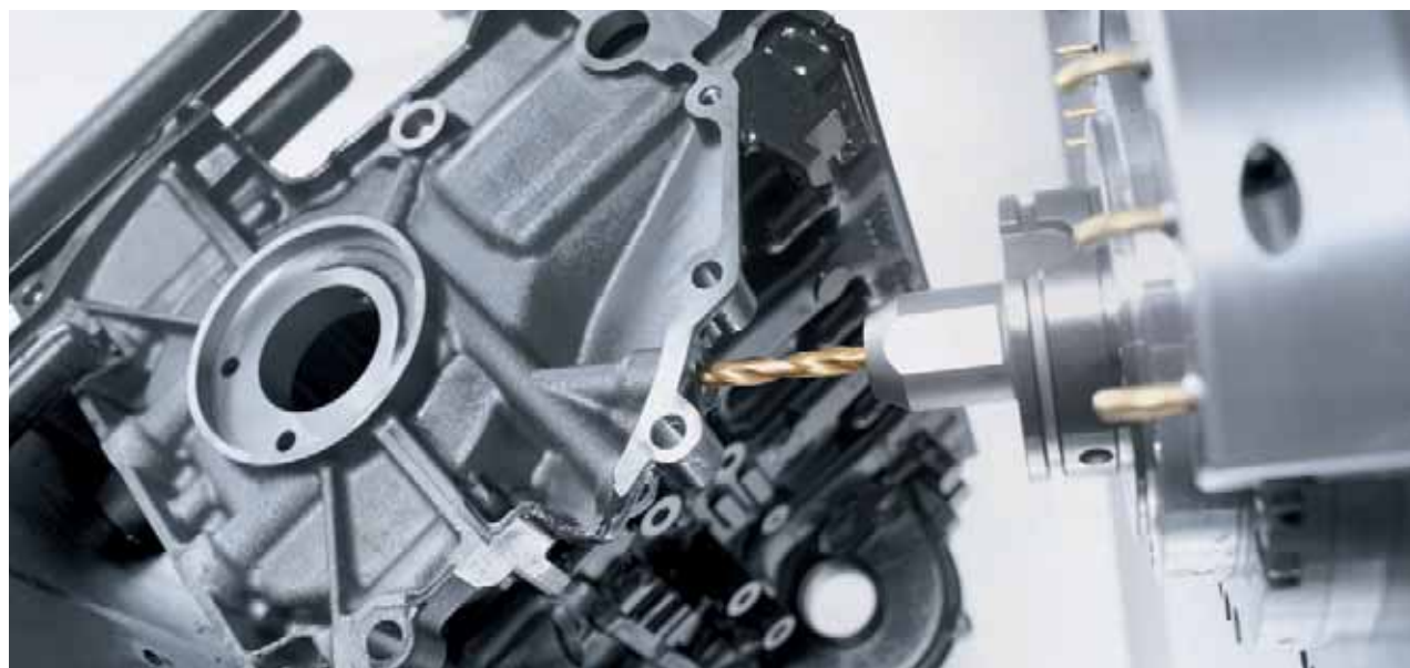
Mesa giratória basculante com ângulo de basculamento de 225° – usinagem completa em 5 eixos de alta produtividade com uma única fixação.
