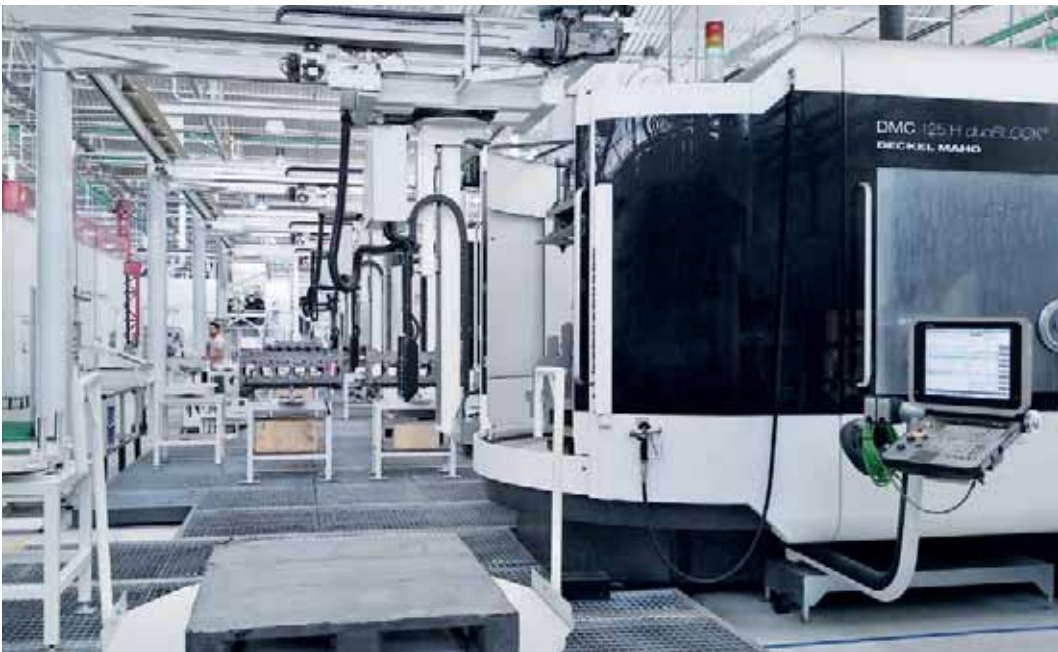
Na FPT Industrial Argentina S.A. a DMG MORI Systems desenvolveu o projeto turn key de uma linha de produção com um total de 13 centros de usinagem DMC.
