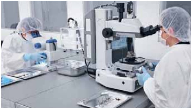
Agora disponível em Wernau: Ajuste do sensor MR no microscópio com precisão de 2 µm.
