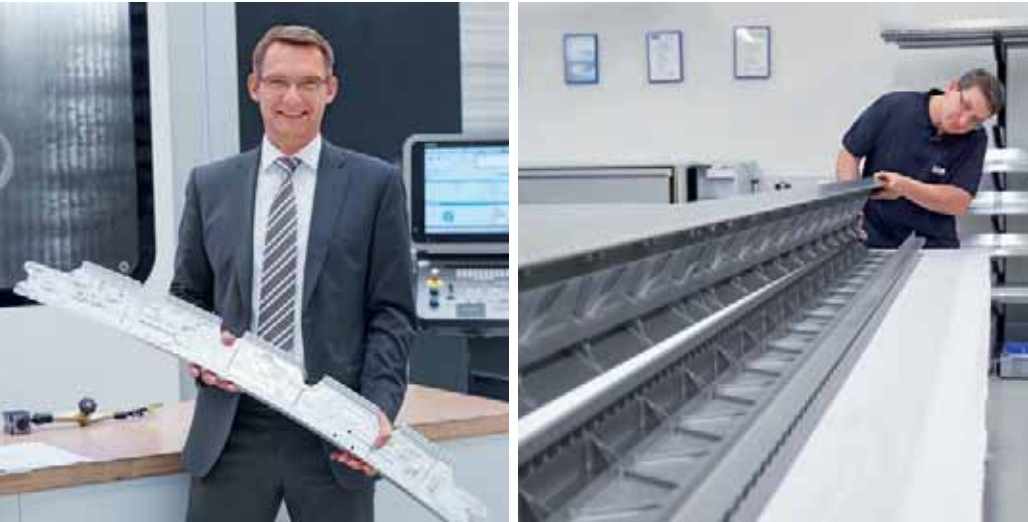
Jens Loll, diretor executivo da Loll Feinmechanik, com uma peça estrutural para a indústria aeroespacial, fabricada em uma máquina de coluna móvel DMF da DMG MORI. Dinâmica e precisão de posicionamento da tecnologia linear auxiliam a Loll Feinmechanik na usinagem de peças grandes.
