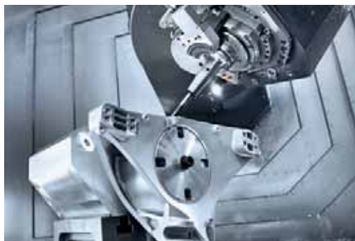
Com a usinagem em 5 eixos de alta precisão e produtividade a toolcraft produz componentes de precisão sofisticados como este suporte de roda.
