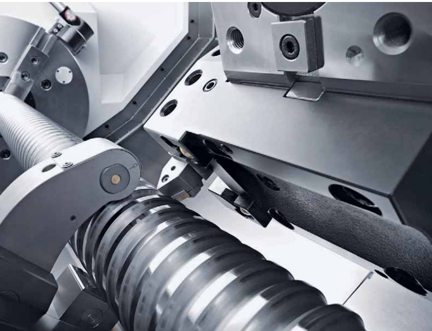
A NZX 4000I3000 permite a usinagem pesada de peças grandes até \varnothing 660 mm e 3.000 mm com alta eficiência.
